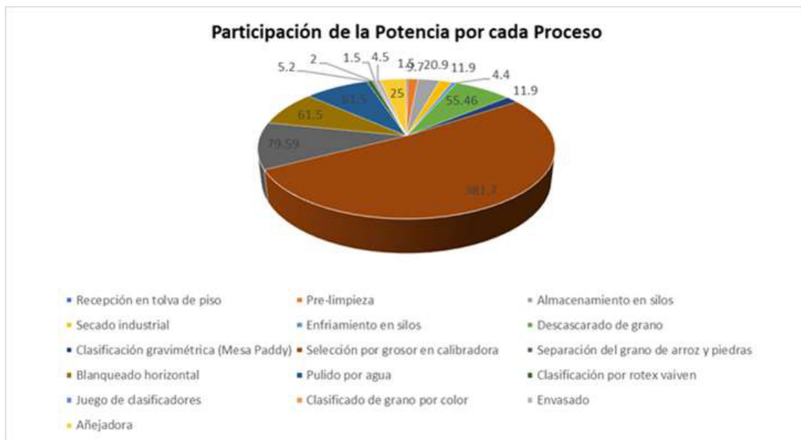
Figura 2: Los procesos y su Potencia consumida (kW)
