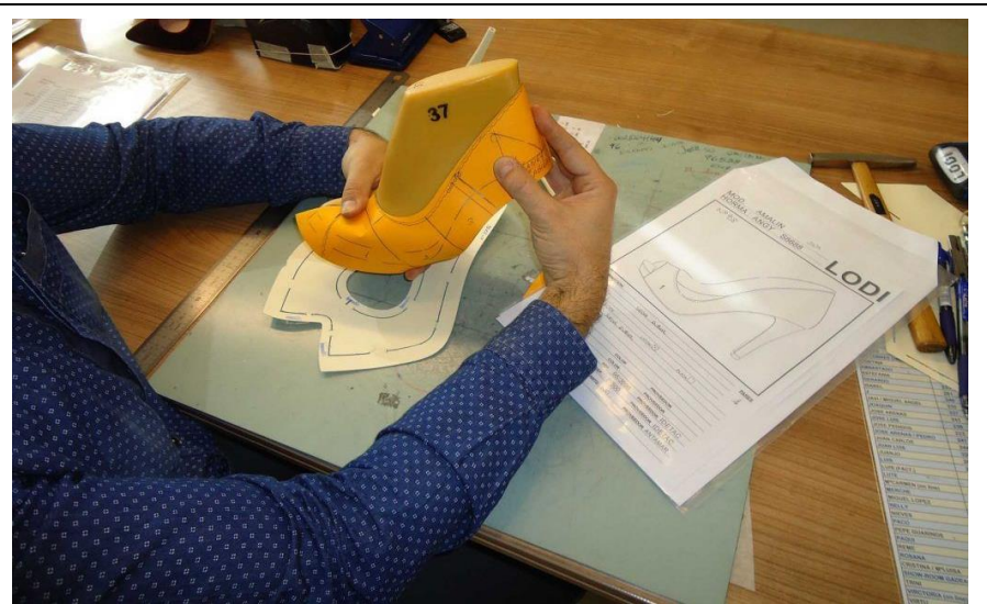
Figura 17: Proceso de Modelado en horma Fuente: Calzados Maribel
