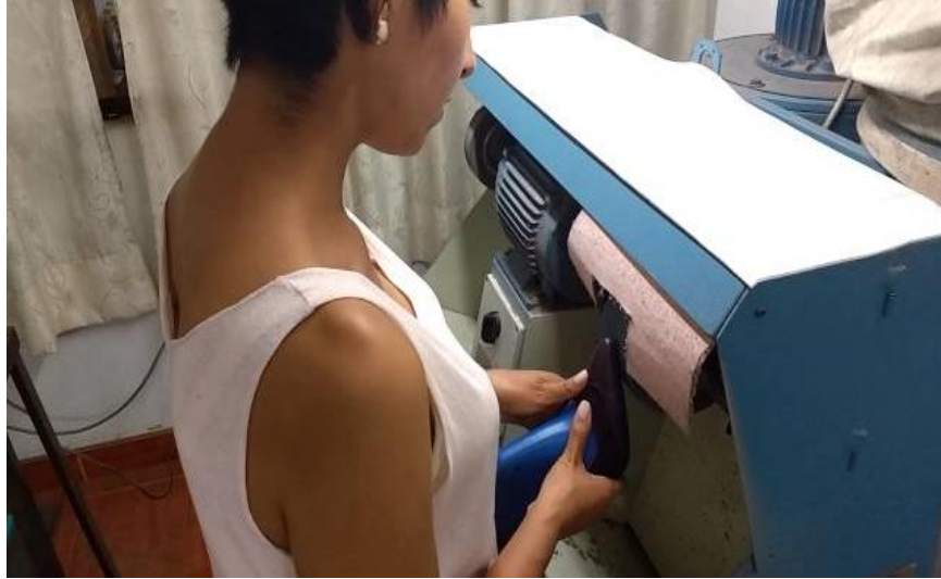
Figura 20: Proceso de desbastado Fuente: Calzados Maribel
