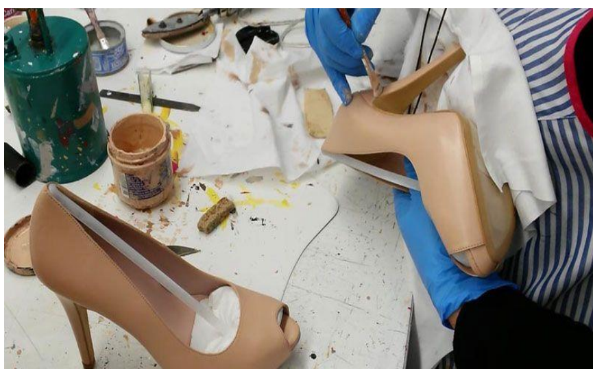
Figura 22: Proceso de colocar la plantilla Fuente: Calzados Maribel
