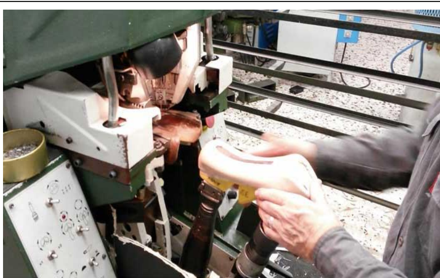
Figura 21: Proceso de armado Fuente: Calzados Maribel
