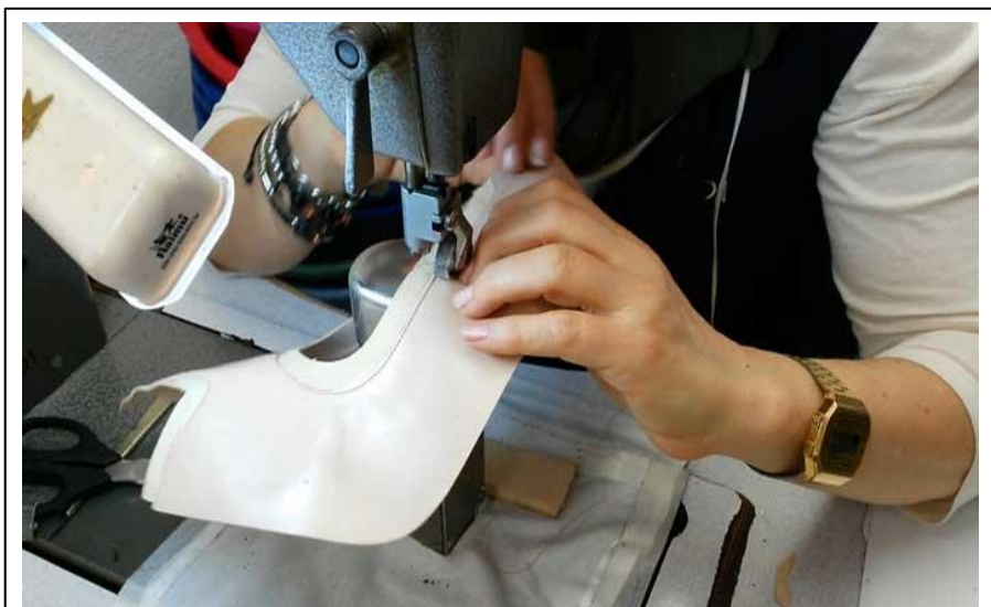
Figura 19: Proceso de perfilado Fuente: Calzados Maribel
