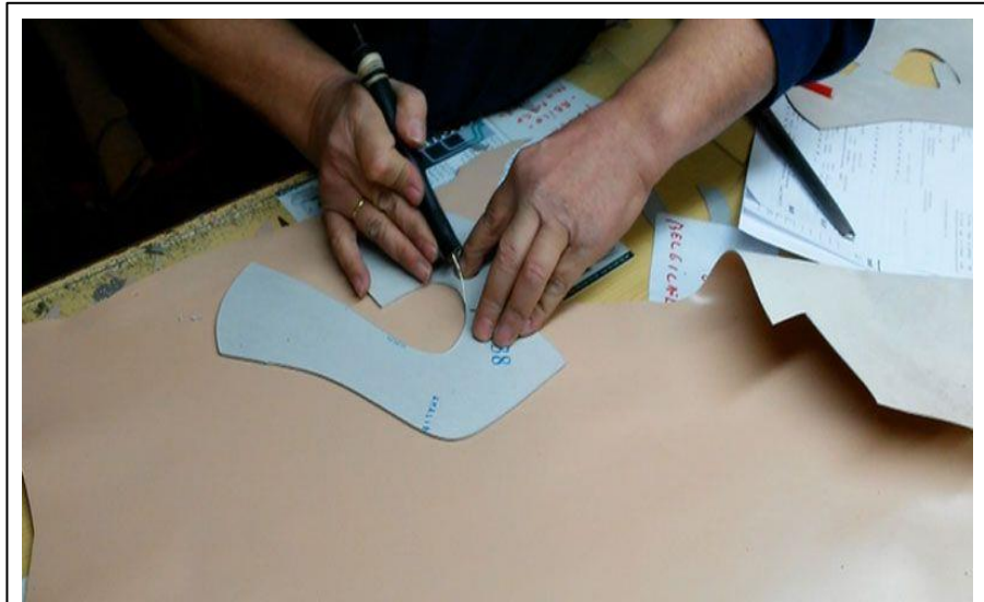
Figura 18: Proceso de cortado Fuente: Calzados Maribel
