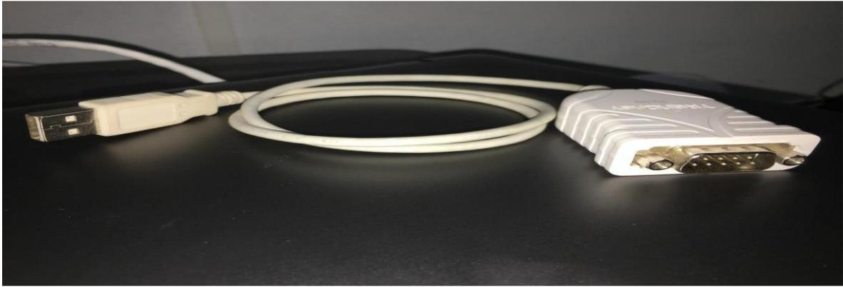
*Imagen 9. Fotografía USB to Serial Converter TU-S9. Fuente: Elaboración propia (2023).*
