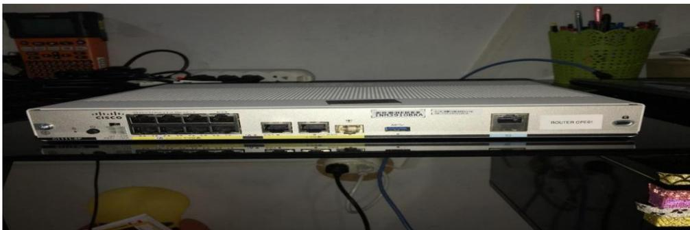
*Imagen 2. Fotografía de Router Cisco C1111-8P (Router CPE01), simulador de Sede01. Fuente: Elaboración propia (2023).*
