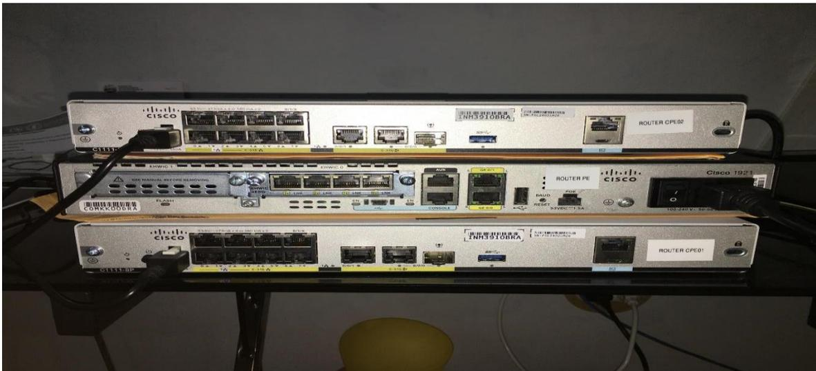
*Imagen 6. Fotografía de equipos Simulando Sedes de Conexión de Una Red Privada Virtual y un Proveedor. Fuente: Elaboración propia (2023).*
