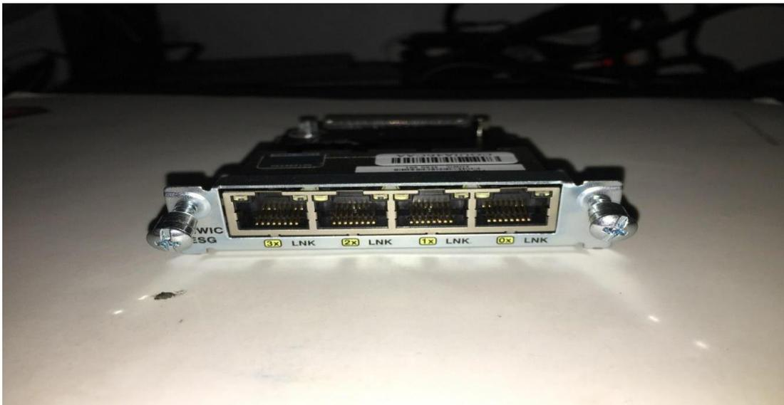
*Imagen 4. Fotografía de tarjeta Hwic, para conexión de servicios de diferentes redes WAN para Router Cisco1921. Fuente: Elaboración propia (2023).*
