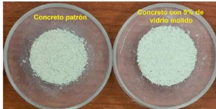
**Figura 1.** Muestras preparadas para el análisis de difracción de rayos x sobre el respectivo portamuestras.
