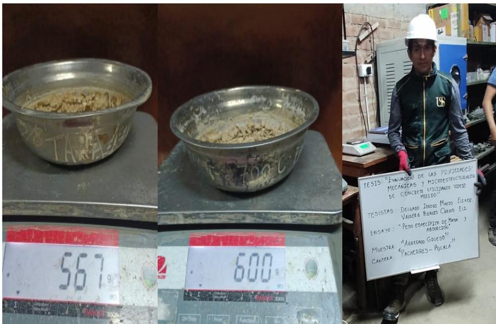
Fig. 19. Ensayo de contenido de humedad – Agregado Fino.
