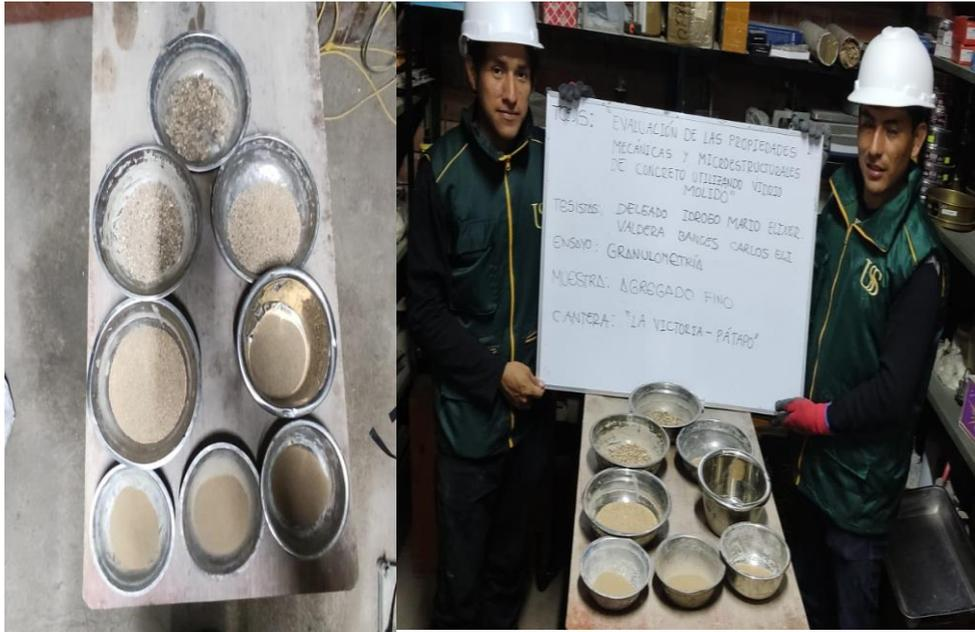
Fig. 18. Ensayo de granulometría – Agregado Fino.
