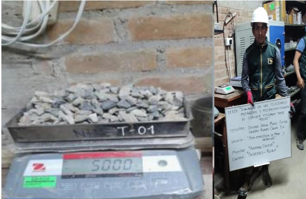
Fig. 23. Ensayo de contenido de humedad – Agregado grueso.
