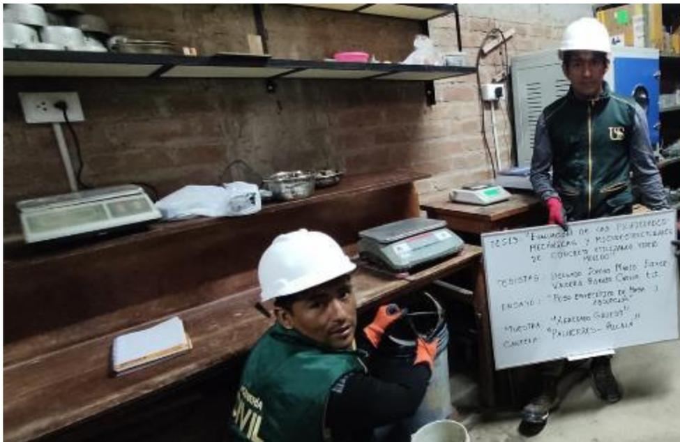
Fig. 24. Ensayo de peso específico y absorción – Agregado Grueso.
