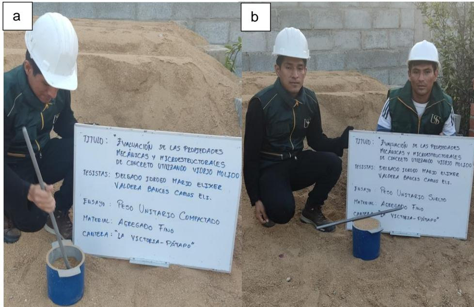
Fig. 21. Ensayo de peso unitario agregado fino a) compactado, y b) suelto.
