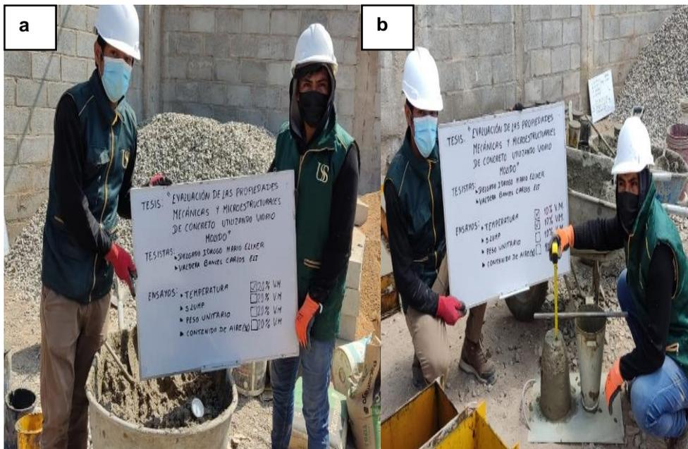
Fig. 28. Concreto fresco, a) Ensayo de temperatura y b) asentamiento.
