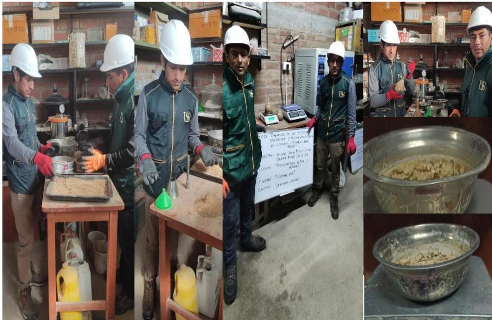
Fig. 20. Ensayo de peso específico y absorción – Agregado Fino.
