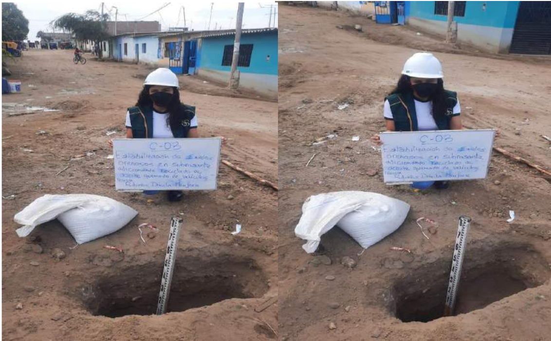
Fig. 23. Obtención de muestras de suelo de la calicata 03.
