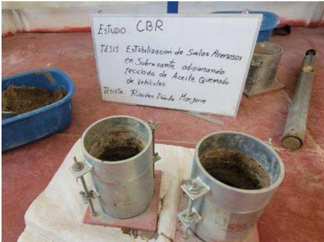
Fig. 29. Determinación del ensayo de CBR de las muestras naturales y muestras con adición de aceite quemado.
