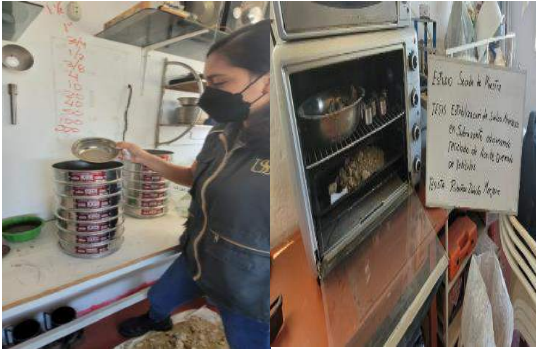
Fig. 25. Determinación del contenido de humedad y análisis granulométrico del suelo natural.
