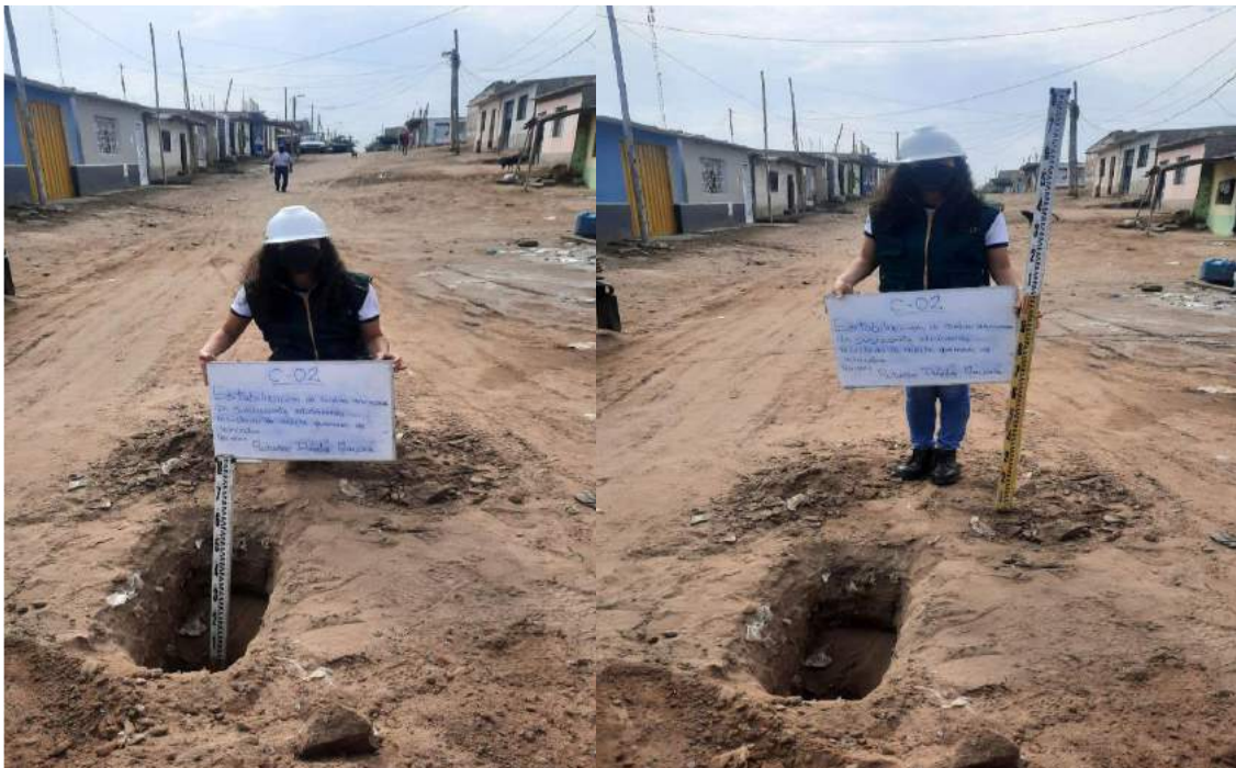
Fig. 21. Obtención de muestras de suelo de la calicata 01
