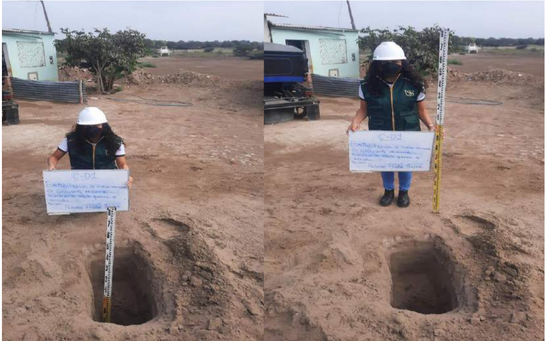
Fig. 21. Obtención de muestras de suelo de la calicata 01
