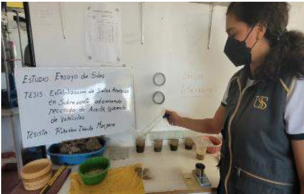
Fig. 26. Determinación del contenido de sales solubles del suelo natural.
