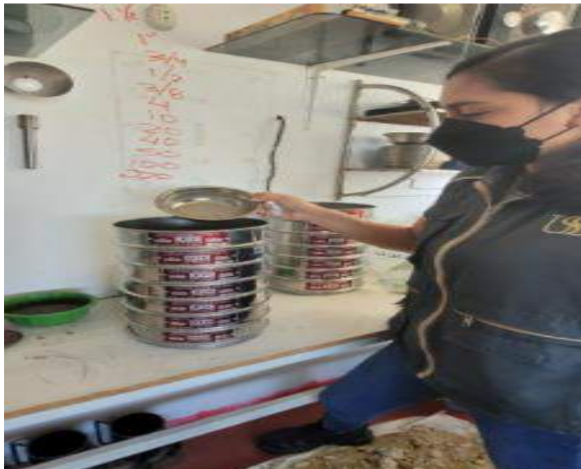
Fig. 9. Ensayo de análisis granulométrico de las muestras de suelo.
