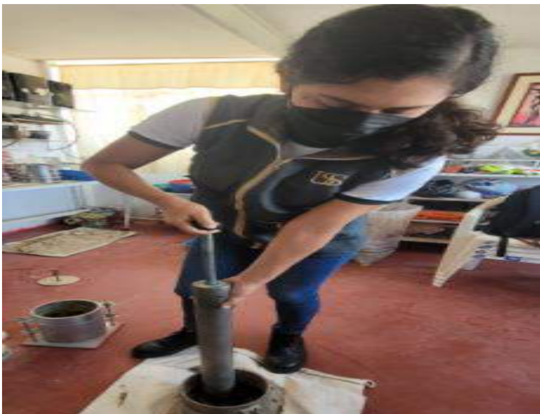
Fig. 28. Determinación del ensayo de compactación de las muestras naturales y muestras con adición de aceite quemado.
