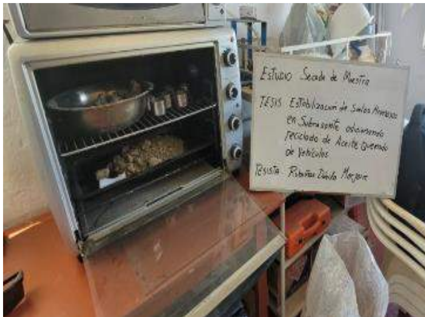
Fig. 10. Contenido de humedad.
