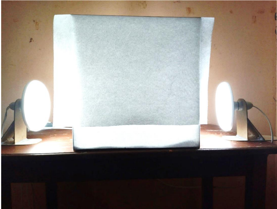
Fig. 26: Prototipo construido para la adquisición de las imágenes
