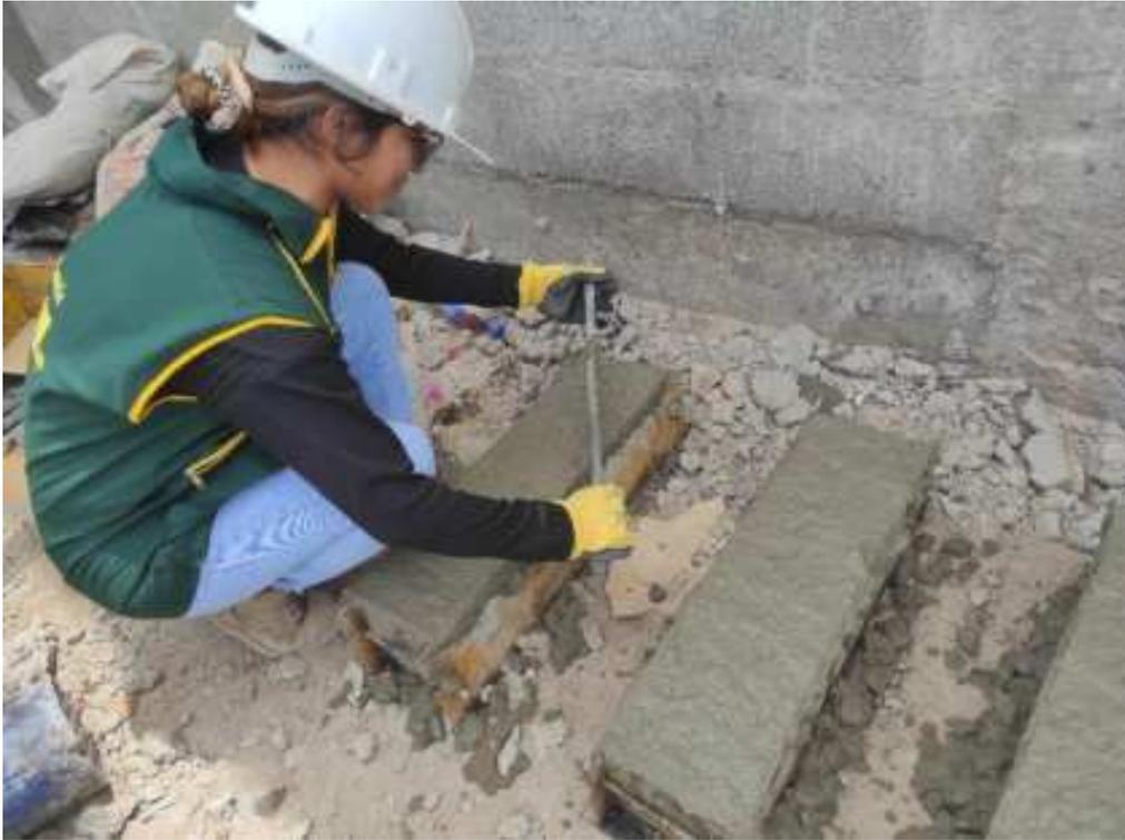
**Fotografía 12.** Llevando, varillado y resanado de las vigas de concreto (Flexión)
