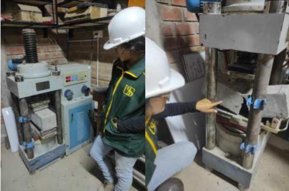
**Fotografía 21.** Ensayo de Flexión en la máquina de ensayos universal
