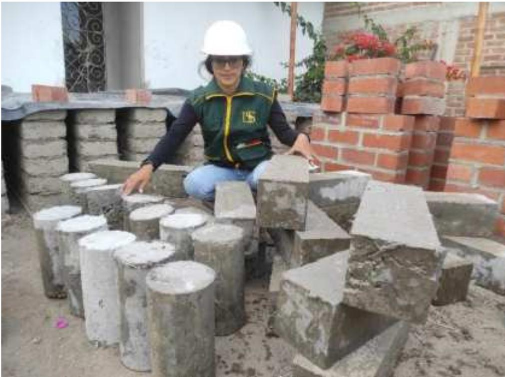
**Fotografía 13.** Acopio después del curado de probetas, para ensayos mecánicos
