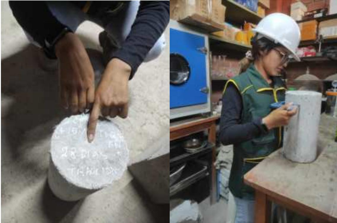
**Fotografía 17.** Medición de probetas para el ensayo de Tracción
