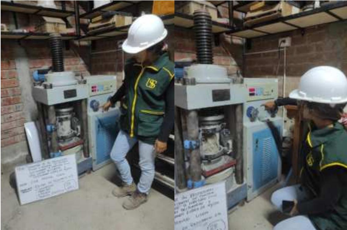
**Fotografía 16.** Ensayo de Compresión y Módulo elástico en la máquina de ensayos universal.
