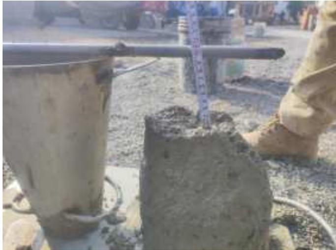
**Fotografía 14.** Ensayo de Asentamiento en concreto fresco
