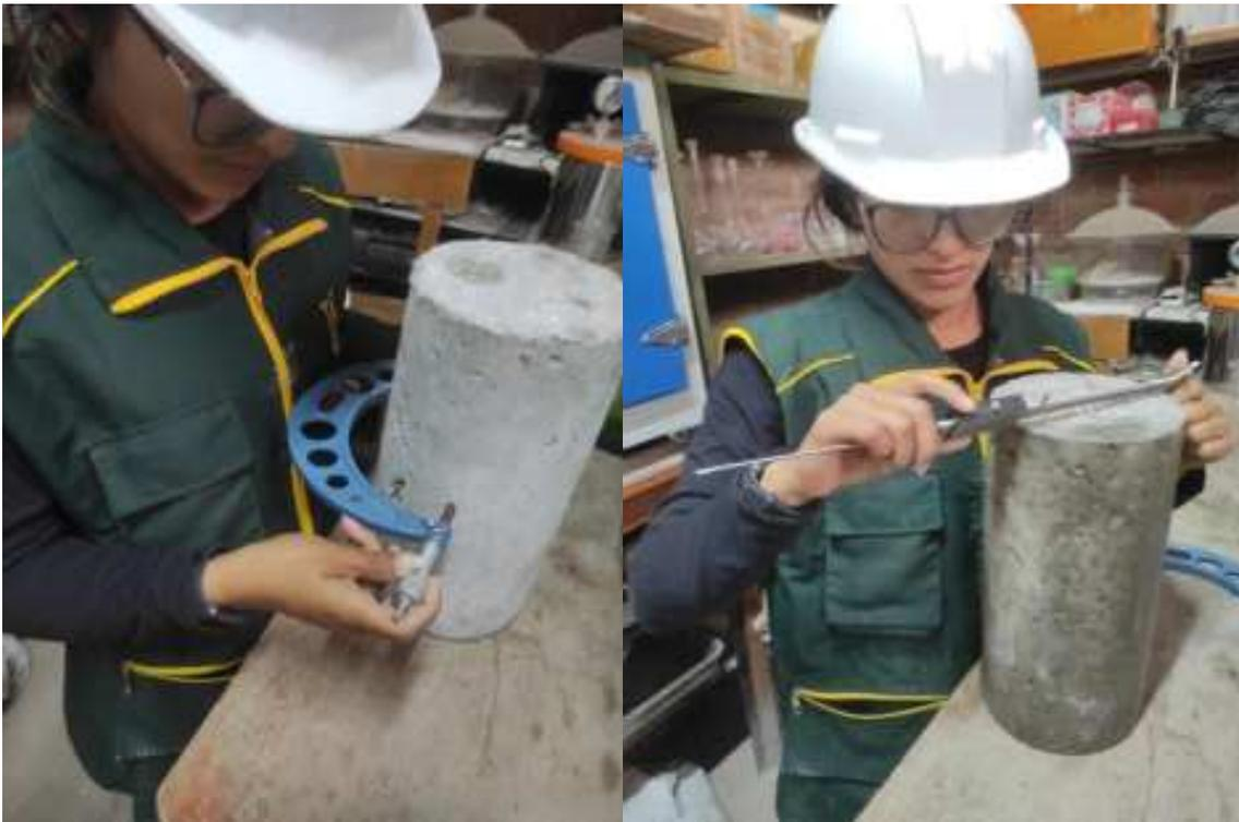
**Fotografía 15.** Medición de probetas para el ensayo de Compresión y Módulo elástico
