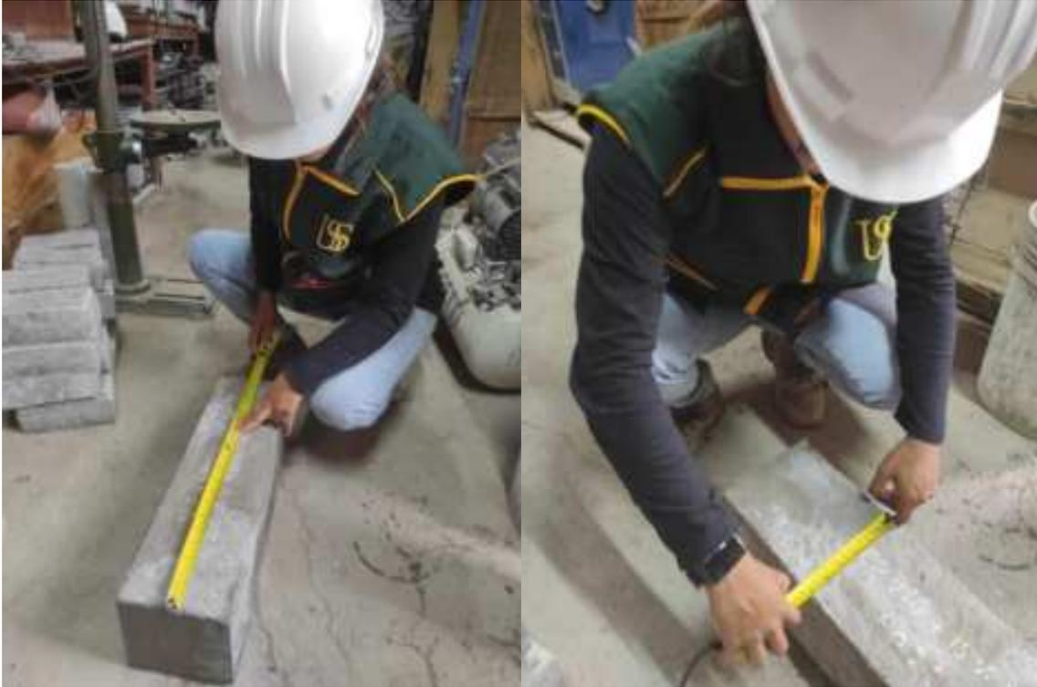
**Fotografía 19.** Medición de probetas para el ensayo de Flexión
