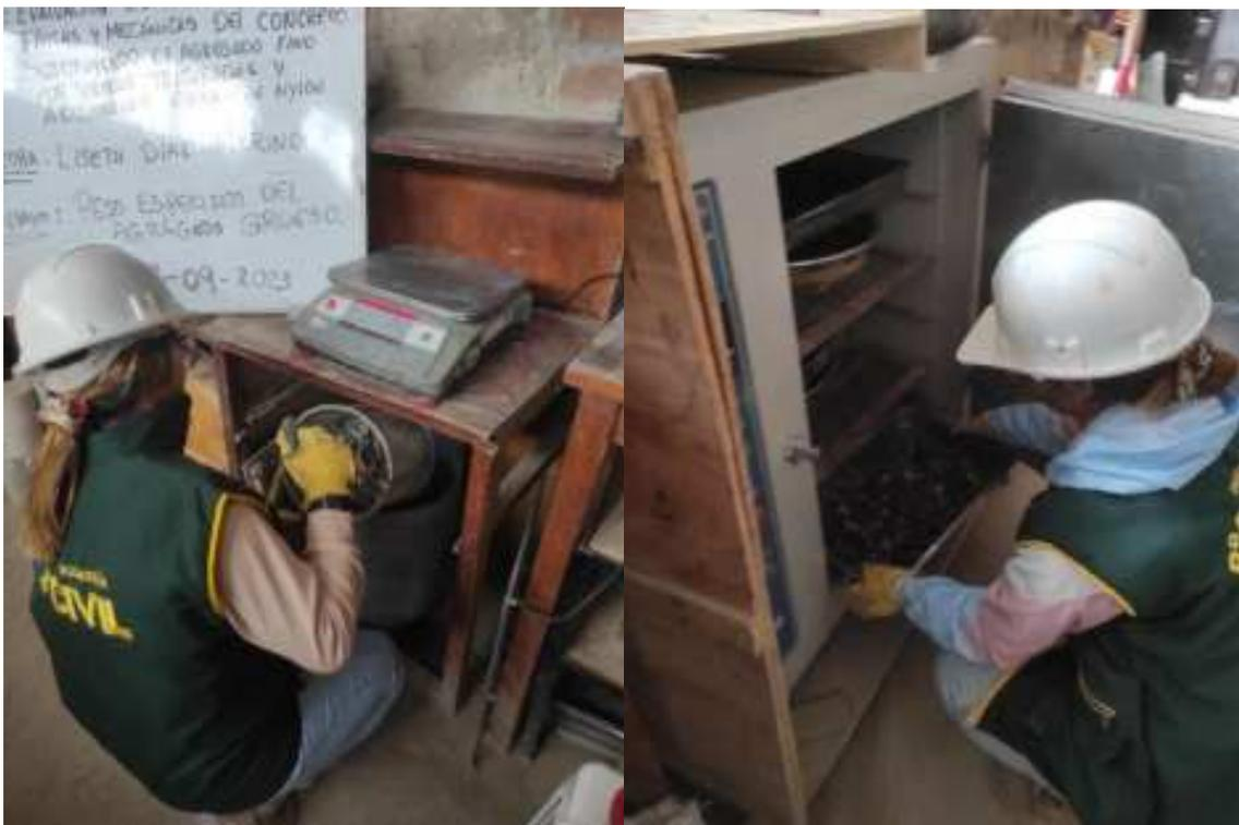
**Fotografía 9.** Peso específico y absorción del agregado grueso
