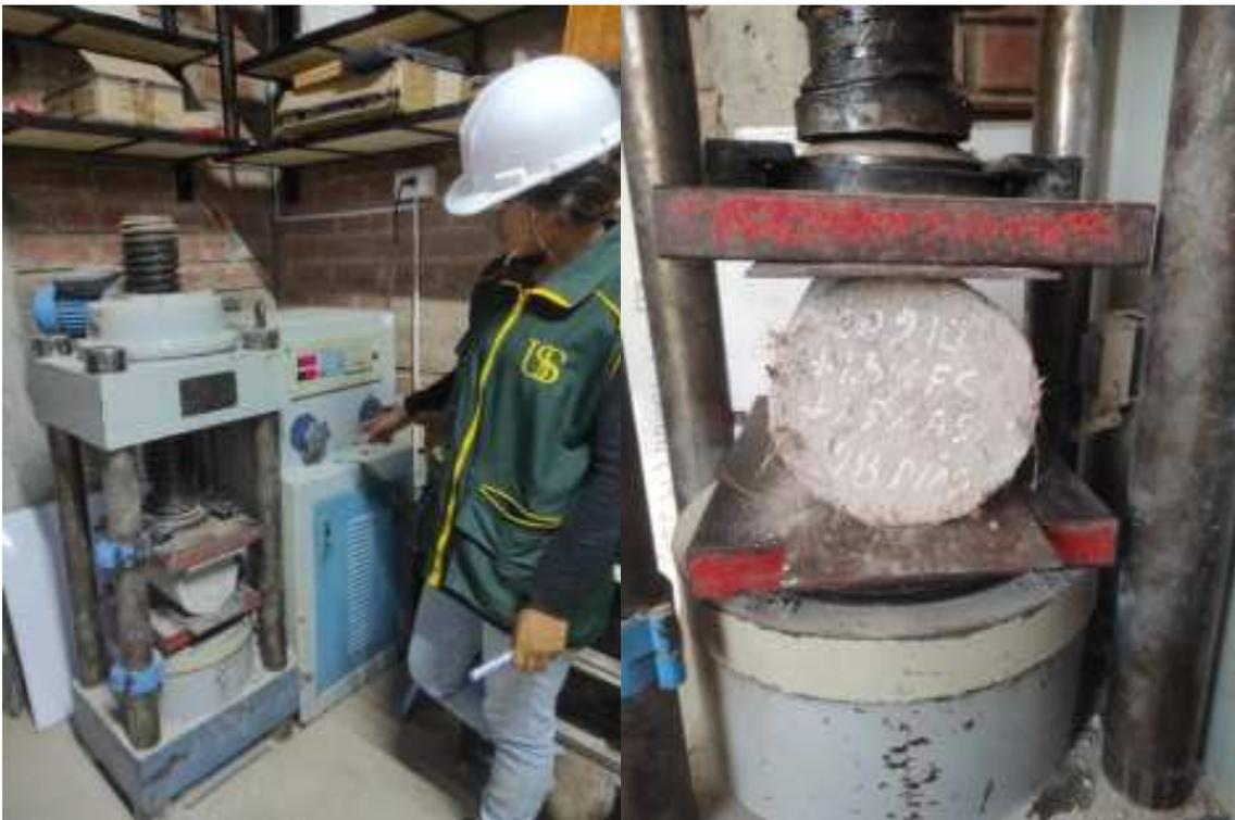
**Fotografía 18.** Ensayo de Tracción en la máquina de ensayos universal.
