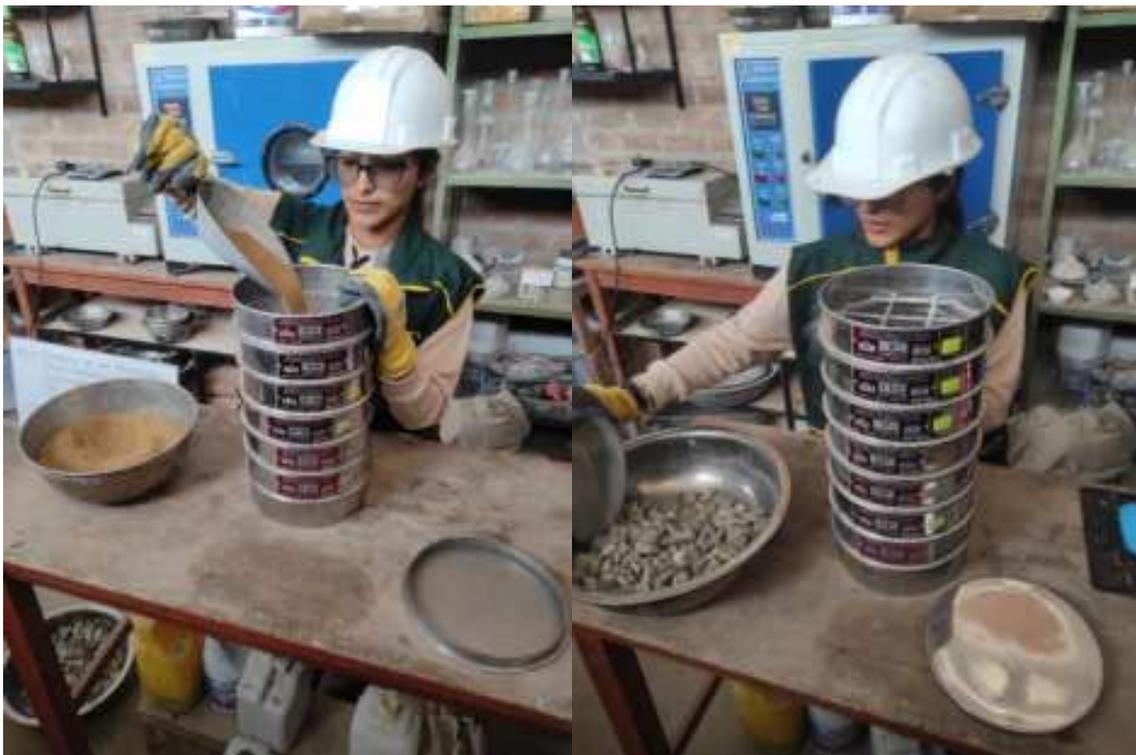
**Fotografía 7.** Granulometría de los agregados
