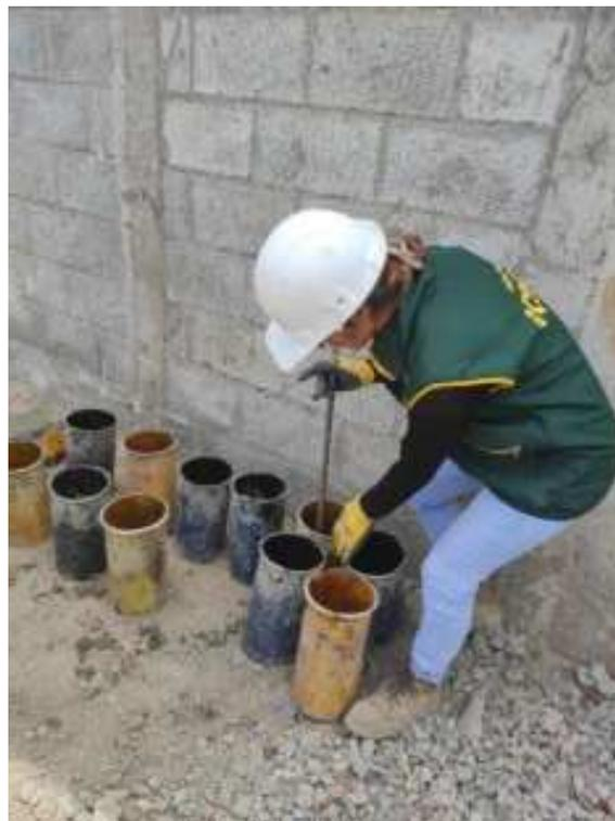
**Fotografía 11.** Llenado, varillado y resanado de probetas cilíndricas de concreto (Compre., trac. y M.E.)
