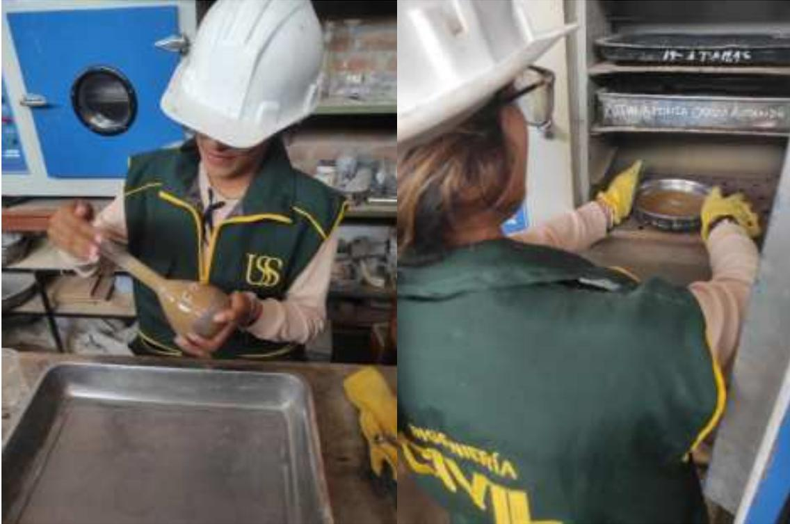
**Fotografía 8.** Peso específico y absorción del agregado fino
