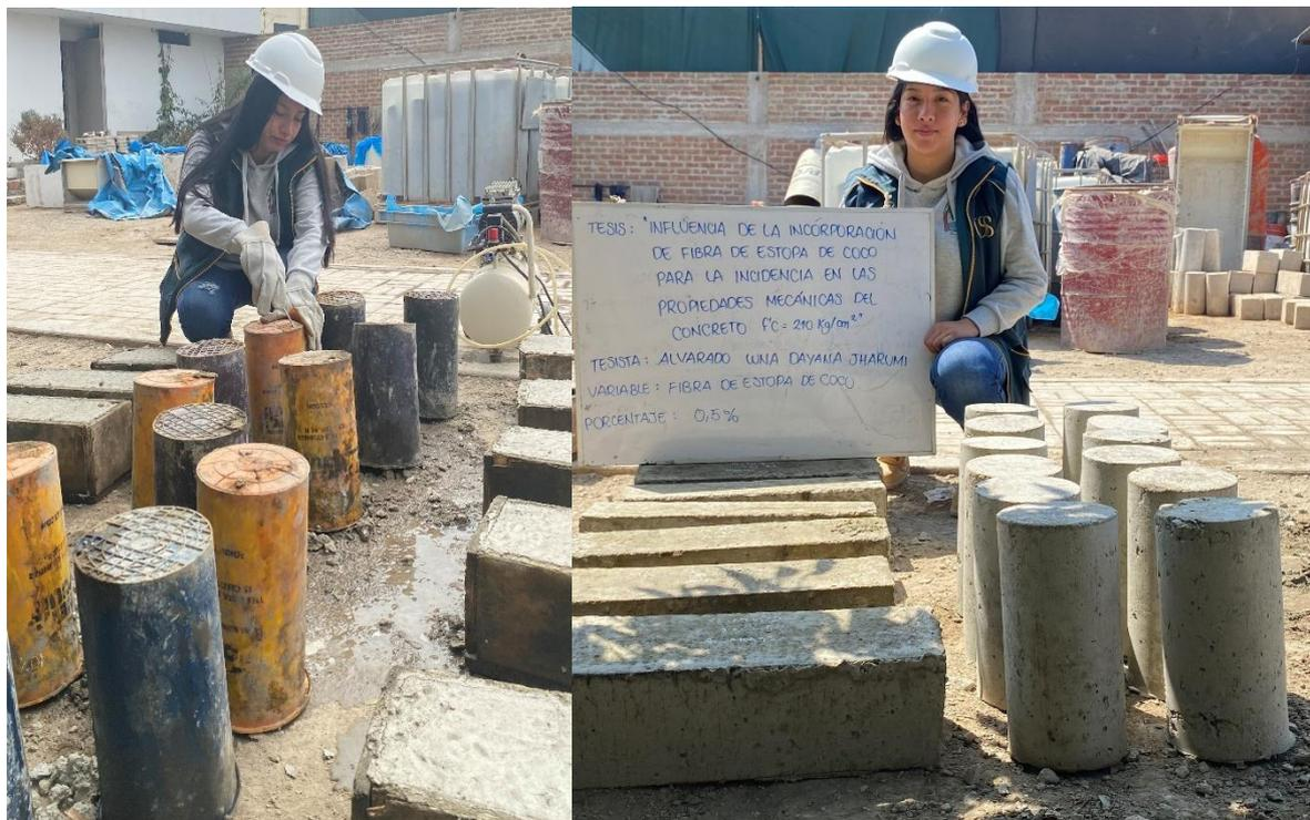
Fig. 26. Desmoldado de probetas y vigas
