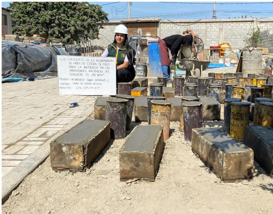
**Fig. 28.** Desencofrado de probetas y vigas.
