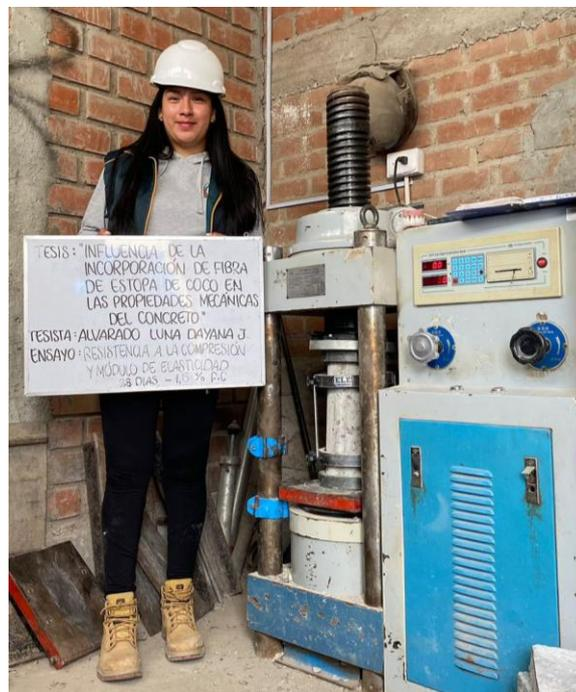
**Fig. 32.** Ensayo de resistencia a la compresión y módulo de elasticidad - 28 días.
