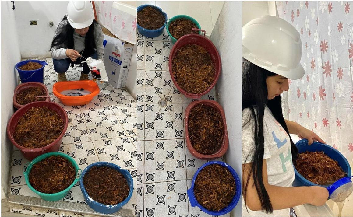
**Fig. 20.** Tratamiento de la fibra de estopa de coco con cal.
