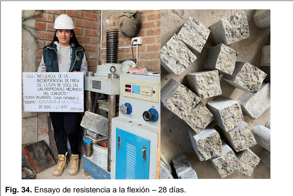
Fig. 34. Ensayo de resistencia a la flexión – 28 días.
