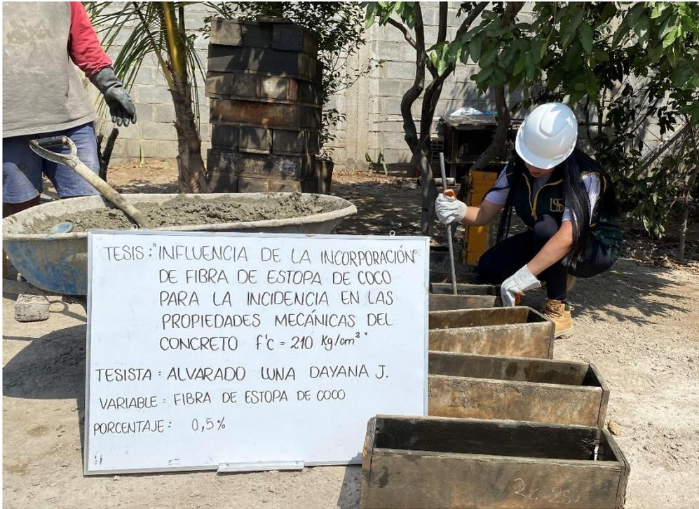
Fig. 25. Vaciado de probetas y vigas.
