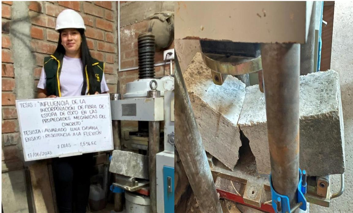
**Fig. 31.** Ensayo de resistencia a la flexión - 7 días.
