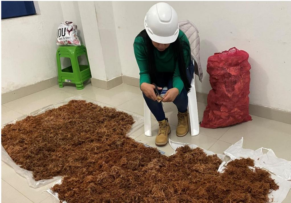
**Fig. 22.** Deshilachado y cortado manual de la fibra de estopa de coco.
