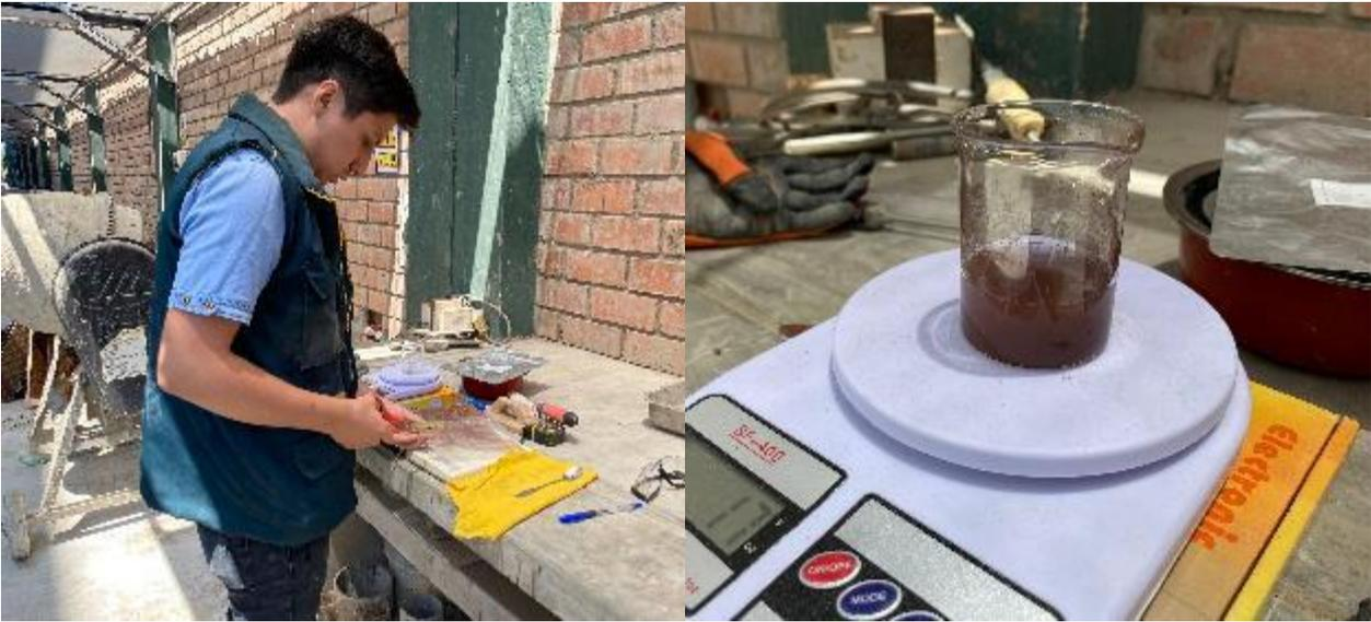
**Panel 02. Mezcla con el Aditivo de NPMCu**
