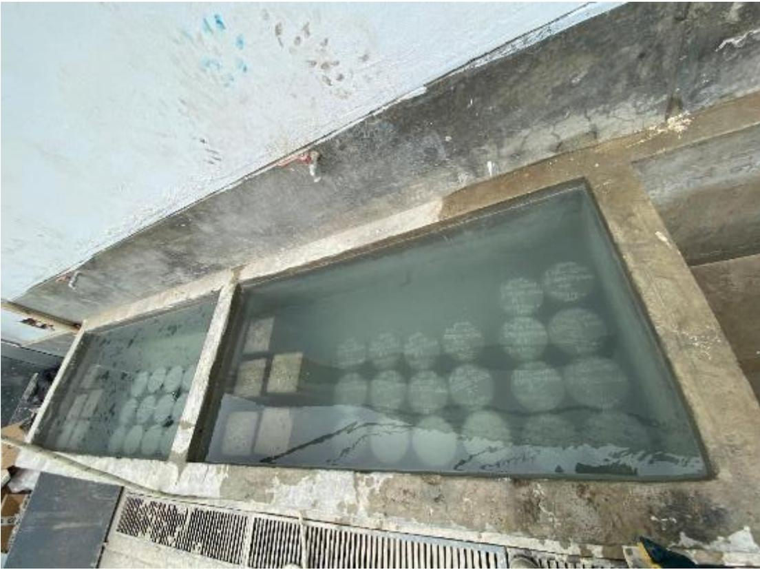
**Panel 07.** Panel General del Curado y Clasificación de Probetas
