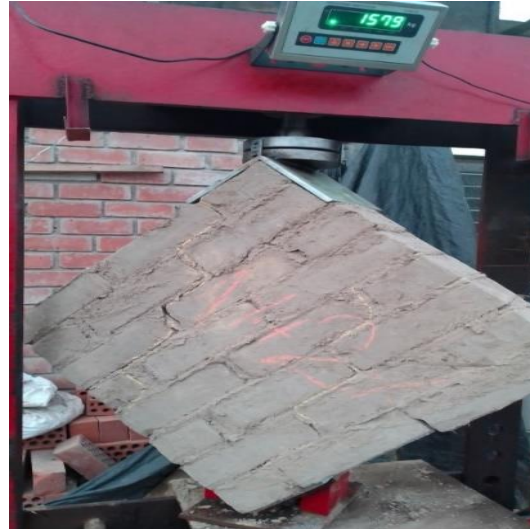
Fig.27. Resistencia a compresión diagonal en muretes
