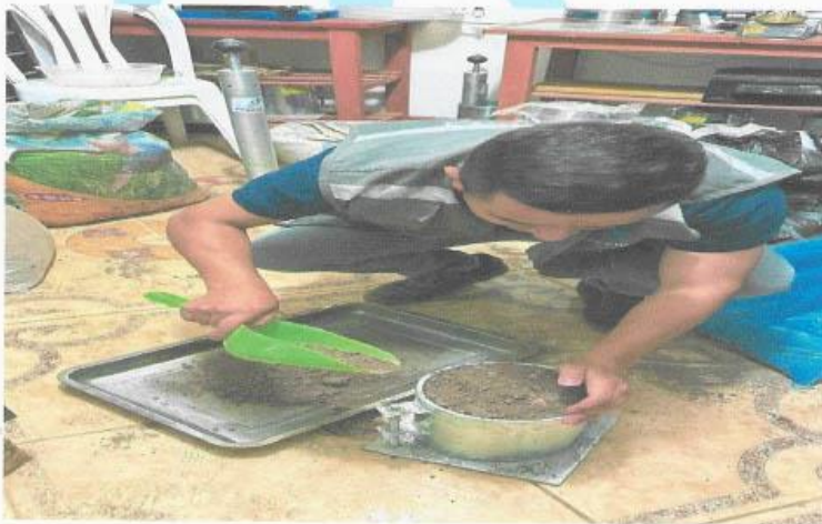
FOTO N°12: PROCTOR MODIFICADO, LLENADO DE LA MUESTRA POR CAPA, DESPUES DE LA COMPACTACIÓN, PARA LA TESIS "EFECTO DE LA ENZIMA TERRASIL EN EL MEJORAMIENTO DE UN SUELO CON FINES DE CARRETERA".
