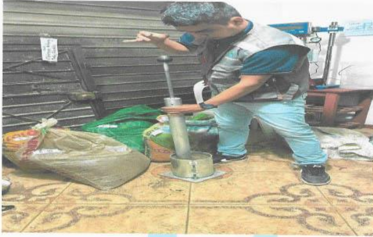
FOTO N°11: PROCTOR MODIFICADO, COMPACTACIÓN DE LA MUESTRA POR CAPA PARA LA TESIS "EFECTO DE LA ENZIMA TERRASIL EN EL MEJORAMIENTO DE UN SUELO CON FINES DE CARRETERA".
