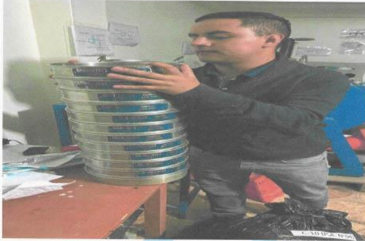
FOTO N°7: TAMIZADO PARA EL ENSAYO DE ANALISIS GRANULOMETRICO PARA LA TESIS "EFECTO DE LA ENZIMA TERRASIL EN EL MEJORAMIENTO DE UN SUELO CON FINES DE CARRETERA".
