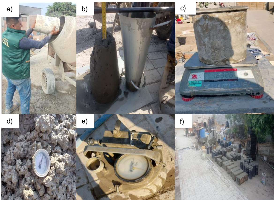
Fig.12. Ensayos al concreto fresco. (a) Mezcla para el concreto patrón y modificado. (b) Slump. (c) Peso Unitario. (d) Temperatura. (e) Contenido de Aire. (f) Moldes cilíndricos y prismáticos.
