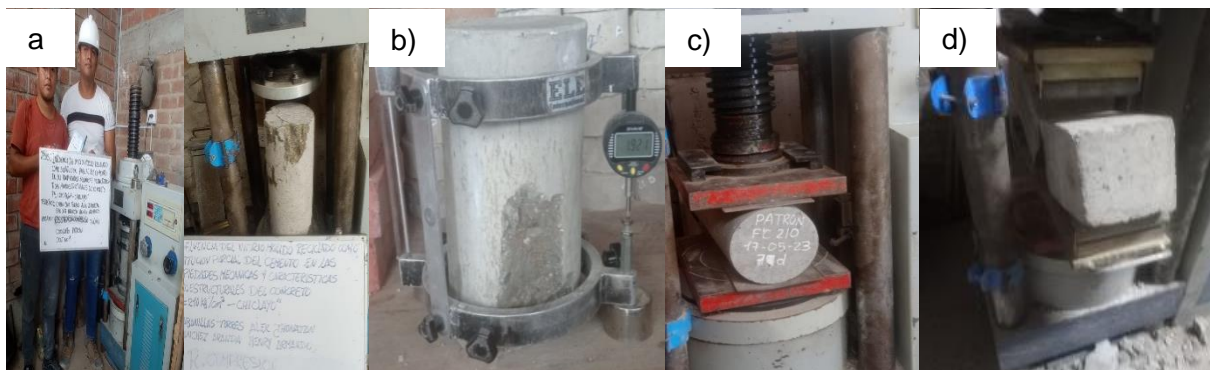
Fig.13. Propiedades Mecánicas. (a) R.C. (b) M.E. (c) R.T. (d) R.F.
