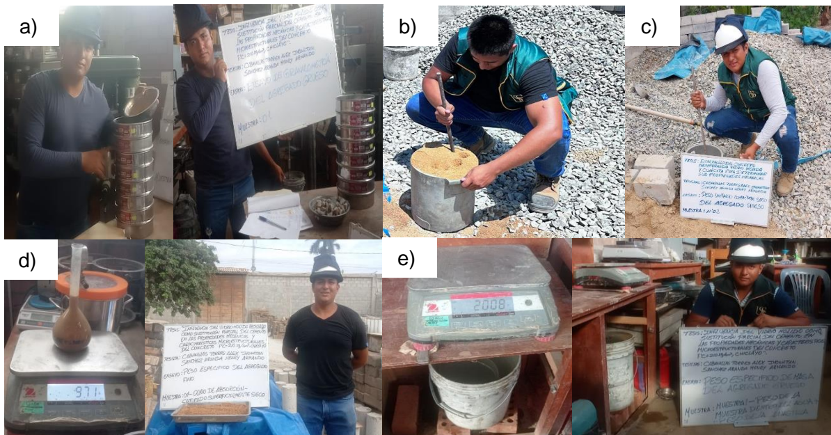
Fig.11. (a),(b),(c),(d) y (e) Propiedades Físicas de los Áridos fino y grueso que permitirán el desarrollo del D. Mezcla para el C. Patrón y Modificado con VMR.
