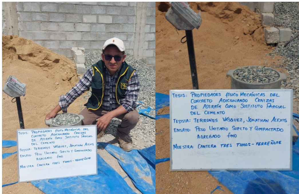
Fig. 43. Ensayo de peso unitario suelto y compactado del árido grueso.
