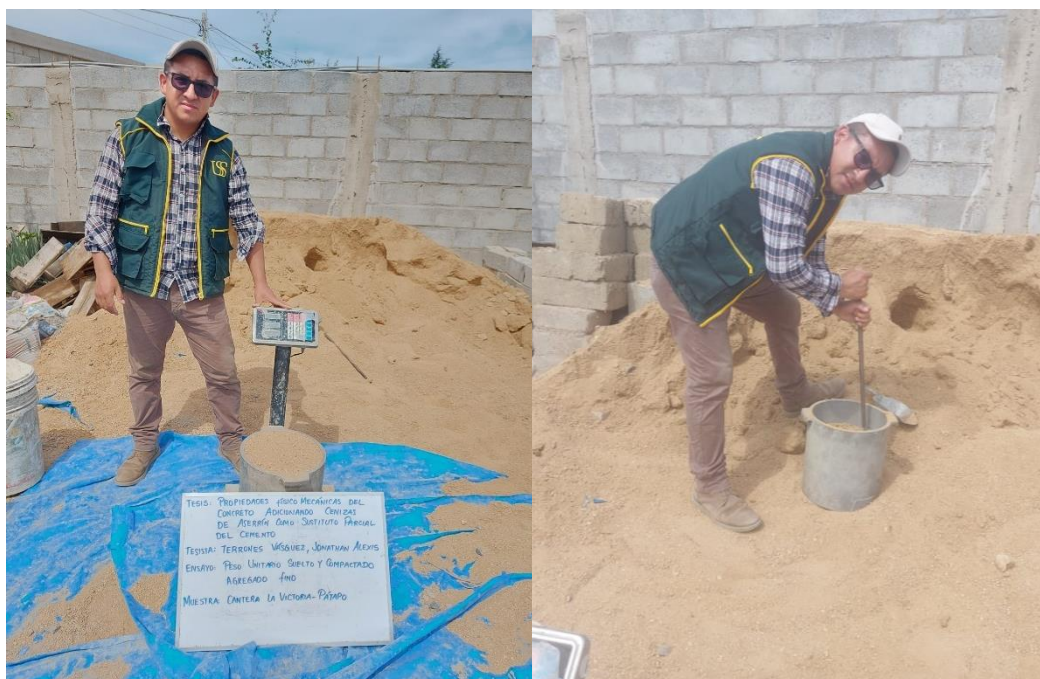
Fig. 44. Ensayo de peso unitario suelto y compactado del árido fino.
