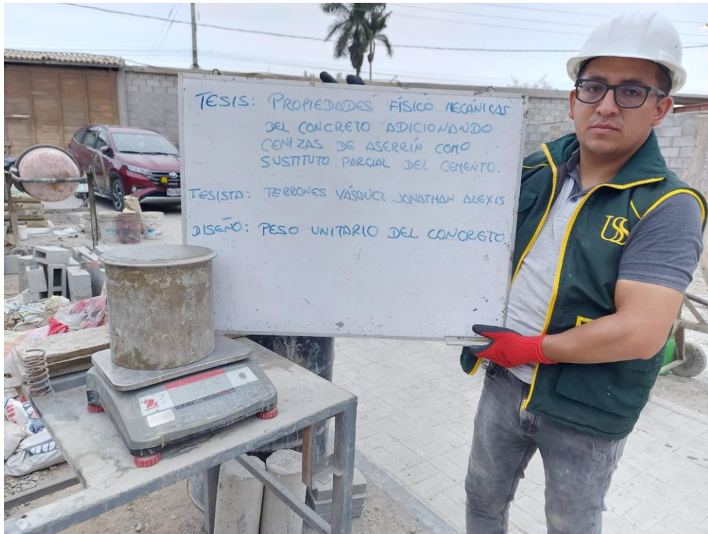
Fig. 53. Ensayo de peso unitario del concreto.
