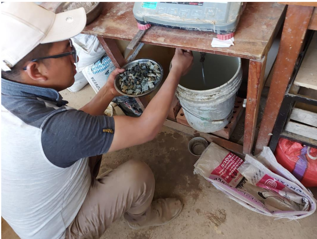
Fig. 46. Ensayo de peso específico y absorción del árido grueso.
