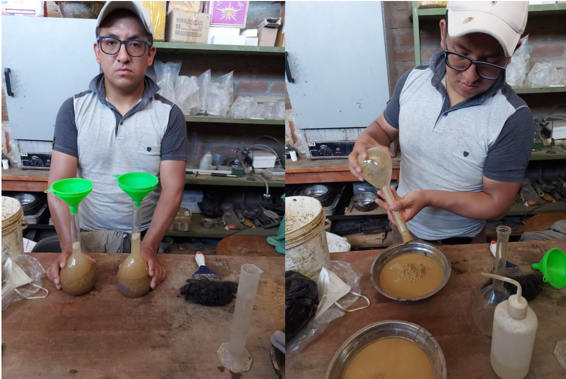
Fig. 45. Ensayo de peso específico y absorción del árido fino.
