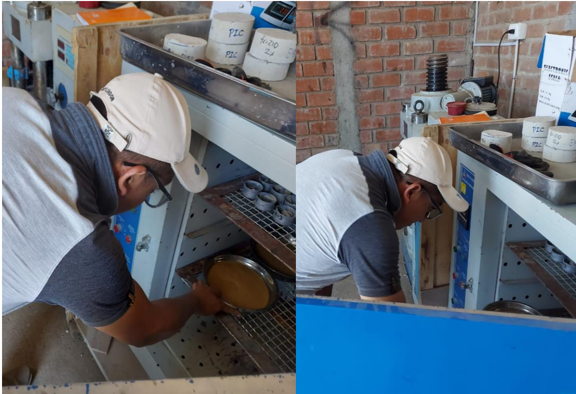
Fig. 47. Ensayo de contenido de humedad del árido fino y grueso.
