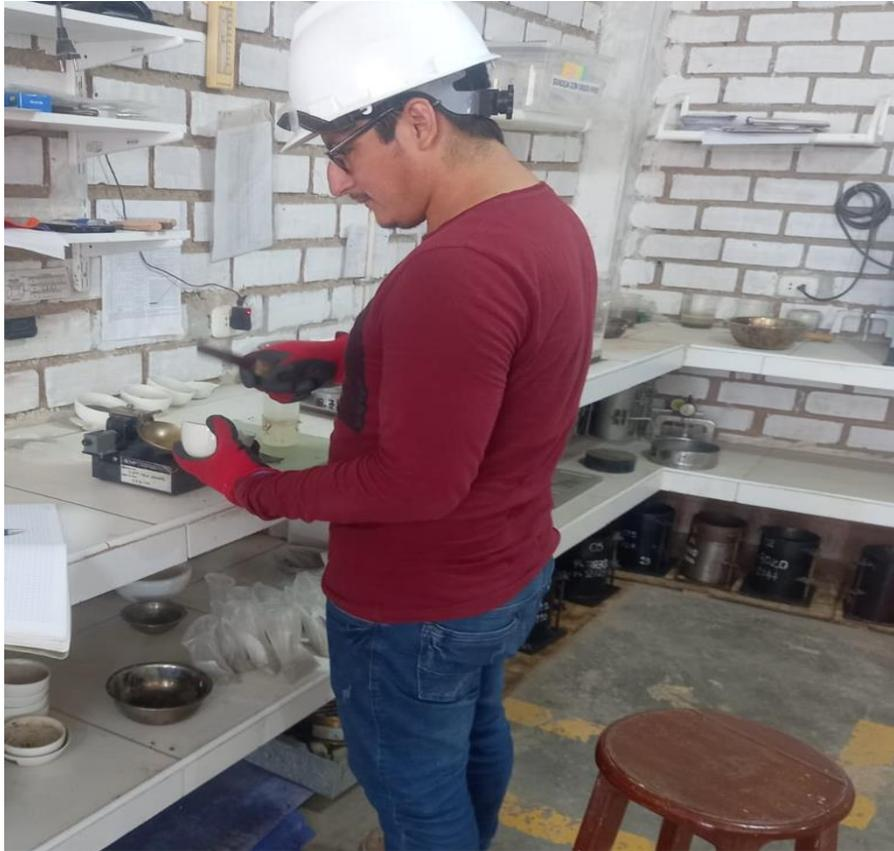
**Foto 5** Ensayo para determinación de límites de consistencia
