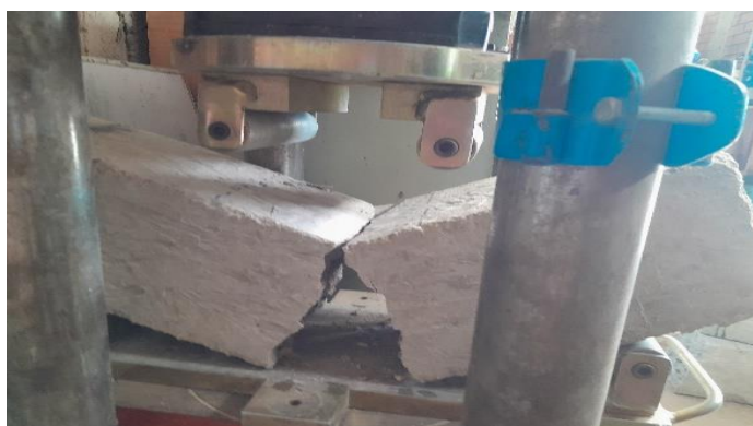
Fig. 13. Ensayo a resistencia probetas y vigas
