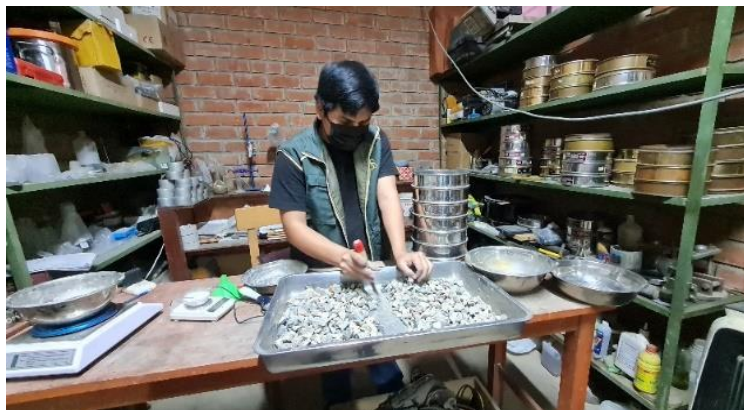
Fig. 10. Cuarteo de agregado fino y grueso
