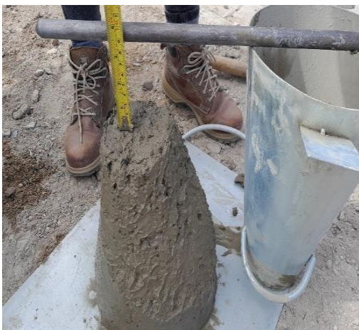
Prueba de Slump
