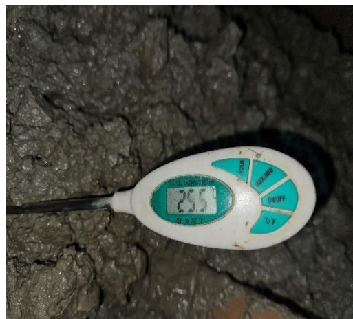
Toma de temperatura del concreto
