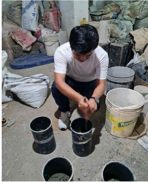
Preparación de probetas de concreto a ser ensayados
