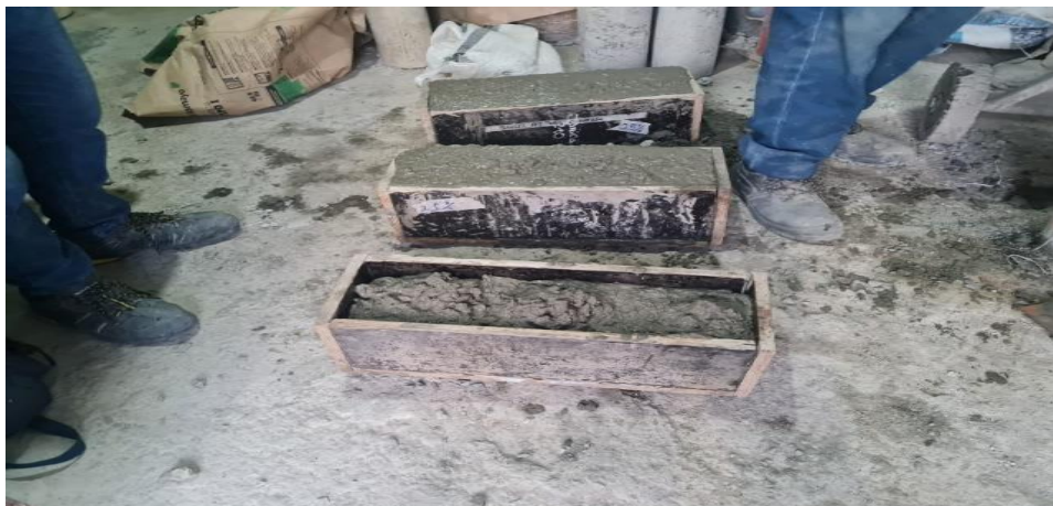
Preparación de vigas a ser ensayados
