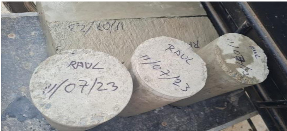
Probetas de concreto
