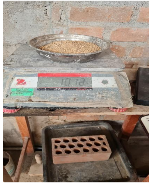
Pesaje de agregado fino
