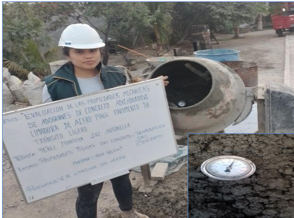
Figura 35. Ensayo de temperatura del concreto
