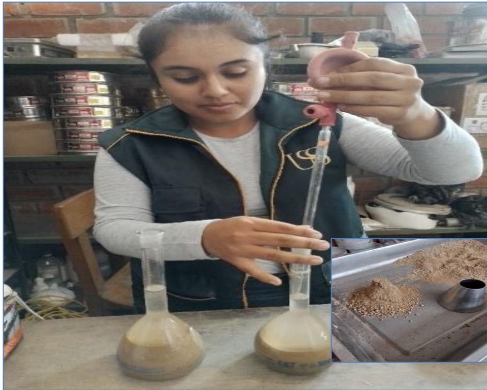
Figura 31. Ensayo de peso específico y absorción del agregado fino
