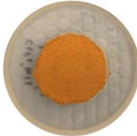
**Figura 1.** Muestra preparada para el análisis de difracción de rayos x en el respectivo portamuestra.
