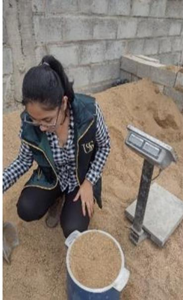
Peso específico y absorción del agregado fino, grueso y cerámica triturada
