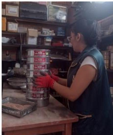
Peso unitario suelto y compactado del agregado fino, agregado grueso y cerámica triturada
