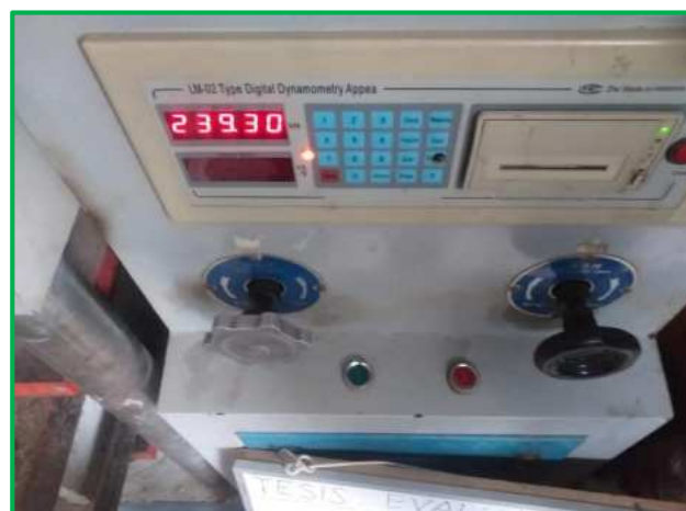
Resultados de las Resistencias a la compresión en unidades de albañilería
