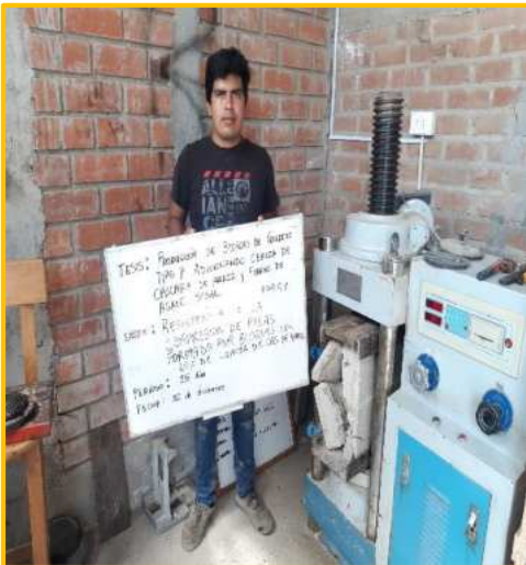
Rotura de pilas – 15% CCA.
