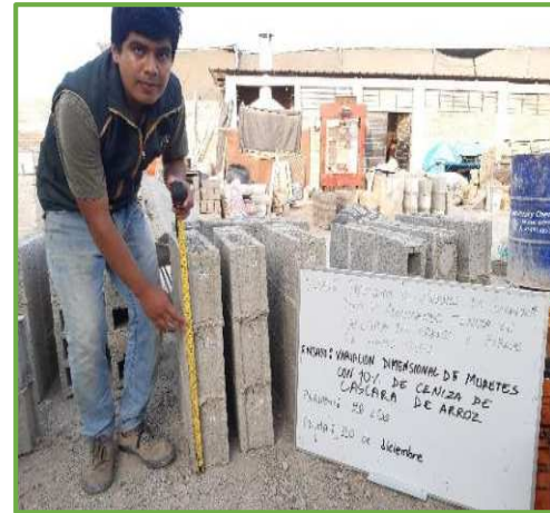
Fig. 13. Variación dimensional de muretes
