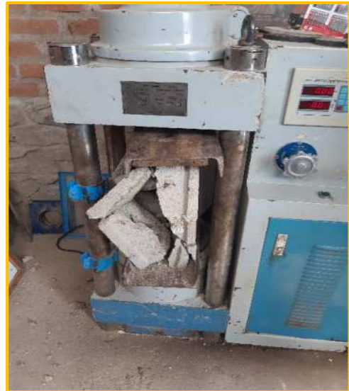
Fig. 20. Rotura de pilas con los diferentes porcentajes de ceniza a los 28 días
