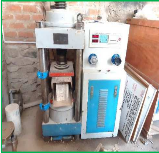
Rotura de unidad de albañilería – edad 7 días
