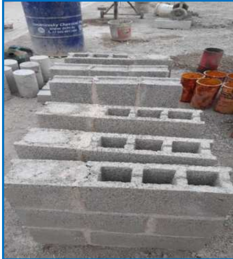
Muretes a ser ensayados.
