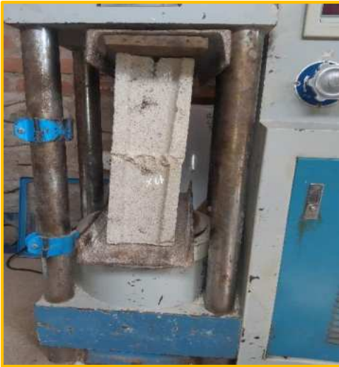
Rotura de pilas – 5% CCA.
