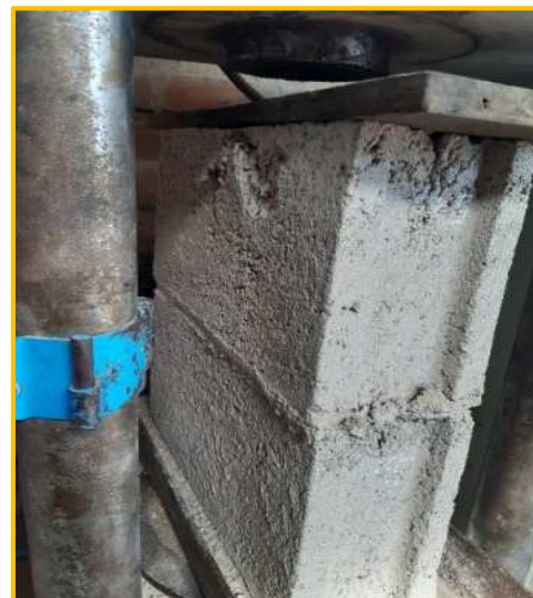
Rotura de pilas – 20% CCA.
