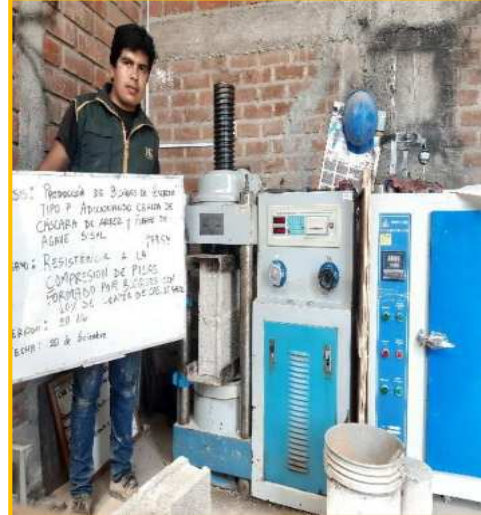
Rotura de pilas – 15% CCA.
