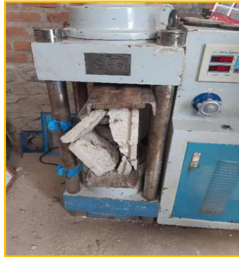
Rotura de pilas – 10% CCA.
