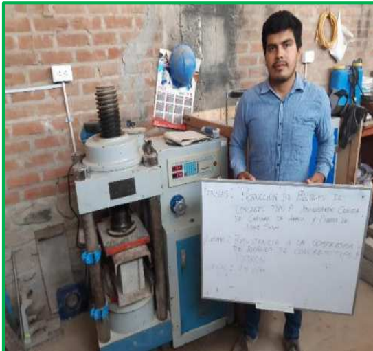
Rotura de unidad de albañilería – edad 14 días
