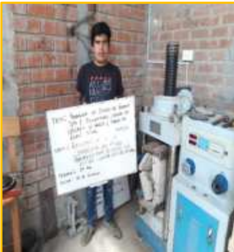
Rotura de pilas – 15% CCA.
