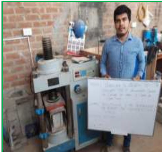
Rotura de unidad de albañilería – edad 14 días
