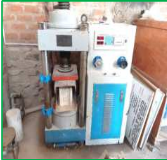
Rotura de unidad de albañilería – edad 7 días
