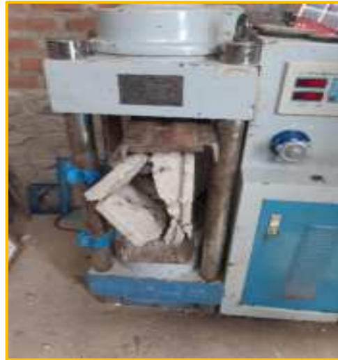
Rotura de pilas – 10% CCA.
