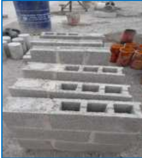
Muretes a ser ensayados.
