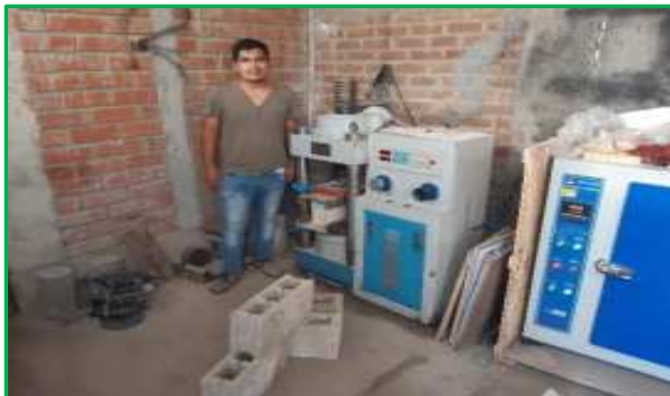
Fig. 18. Rotura de los bloques patrón a los 7 – 14 – 28 días de curado
