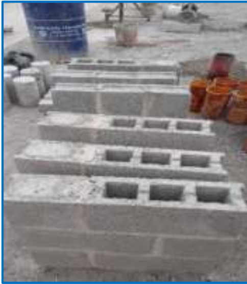
Fig. 19. Rotura de los muretes a los 28 días de los bloques patrón
