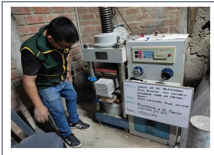
**Fig. 10 Ensayo de Resistencia a la Flexión**
