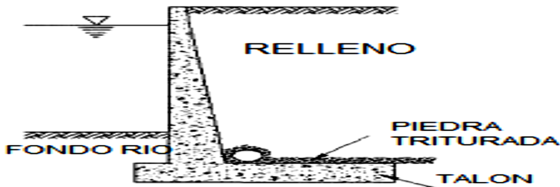
Fig. 11. Detalle de muro de encauzamiento [8].
