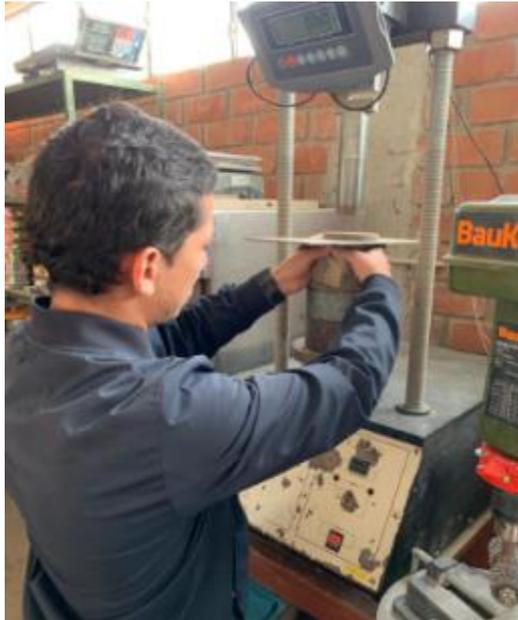
**Fig.34.** Ensayo de resistencia a la compresión de las unidades de adobe
