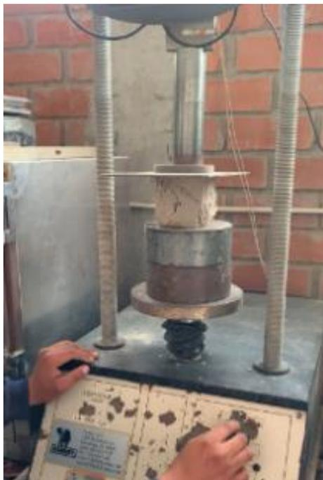
**Fig.35.** Muestra de adobe sometido a ensayo de resistencia a la compresión
