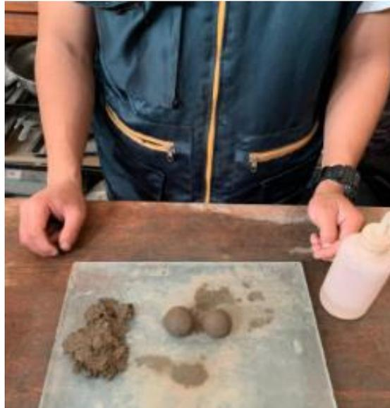
**Fig.26.** Resultado de muestra en prueba de presencia de arcilla.
