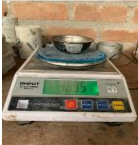
**Fig.21.** Pesado de muestras que son empleadas para el ensayo limite líquido, luego se pasara al horno.
