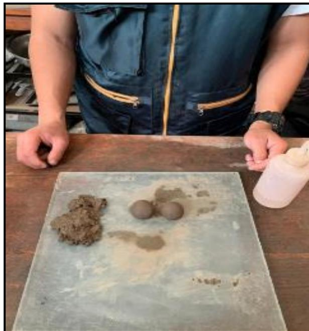
**Fig. 2.** Prueba de presencia de arcilla.
