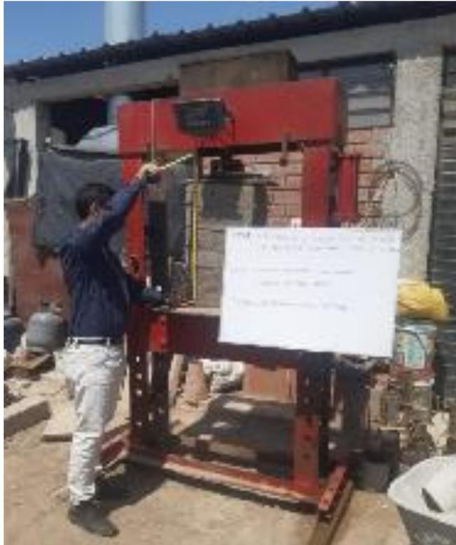
**Fig.39.** Medición de pilas para el ensayo de resistencia a la compresión
