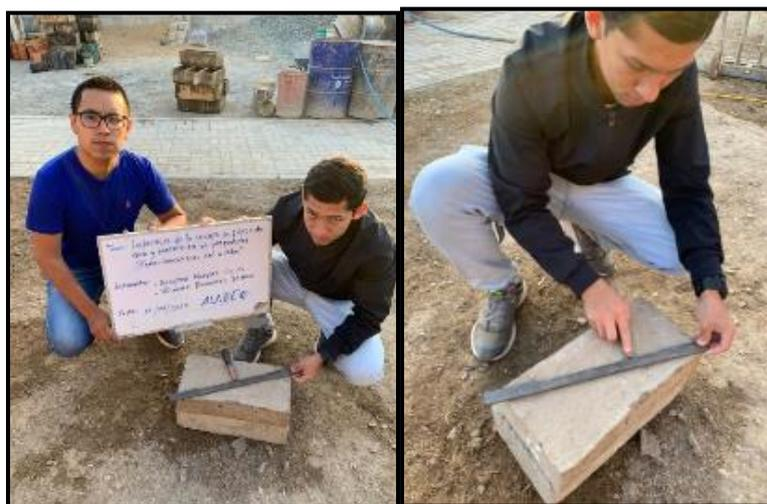
Fig. 7. Ensayo de Alabeo a los Adobes.
