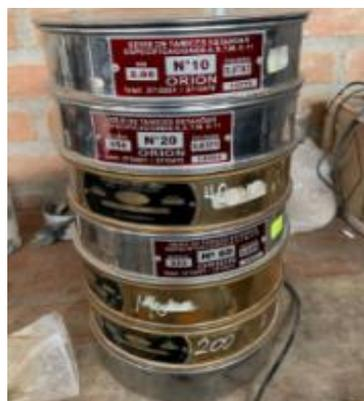
**Fig.17.** Juego de Tamices normalizados para el análisis granulométrico.
