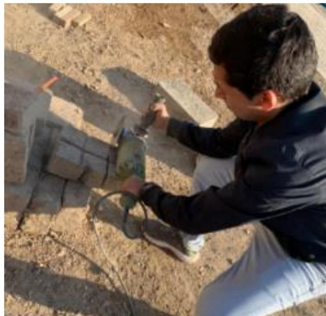
**Fig.33.** Cubos de adobe cortados por la mitad para el ensayo de resistencia a la compresión.
