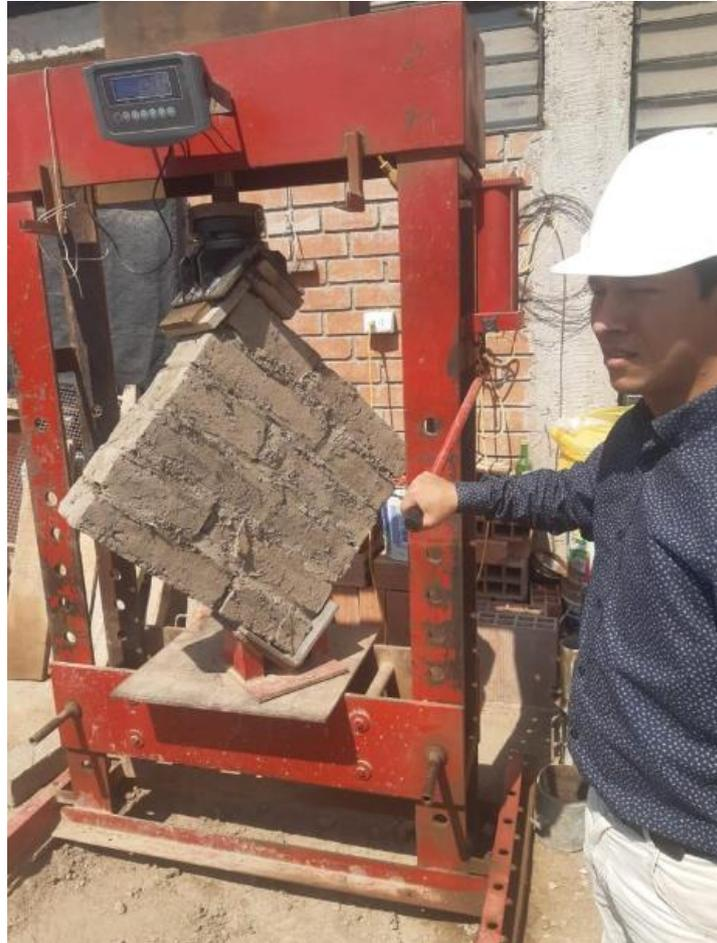
**Fig.41.** Ensayo de compresión diagonal o tracción indirecta aplicada a muretes de adobe.
