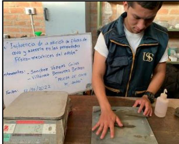
**Fig. 1.** Prueba de cinta de barro.
