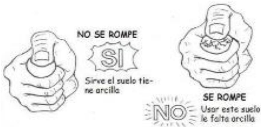
**Fig.24.** Prueba presencia de arcilla o resistencia seca. Norma E 0.80.
