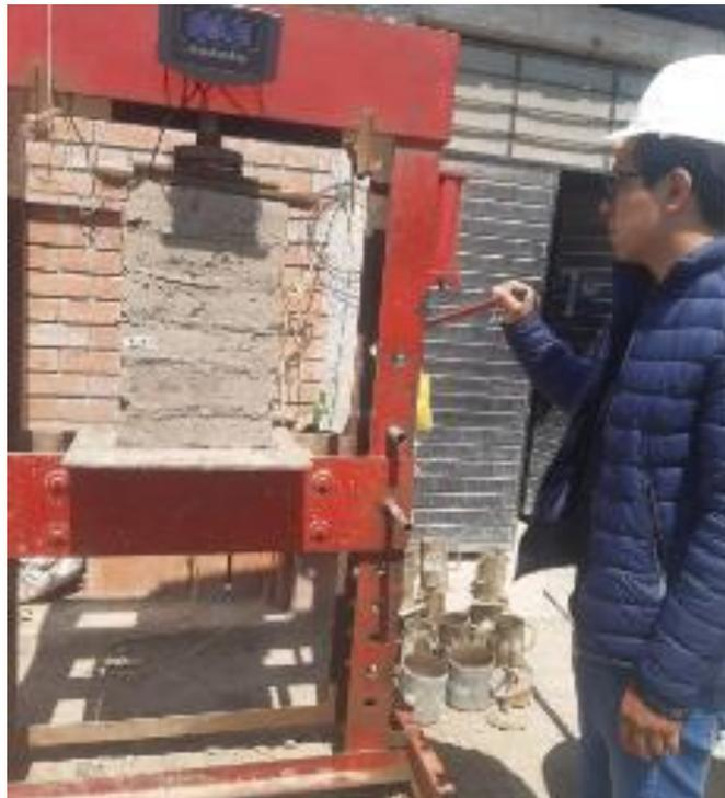
**Fig.40.** Comportamiento de pilas sometidas a ensayo de resistencia a la compresión
