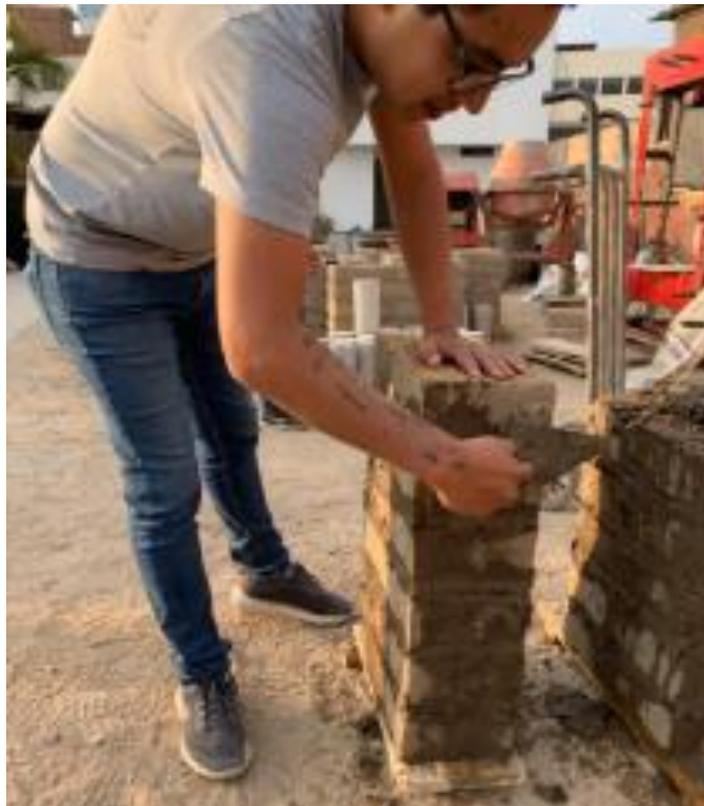
**Fig.38.** Muestras de adobes en pilas para ensayo de compresión
