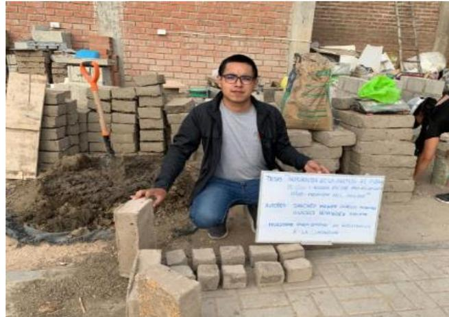
**Fig.32.** Cubos de adobe empleados en el ensayo de resistencia a la compresión.
