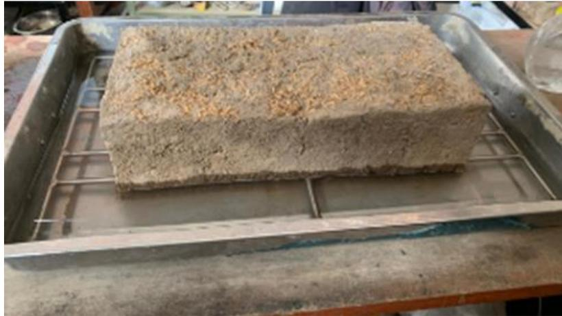
**Fig.36.** Muestra de adobe sometido a ensayo de periodo inicial de absorción (Succión).
