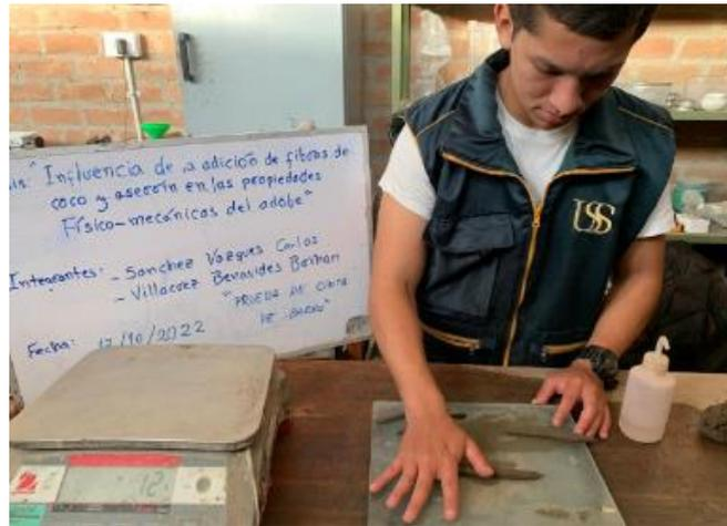
**Fig.23.** Procedimiento de prueba de cinta de barro.
