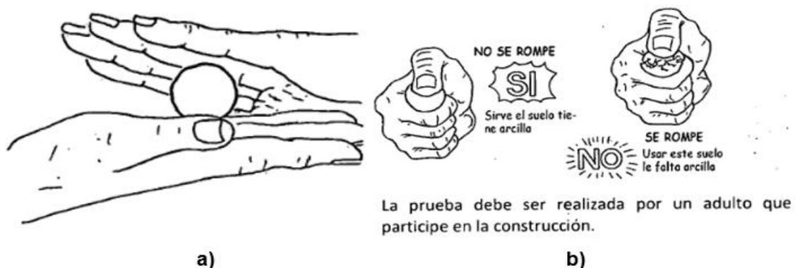
**Fig.2.** Prueba "presencia de arcilla" o "resistencia seca" [13].
