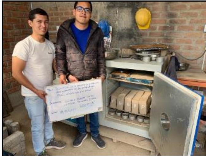
Fig. 5. Secado de los adobes para el ensayo de absorción.
