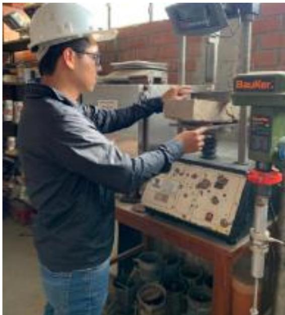
**Fig.42.** Ensayo de resistencia a la flexión de las unidades de adobe.
