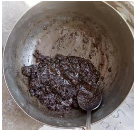
Fig. 24 Imagen del concreto f'c=210 kg/cm 2 con adicción del 23% de resina poliéster
