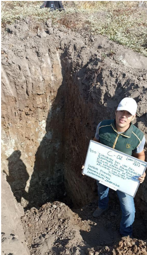
Fig. 4. Excavación de calicatas y extracción de suelos para nuestro estudio.
