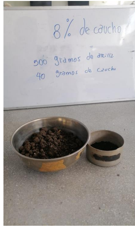
Fig. 5. Pesaje y dosificación de suelo y caucho granular para ensayo de compresión simple.
