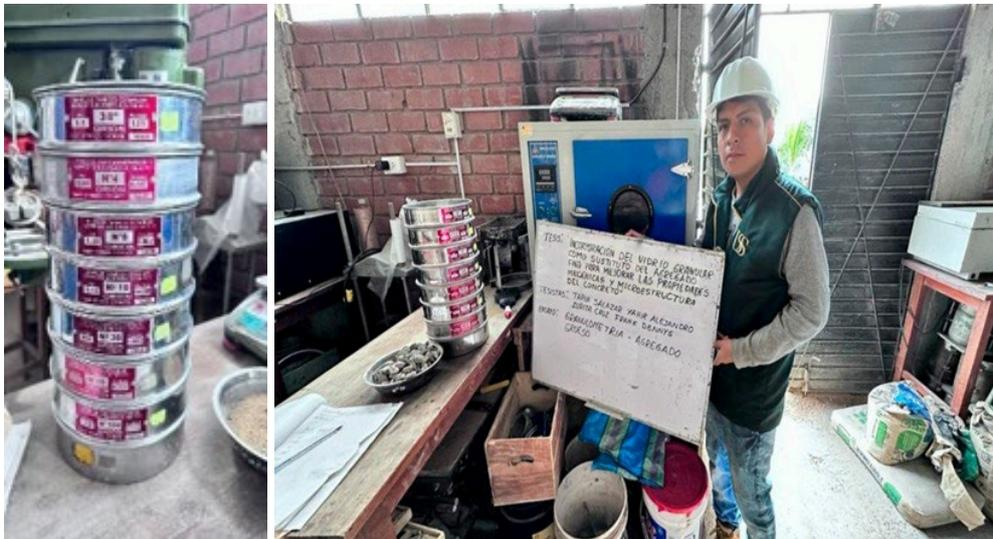
**Fig. 20. Ensayo de granulometría de agregado fino y grueso**
