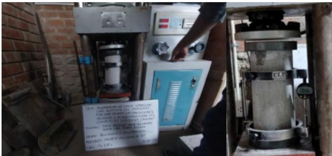
**Fig. 29.** Ensayo de resistencia a la compresión y módulo de elasticidad
