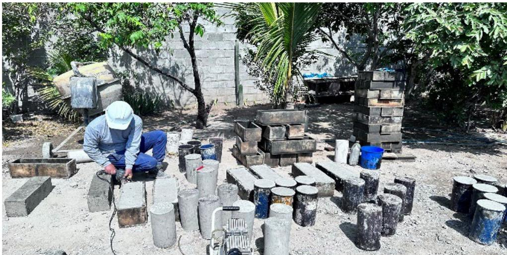
**Fig. 28.** Desmoldado de los cilindros y vigas de concreto
