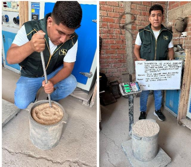
**Fig. 24.** Ensayo de peso unitario suelto y compactado del vidrio granular
