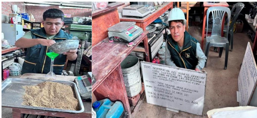
**Fig. 22.** Ensayo de peso específico y absorción del agregado fino y grueso.
