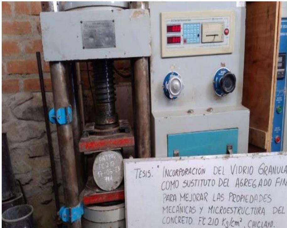
**Fig. 31.** Ensayo de resistencia a la tracción
