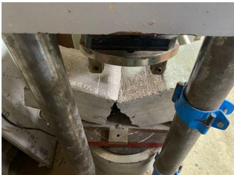
**Fig. 30.** Ensayo de resistencia a la flexión
