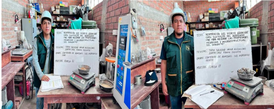
**Fig. 23.** Ensayo de contenido de humedad del agregado fino y grueso.
