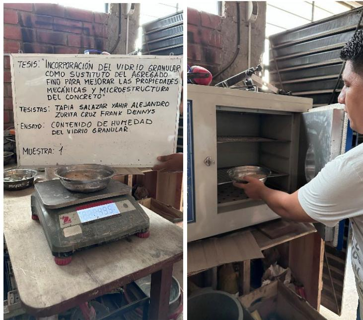
**Fig. 25.** Ensayo de contenido de humedad del vidrio granular
