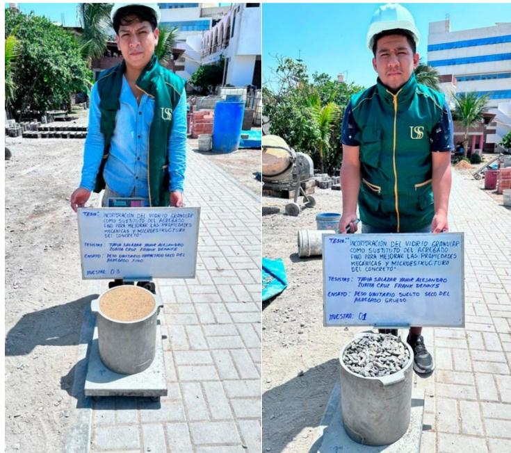
**Fig. 21.** Ensayo de peso unitario suelto y compactado del agregado fino y grueso
