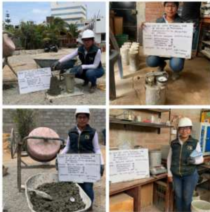
FOTO- Ensayos al concreto en estado fresco
