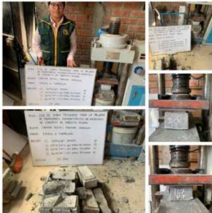
FOTO-Ensayo de resistencia a la compresión
