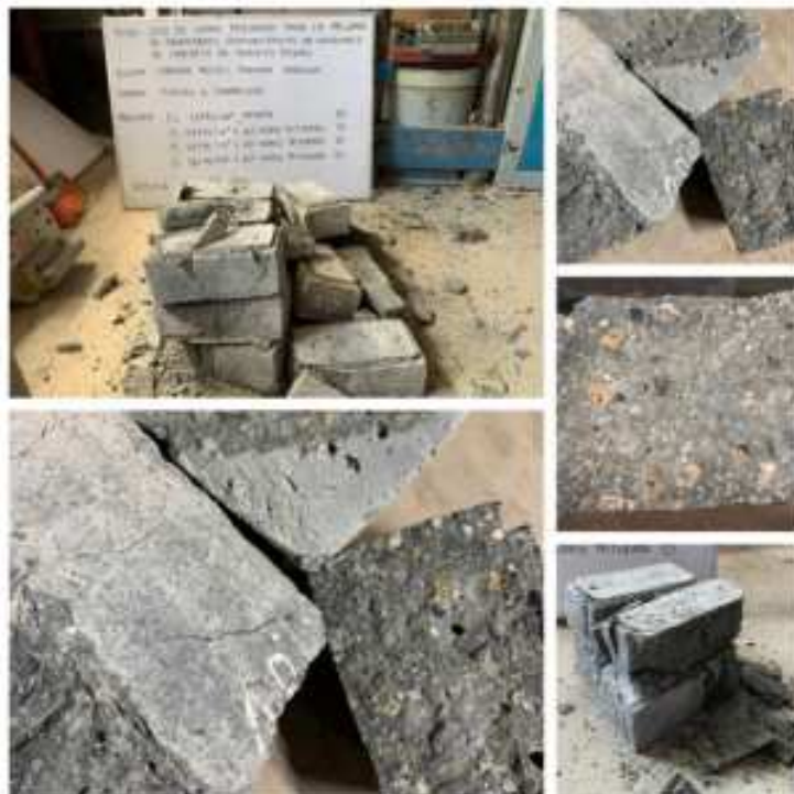
FOTO- Roturas de los adoquines
