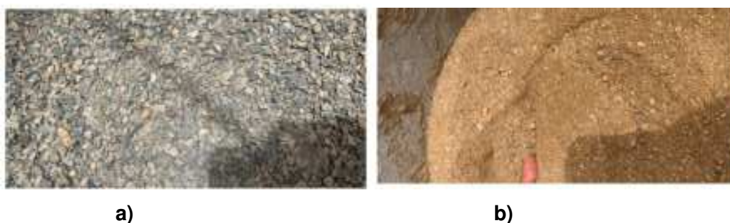
Fig. 1. (a) y (b) Agregados utilizados, confitillo y el agregado fino.
