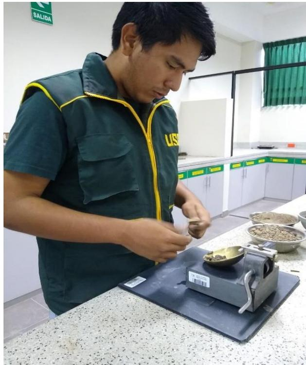
**Fig. 19.** Uso de la Copa Casagrande en el ensayo de limite liquido de suelos.
