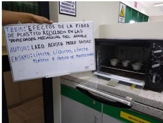
**Fig. 20.** Muestras usadas para el ensayo de limite plástico.
