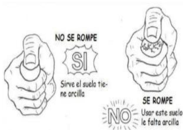
**Fig. 23.** Prueba de Presencia de Arcilla o Resistencia Seca. [40]
