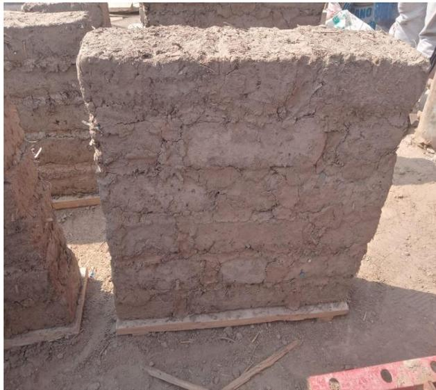
**Fig. 40.** Murete elaborado para el ensayo de Compresión Diagonal
