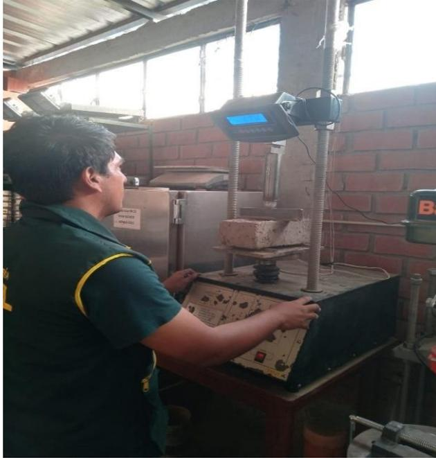
**Fig. 60.** Ensayo de Resistencia a la Flexión del Bloque de Adobe.
