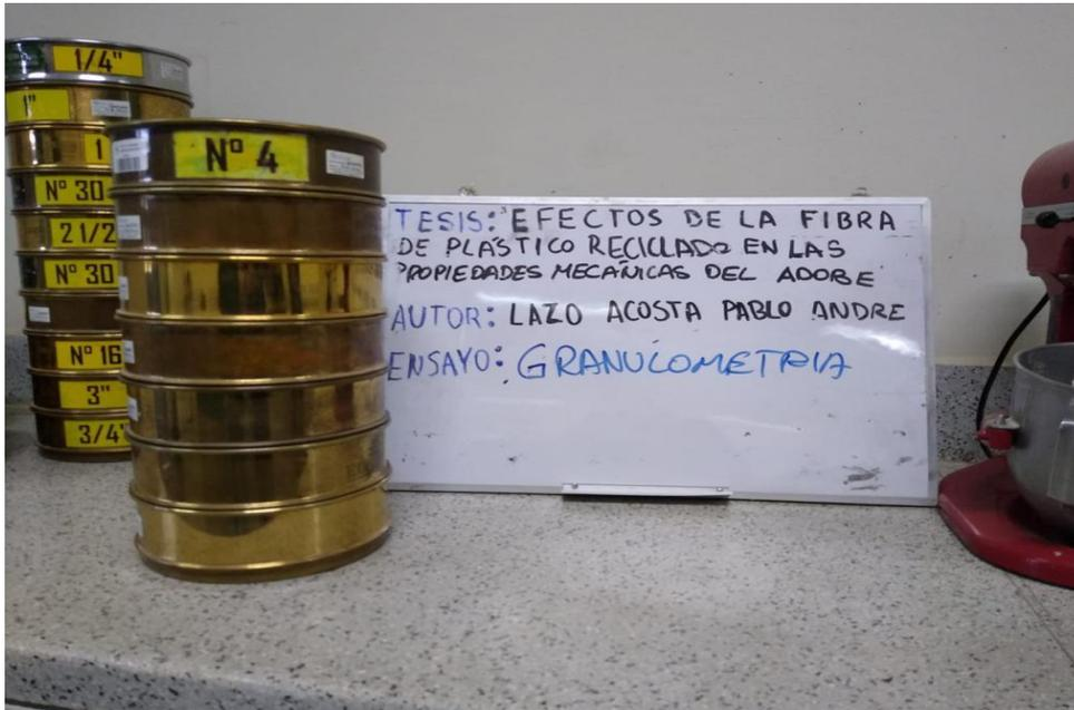
**Fig. 56.** Tamices Utilizados para el ensayo de Granulometría.
