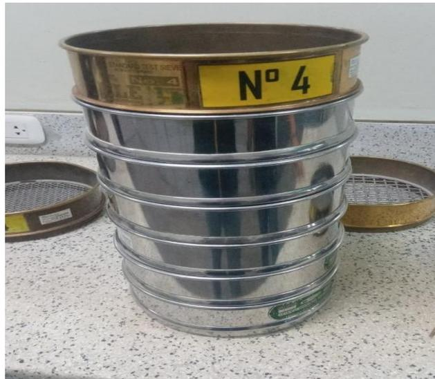
**Fig. 16.** Tamices empleados para el ensayo de granulometría
