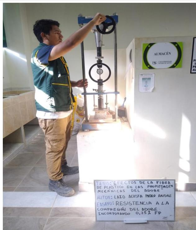
**Fig. 59.** Ensayo de Resistencia a la Compresión de la Unidad de Adobe.
