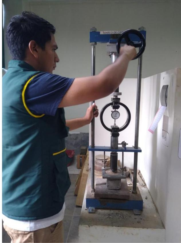
**Fig. 33.** Ensayo de resistencia a la compresión en unidades de adobe
