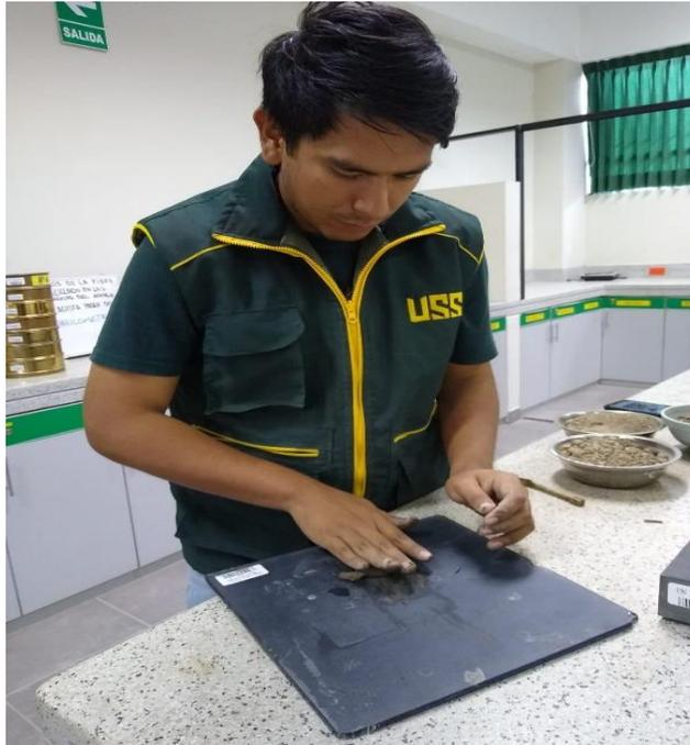
**Fig. 22.** *Ensayo de prueba de cinta de barro*
