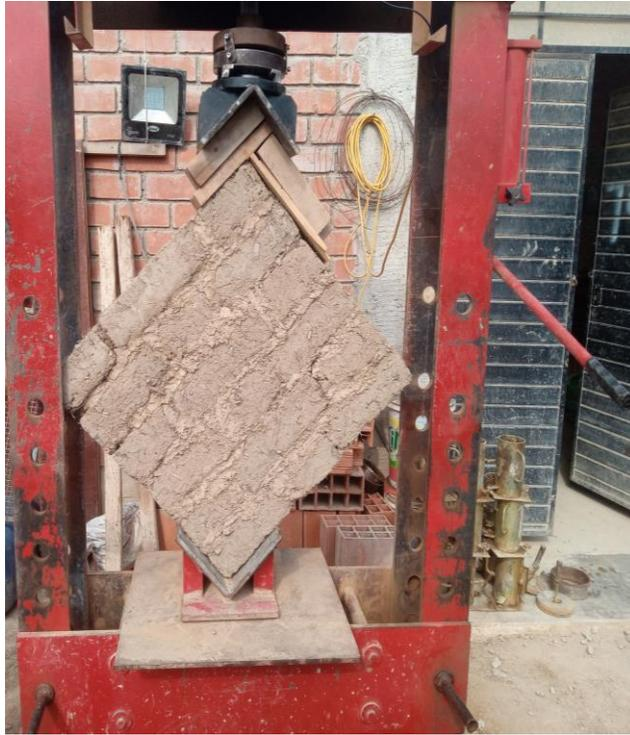
**Fig. 62.** Ensayo de Resistencia a la Compresión del Murete de Adobe.
