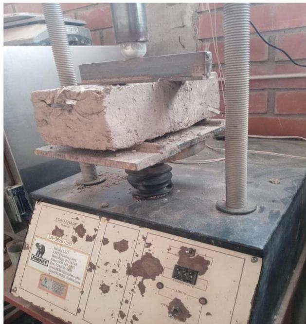
**Fig. 35.** Ensayo de resistencia a la flexión
