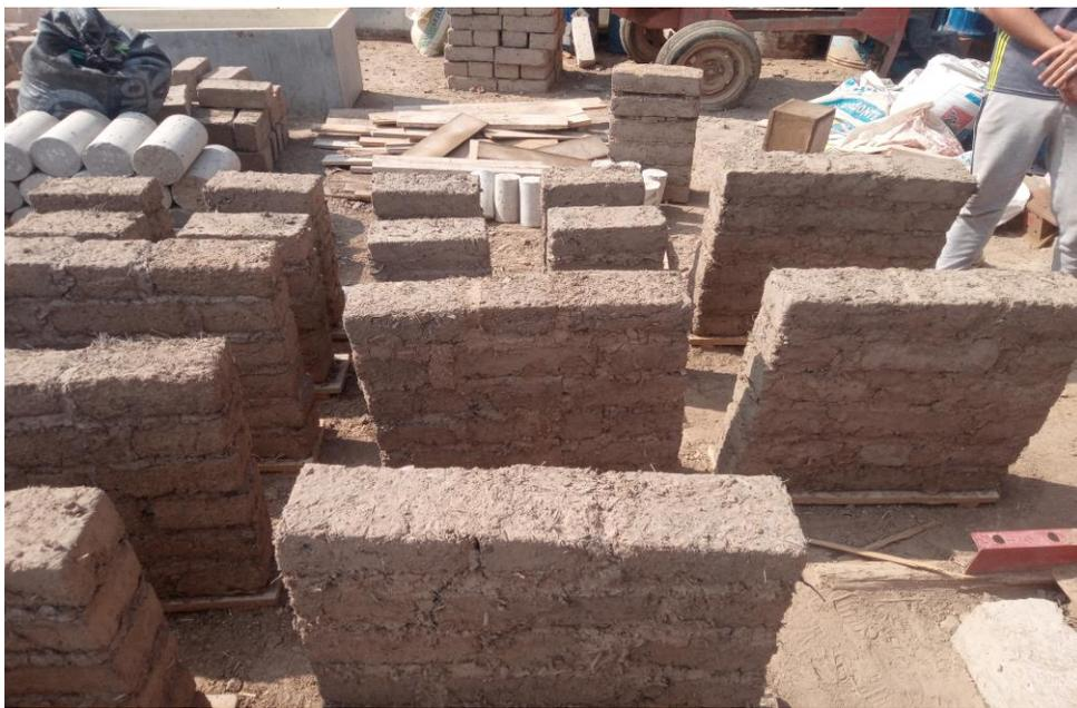
**Fig. 55.** Secado de Muretes y Prismas de Adobe.
