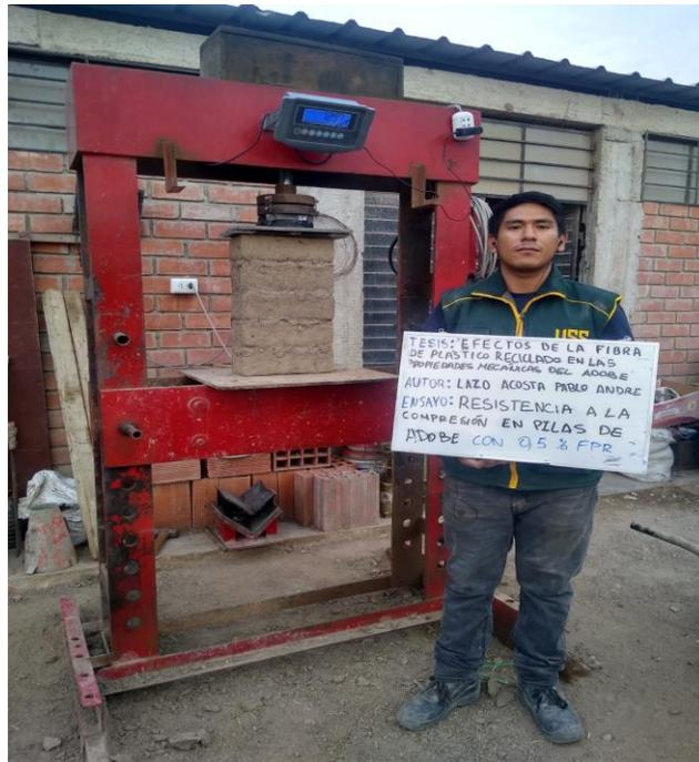
**Fig. 61.** Ensayo de Resistencia a la Compresión de Prismas de Adobe.
