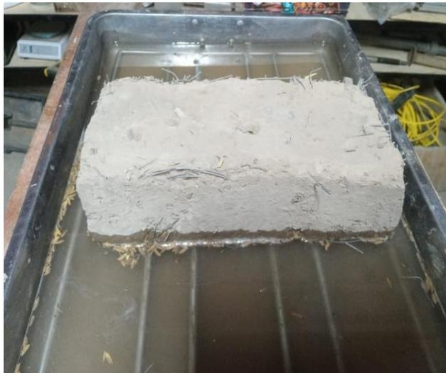
**Fig. 36.** Ensayo de Periodo Inicial de Absorción (Succión)
