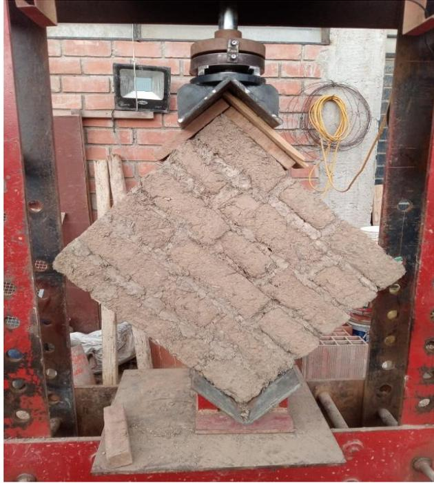
**Fig. 41.** Murete sometido al ensayo de Compresión Diagonal
