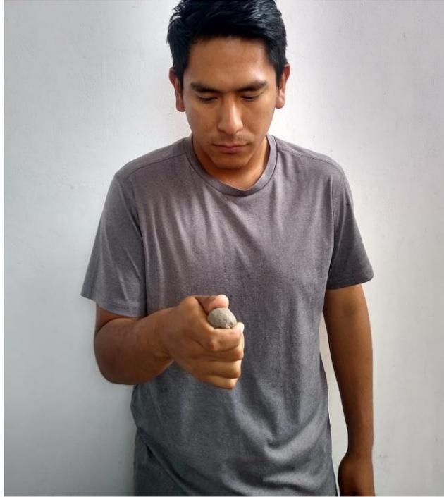
**Fig. 25.** Ejecución de la prueba de Presencia de Arcilla
