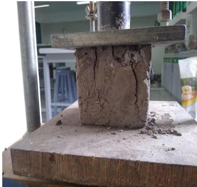
**Fig. 34.** Resultado unidad de adobe en ensayo de resistencia a la compresión
