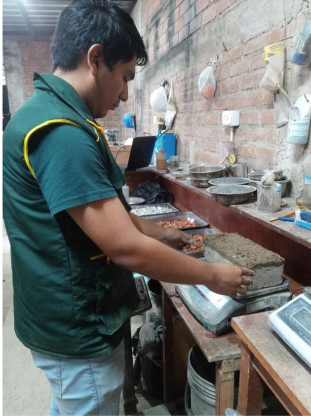
**Fig. 37.** Pesado de la muestra para ensayo de Periodo Inicial de Absorción (Succión)
