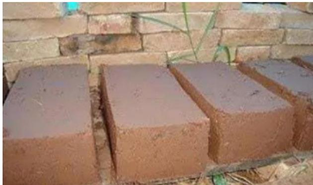
**Fig.10.** Secado del adobe desmoldado. [38]
