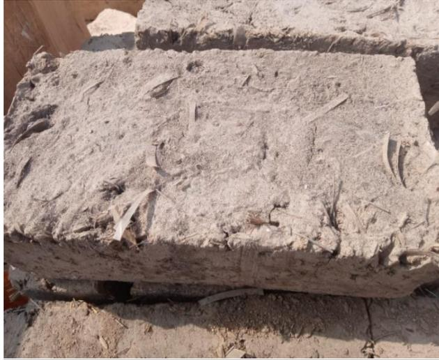
**Fig. 31.** Bloque de Adobe con Fibra de Plástico Reciclado
