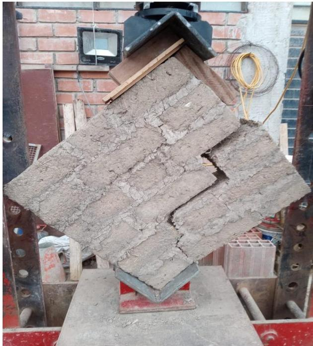
**Fig. 42.** Resultado del murete al ensayo de Compresión Diagonal
