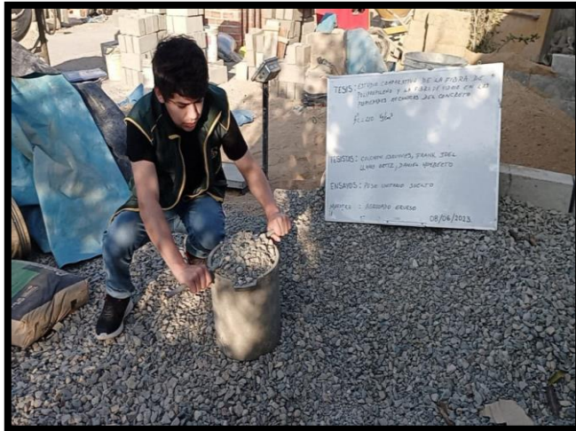
Fig. 23. Ensayo de peso unitario suelto del agregado grueso
