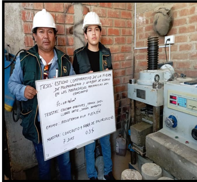
Fig. 34. Ensayo de la resistencia a la flexión
