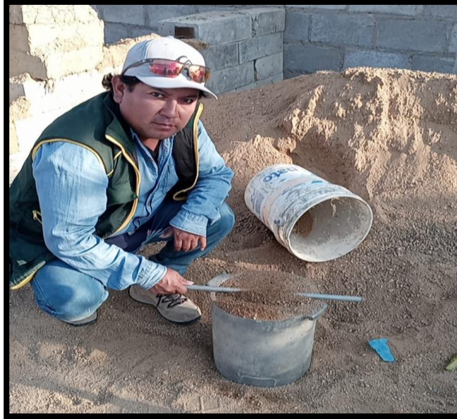
Fig. 24. Ensayo de peso unitario suelto del agregado fino
