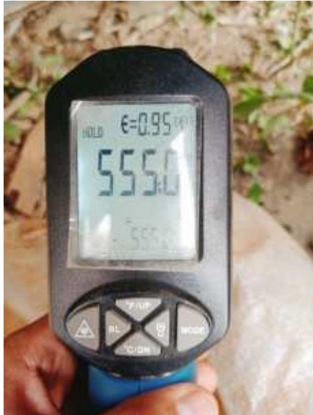
**Fig. 3** Quemado de la cáscara de café a 550°C durante un lapso de 5 horas
