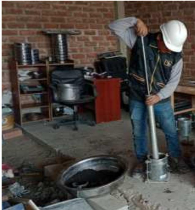
**Fig. 21** Ensayo de CBR, golpes de compactación por capas para 10%CCC
