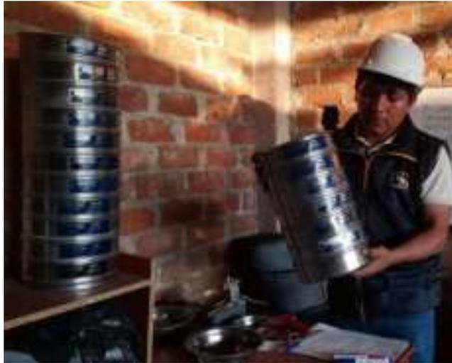
**Fig. 10** Ensayo de análisis granulométrico
