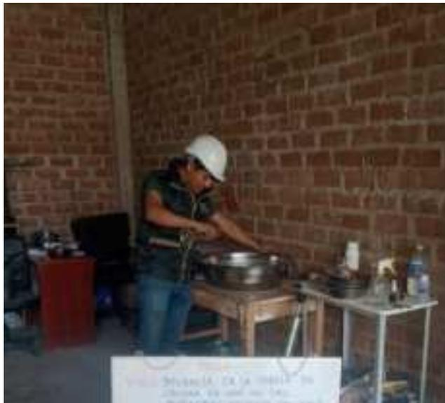
**Fig. 19** Adición de 15% de CCC al suelo para ensayo de Proctor Modificado
