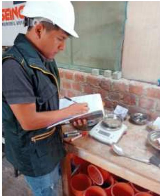
**Fig. 9** Pesado de la muestra para el Ensayo de contenido de humedad
