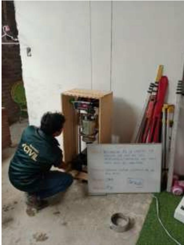
**Fig. 14** Ensayo de CBR
