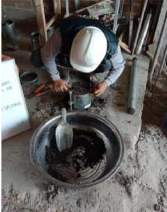
**Fig. 20** Ensayo Proctor Modificado, golpes de compactación
