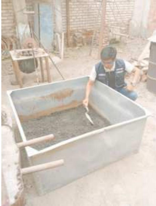
**Fig. 16** Secado de la ceniza de cáscara de café
