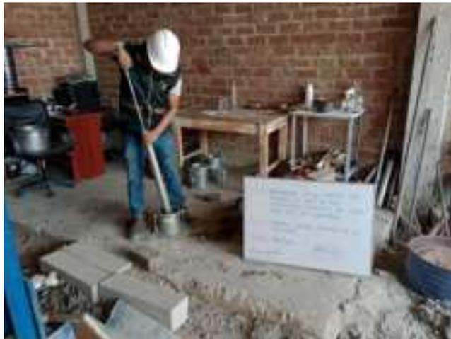
**Fig. 13** Golpes de compactación por capas para el Proctor Modificado
