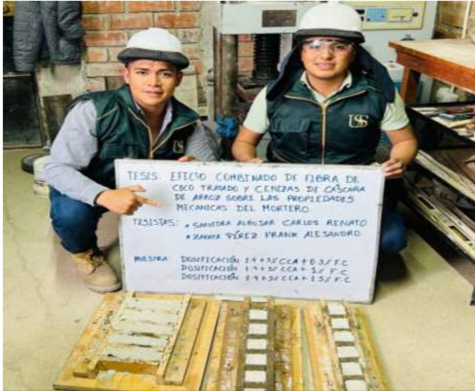
Fig. 17: Realización de cubos y vigas de mortero con adición de ceniza de cascara de arroz y fibra de coco, con dosificación de 5%CCA + 0.5FC, 5%CCA + 1FC; 5%CCA + 1.5FC
