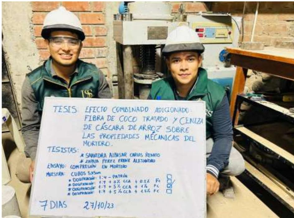
Fig. 18: Ensayo de compresión en cubos de mortero a los 7 días; con dosificación del mortero patrón 1:4, y adiciones de 5% CCA + 0.5%FC; 5%CCA + 1%FC, 5%CCA + 1.5%FC
