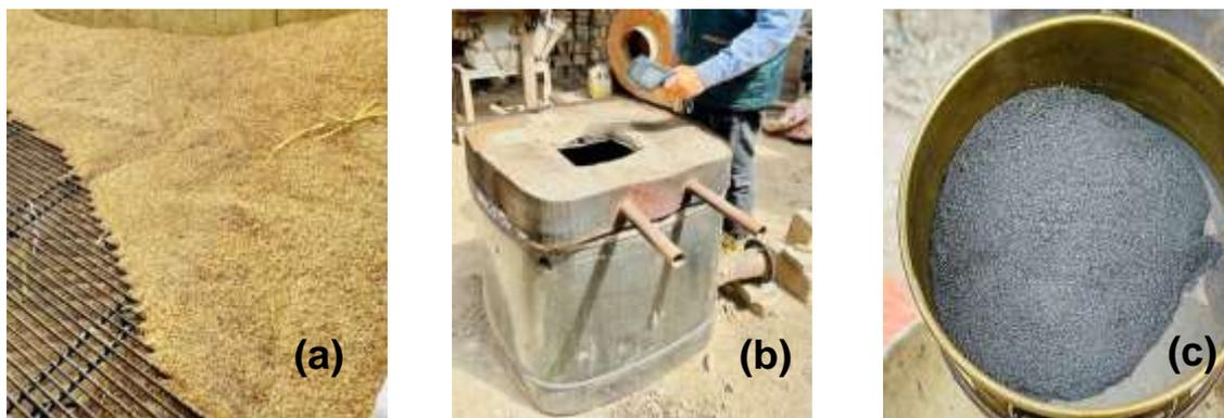
Fig. 2: (a) recolección de Cascarilla de arroz, (b) Incineración y determinación de temperatura, (c) Tamizado en malla N° 200.
