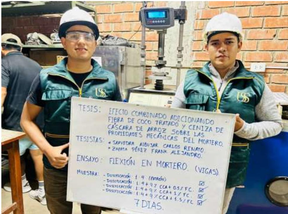
Fig. 21: Ensayos de flexión de vigas de mortero a los 7 días, con dosificación patrón 1:4 del mortero y adicionando de 9% CCA + 0.5%FC, 9%CCA + 1%FC, 9%CCA + 1.5%FC.
