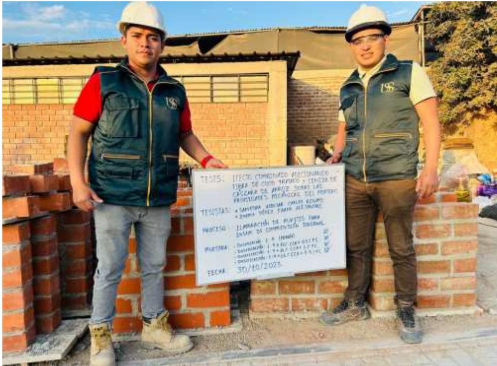
Fig. 20: Elaboración de muretes para ensayos de compresión diagonal a los 7, 14 y 28 días, con dosificación del mortero adicionando de 16% CCA + 0.5%FC, 16%CCA + 1%FC, 16%CCA + 1.5%FC
