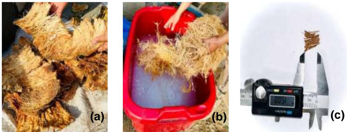
Fig. 3: (a) Desfibrado de coco, (b) Tratamiento químico disuelto en agua y cal, (c) Medición y recorte de fibras a 1.5 cm.
