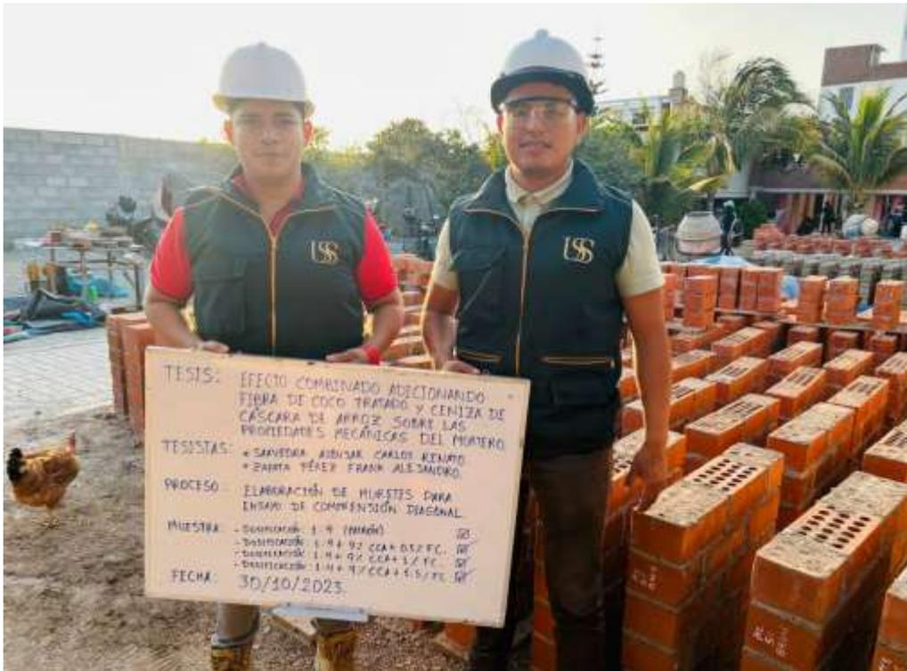
Fig. 19: Elaboración de muretes para ensayos de compresión diagonal a los 7, 14 y 28 días, con dosificación del mortero patrón 1:4, y adiciones de 9% CCA + 0.5%FC; 9%CCA + 1%FC, 9%CCA + 1.5%FC
