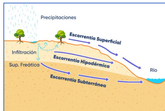
Fig. 5. Tipos de escorrentía
