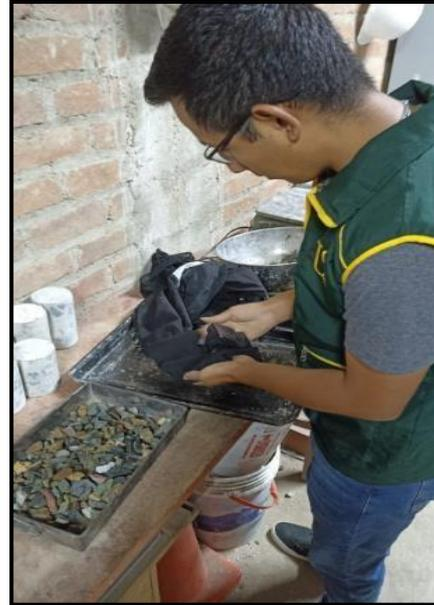
**Fig. 19.** Peso específico y absorción del AG
