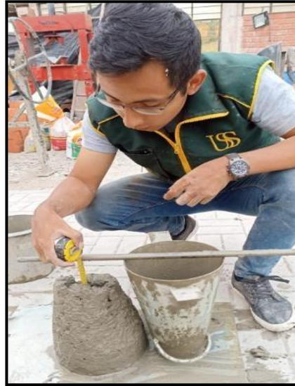
**Fig. 20.** Medición del Asentamiento.
