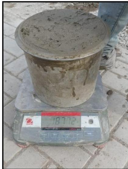
**Fig. 21.** Medición del peso unitario
