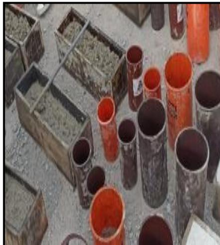
**Fig. 23.** Vaciado y secado de las muestras
