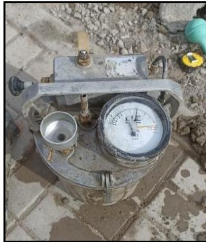
**Fig. 22.** Medición del contenido de aire.
