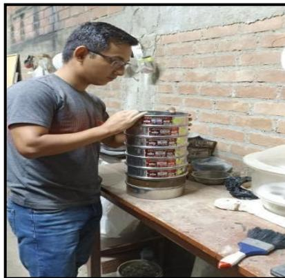
**Fig. 18.** Análisis granulométrico
