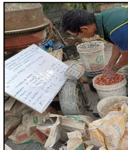
Este procedimiento consiste en preparar el material agregado fino, agregado grueso y el ladrillo triturado para los diferentes porcentajes hasta lograr una mezcla uniforme.
