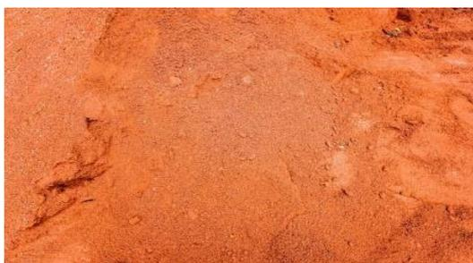
**Fig. 4.** Material reciclado de ladrillo triturado. [32]
