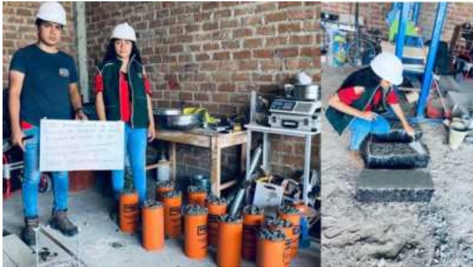
**Fotografía 13:** Diseño y preparado de concreto patrón + CBCA en probetas y vigas.
