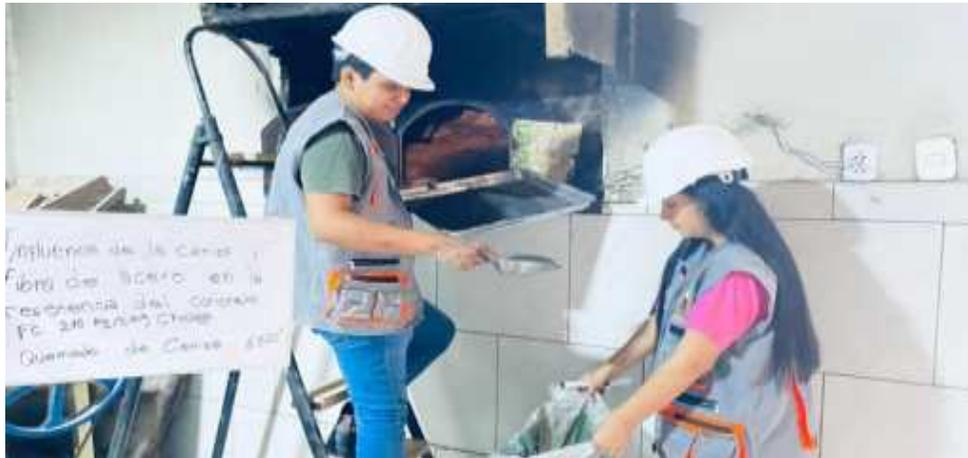
**Fotografía 5:** Quemado a 650°C y extracción de la ceniza de bagazo de caña de azúcar.
