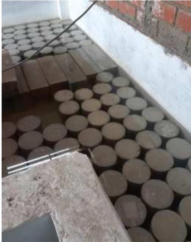
**Fig.17.** Curado de muestras de concreto
