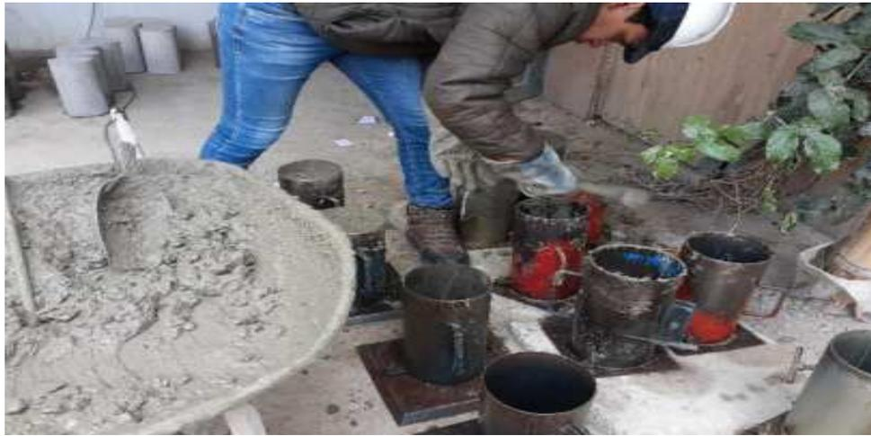
**Fotografía 11:** Vaciado de concreto patrón.
