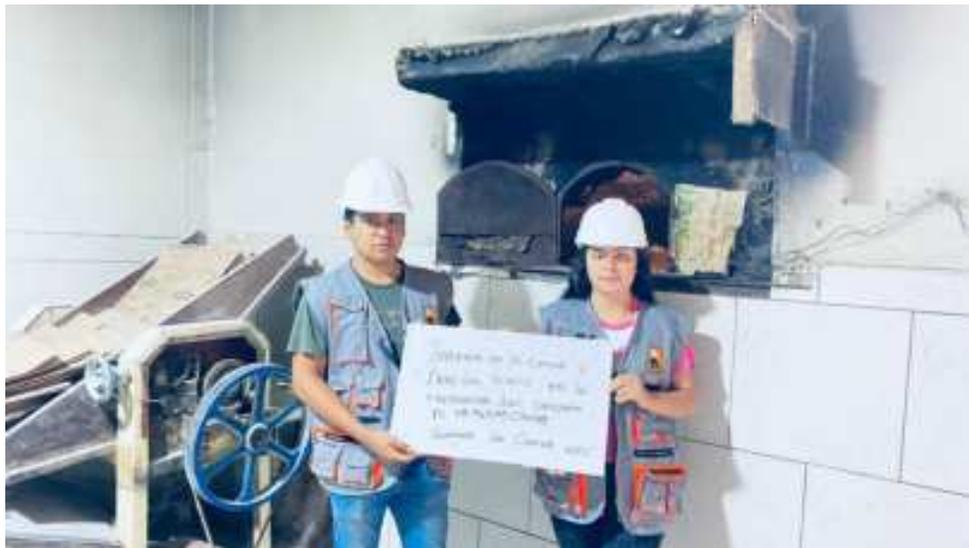
**Fotografía 4:** Horno para el quemado del bagazo de caña de azúcar.
