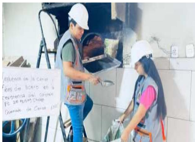
**Fig.12.** Quemado a 650°C y extracción de la CBCA
