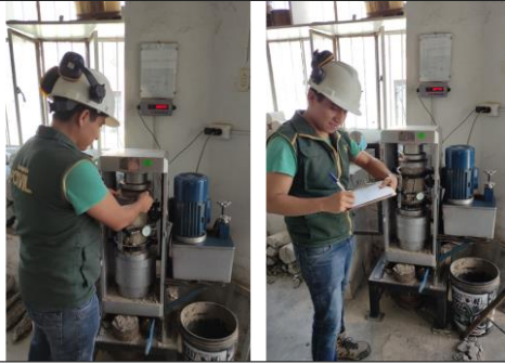
Foto N°50: Roturas de probetas cilíndricas a compresión y módulo de elasticidad según días de curado.
