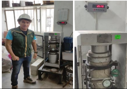
Foto N°39: Roturas de probetas cilíndricas a compresión y módulo de elasticidad a 14 días de curado.
