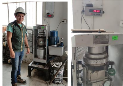
Foto N°45: Roturas de probetas cilíndricas a compresión y módulo de elasticidad a 14 días de curado.
