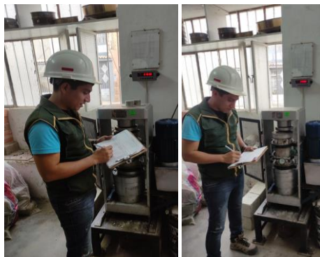
Foto N°42: Roturas de probetas cilíndricas a compresión y módulo de elasticidad a 14 días de curado.
