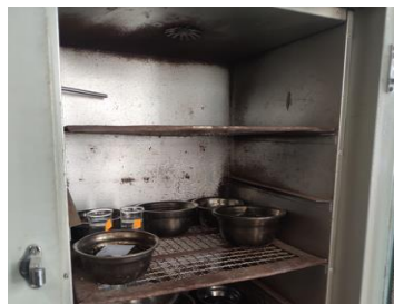
Foto N°12: Muestras puestas al horno 110 \pm 5 °C durante 24h
