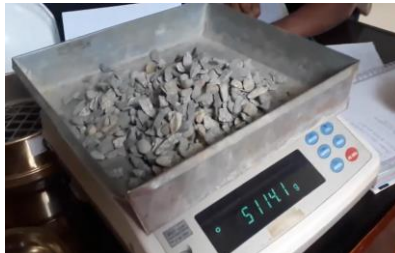
Foto N°18: Muestra de agregado grueso (Mayor a 5kg) y posterior secado al horno
