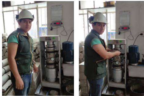
Foto N°40: Roturas de probetas cilíndricas a compresión y módulo de elasticidad a 28 días de curado.
