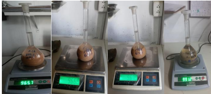
Foto N°22: Luego se elimina los vacíos agitando el Picnómetro y posteriormente se toma Peso de la Muestra Saturada Superficialmente Seca + Peso del Frasco + Peso del agua, de todas las canteras a estudiar.
