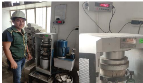
Foto N°35: Roturas de probetas cilíndricas a compresión y módulo de elasticidad a 7 días de curado.
