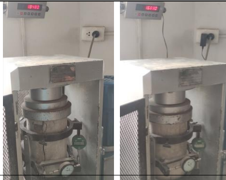
Foto N°41: Roturas de probetas cilíndricas a compresión y módulo de elasticidad a 7 días de curado.
