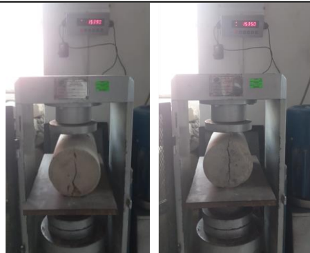
Foto N°51: Roturas de probetas cilíndricas a tracción a los días de curado.
