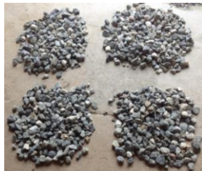
Foto N°17: Cuarteo de agregado grueso (20kg)
