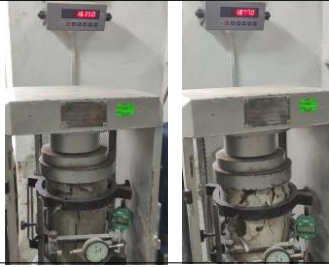
Foto N°44: Roturas de probetas cilíndricas a compresión y módulo de elasticidad a 7 días de curado.
