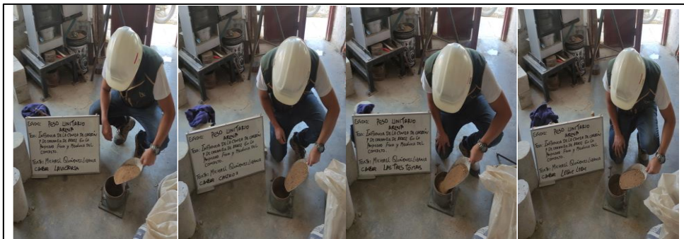
Foto N°26: Llenado del agregado fino en el recipiente, de cada cantera.
