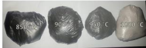
Foto N°06: Muestras tamizadas de 850, 900, 950 y 1000 °C y posterior envío a analizar.
