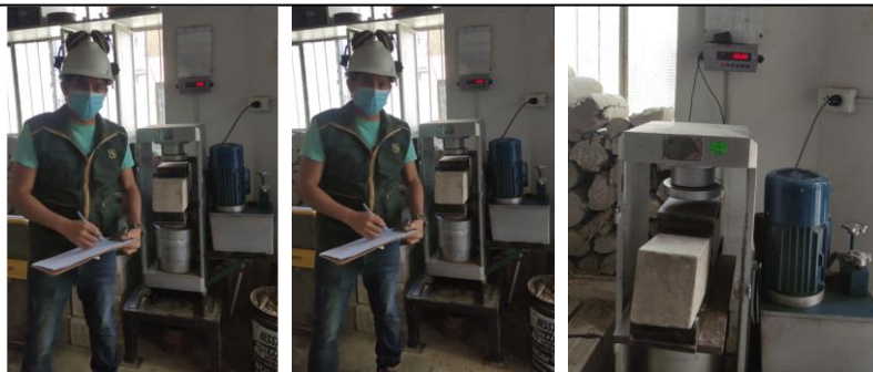
Foto N°52: Roturas de vigas rectangulares a flexión a los días de curado.
