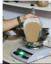
Foto N°14: Muestra de agregado fino y posterior secado al horno
