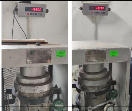
Foto N°47: Roturas de probetas cilíndricas a compresión y módulo de elasticidad a 7 días de curado.
