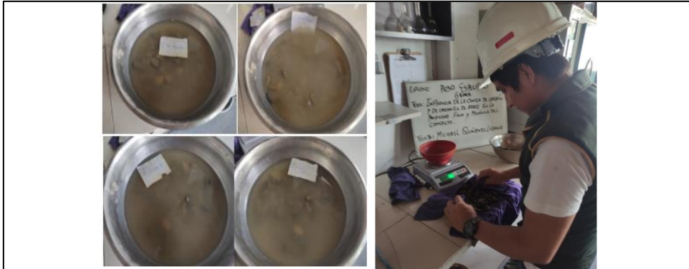
Foto N°24: Muestras de las 4 canteras sumergidas en agua durante 24h aprox., y posterior secado superficialmente y toma de su peso.
