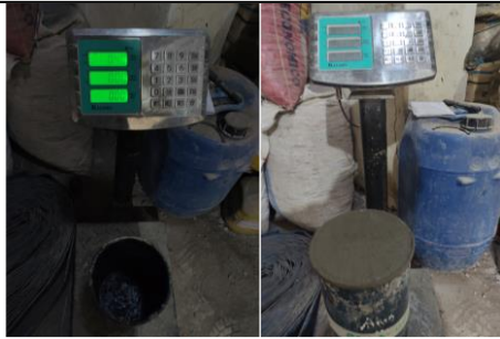
Foto N°34: Para Peso Unitario, se pesó un molde cilíndrico vacío y después se pesó agregando la mezcla. Este procedimiento se realizó para todas las adiciones.
