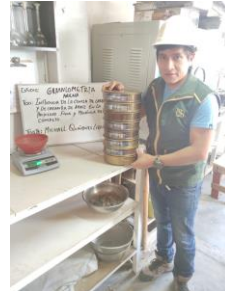
Foto N°16: Tamizado del agregado fino.
