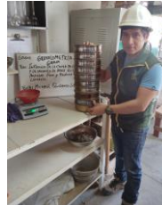
Foto N°20: Tamizado del agregado grueso. los datos.
