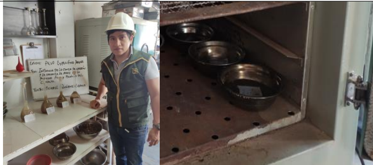
Foto N°23: Las muestras se llevan al horno en recipientes adecuados y posteriormente se toman los pesos y se procesan datos.
