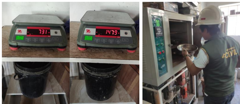
Foto N°25: Peso de la canastilla, Peso de la muestra saturada dentro del agua + peso de la canastilla, luego puesta al horno a secar durante 24h aprox. Y luego se toma el nuevo peso seco y se procesan datos.
