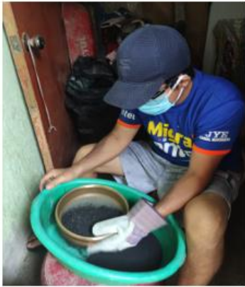
Foto N°05: Tamizado de las muestras por la malla N° 200
