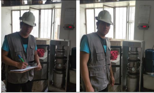
Foto N°38: Roturas de probetas cilíndricas a compresión y módulo de elasticidad a 7 días de curado.
