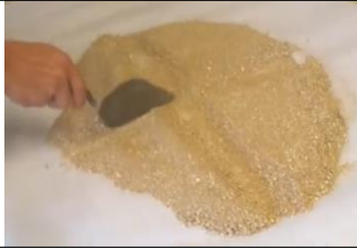
Foto N°13: Cuarteo del agregado fino (5kg aprox.)
