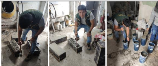
Foto N°33: A continuación, se procedió a llenar los moldes de las vigas y de las probetas cilíndricas previamente limpiadas con un trapo con aceite; Se lleno en tres capas, cada capa se chuzo 25 veces y se dio 12 golpes alrededor por capa, con el martillo de goma.
