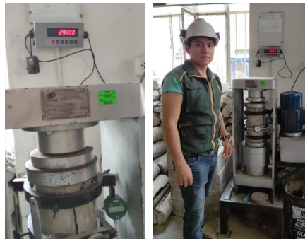
Foto N°43: Roturas de probetas cilíndricas a compresión y módulo de elasticidad a 28 días de curado.
