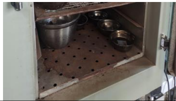
Foto N°10: Muestras puestas al horno 110 \pm 5 °C durante 24h
