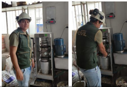
Foto N°46: Roturas de probetas cilíndricas a compresión y módulo de elasticidad a 28 días de curado.
