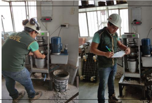
Foto N°48: Roturas de probetas cilíndricas a compresión y módulo de elasticidad a 14 días de curado.
