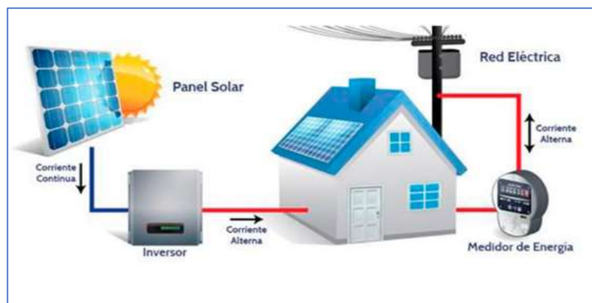
Fig. 8. Esquema de la generación distribuida doméstica con inyección a la red [28].
