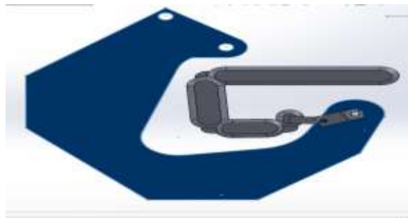
Figura 29 Dimensionamiento de un componente para el movimiento de flexión en los dedos. (Prueba 1).
