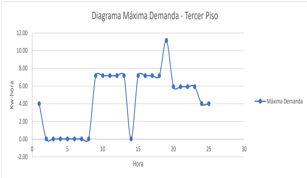
Figura. 17. Diagrama de carga diaria tercer piso – edificio de ingeniería.
