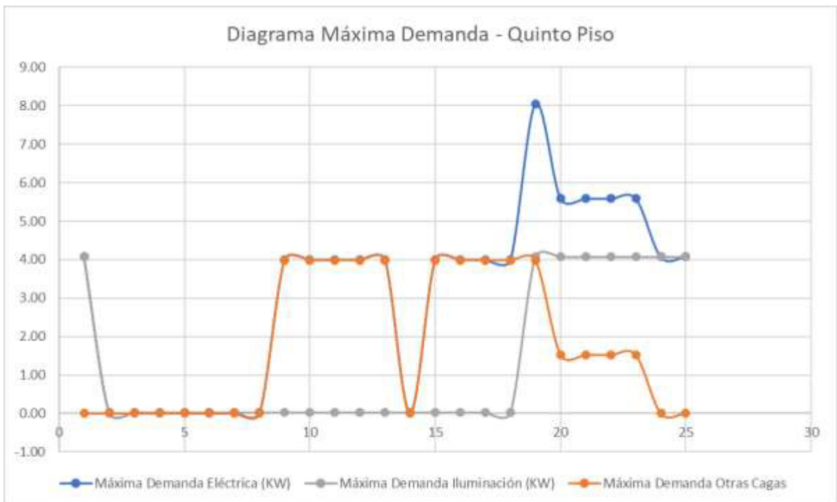
Figura. 20. Diagrama de carga diaria Iluminación, Otras Cargas quinto piso – edificio de ingeniería.
