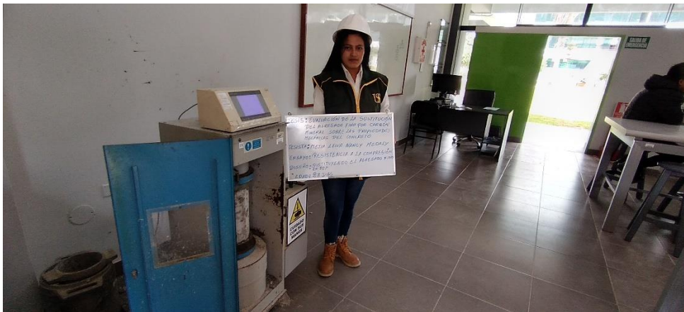
Fotografía 08: Ensayo de resistencia a la compresión del concreto
