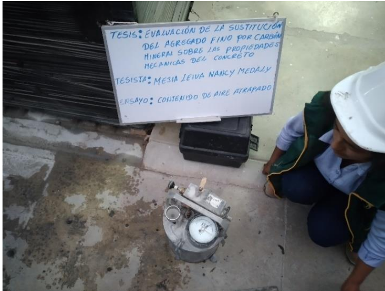
Fotografía 05 contenido de aire en el concreto en estado fresco
