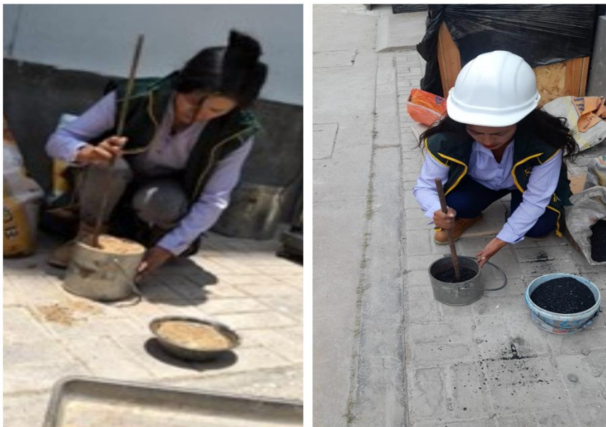
Fotografía 02: Ensayo de Peso unitario seco compactado del agregado fino y el carbón mineral antracita.
