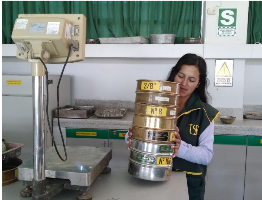
Fotografía 01: Proceso de tamizado de los materiales según las normas ASTM.
