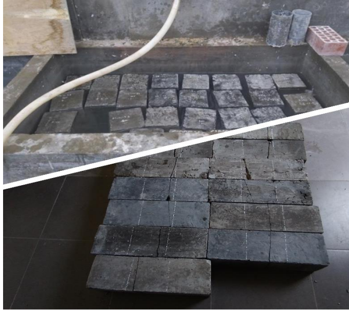
Fotografía 07: Son muestras prismáticas, en la primera imagen es proceso de curación en edades de 7, 14, 28 días, en la segunda imagen se muestra que se realizó el ensayo de flexión.
