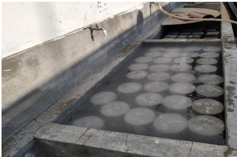
Fotografía 06 Muestras cilíndricas Se curaron las muestras en las edades de 7, 14 y 28 días
