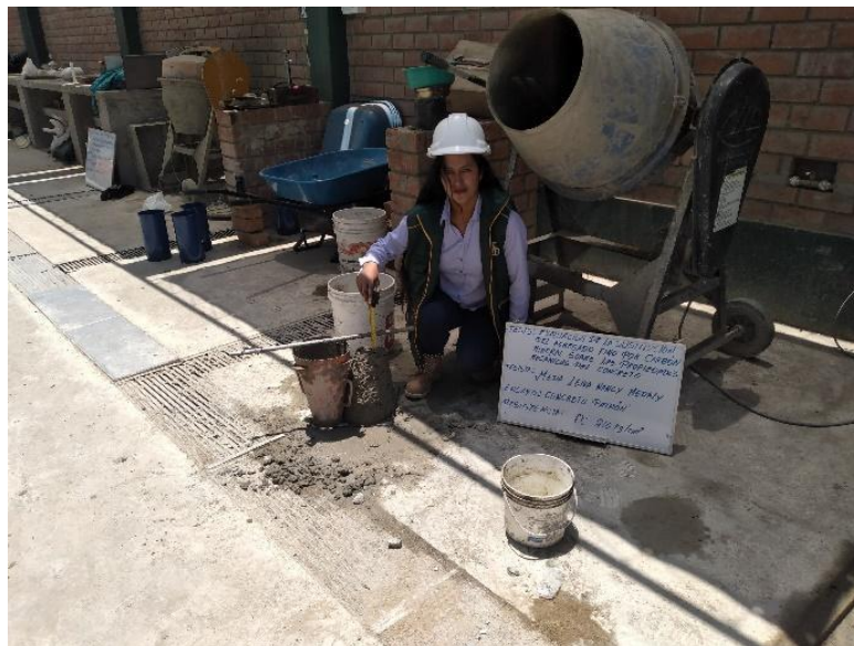
Fotografía 04: Realizando el ensayo del Slump para determinar el asentamiento de la muestra.
