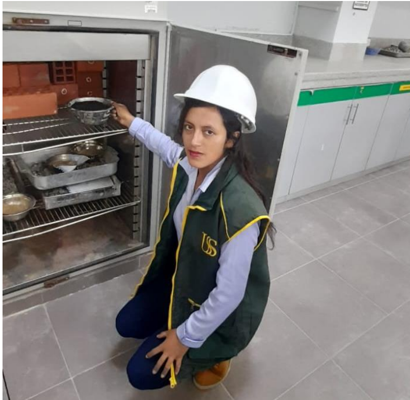
Fotografía 03: La muestra del carbón mineral antracita es colocada al horno para calcular su humedad
