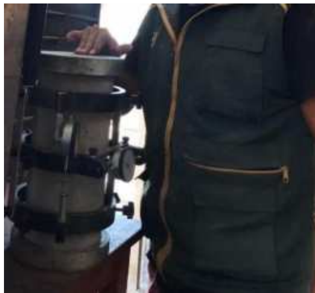
Fig. 21. Módulo de elasticidad en los especímenes de concreto.
