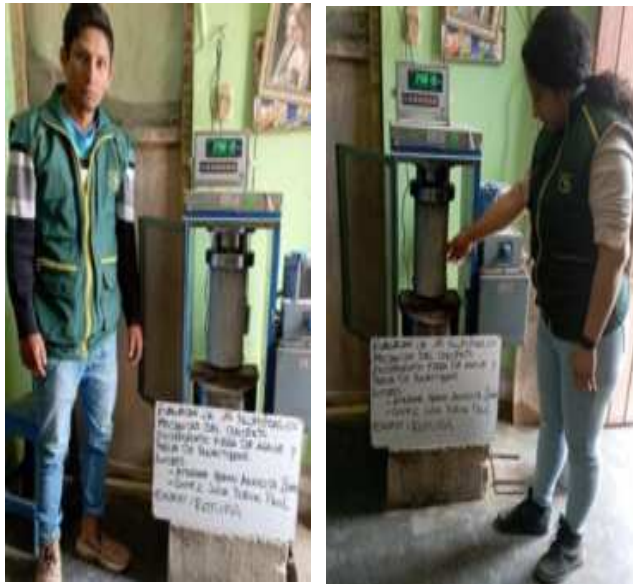
Fig. 18. Estudio del concreto sobre la compresión de las muestras.
