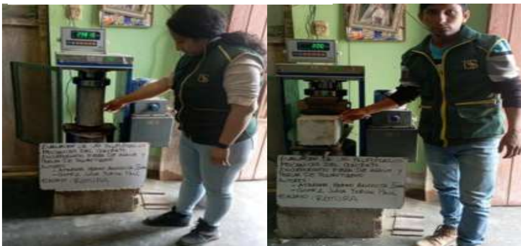
Fig. 54. Especímenes de concreto para ensayos a compresión axial y resistencia a flexión
