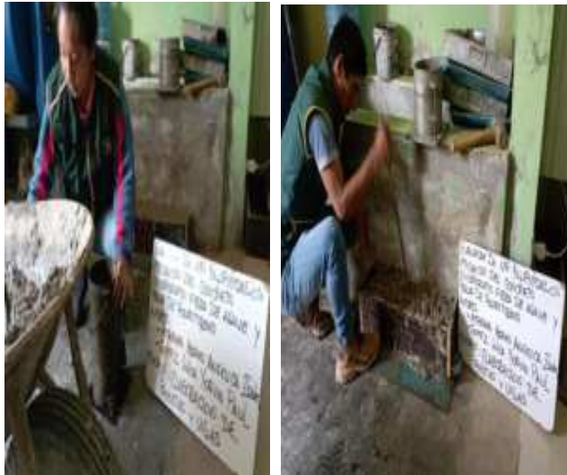
Fig. 16. Elaboración de probetas cilíndricas y rectangulares.
