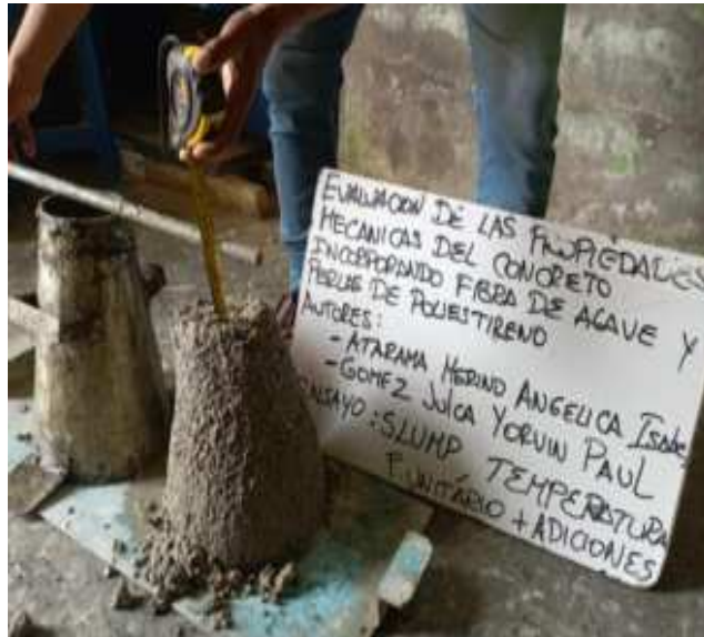
Fig. 13. El asentamiento del concreto patrón incorporado, fibras de agave y perlas de poliestireno será medido.
