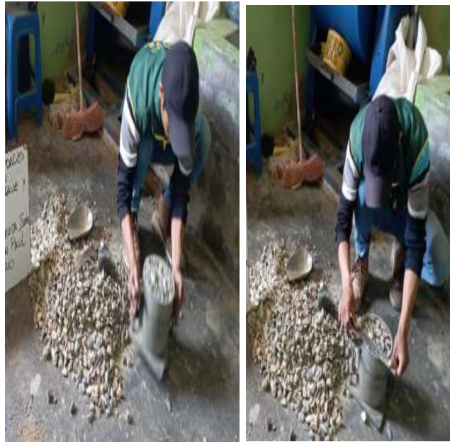
Fig. 9. Ensayo del peso unitario compactado AG.
