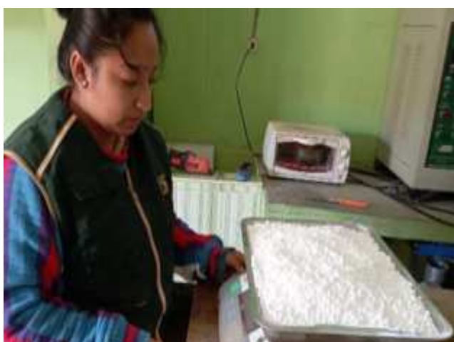
Fig. 41. Pesaje de las perlas de poliestireno.
