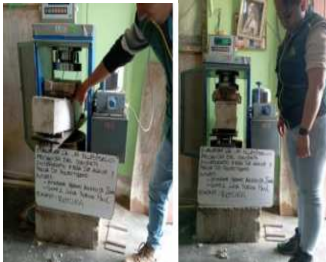
Fig. 19. La resistencia a la flexión de las vigas de concreto rectangular.
