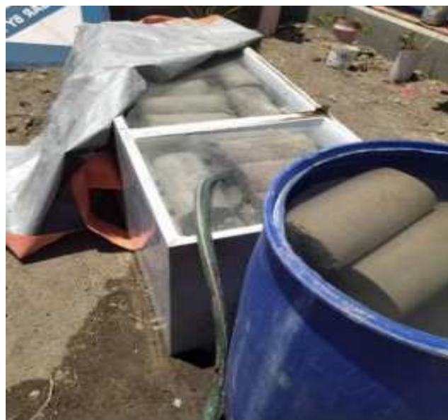
Fig. 17. Curado de Probetas cilíndricas y vigas rectangulares.
