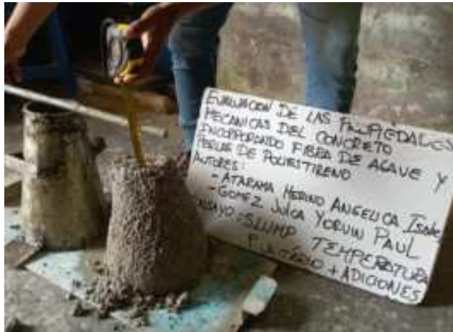
Fig. 52. Medición del asentamiento del concreto.
