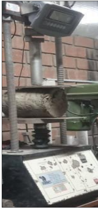
Fig. 33. Ensayo brasileño de tracción con cilindros de 6" x 12" (diámetro y altura).
