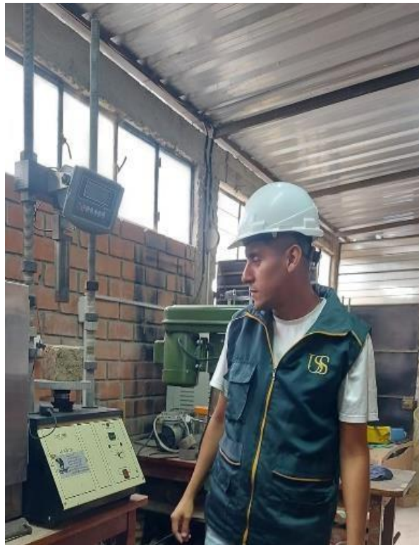
Imagen 20. Prueba de resistencia a la compresión en cubos.
