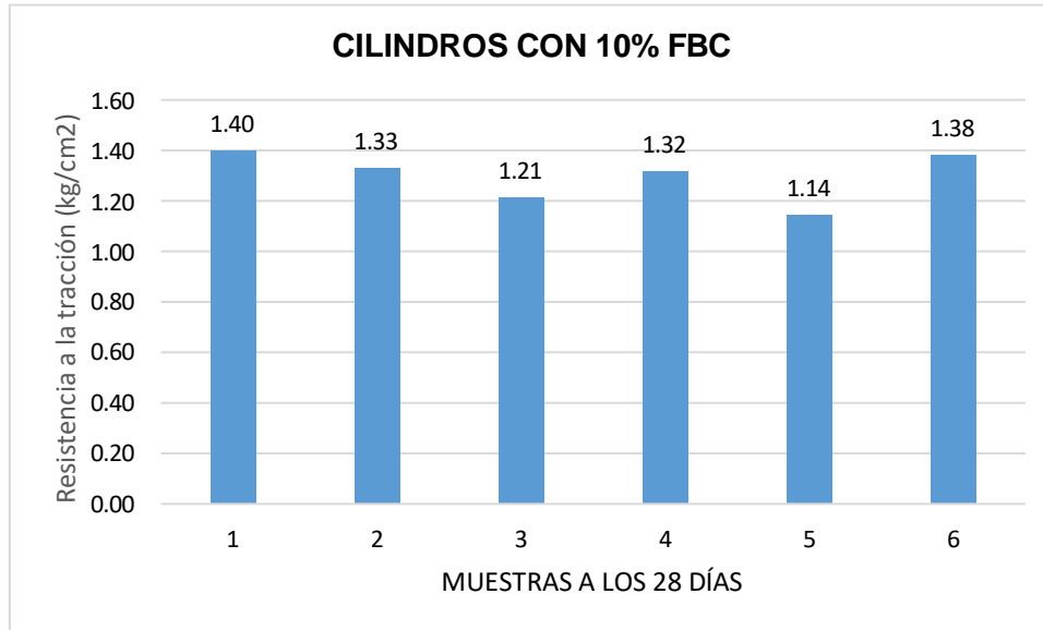
Fig. 109. Adobe en forma de cilindro más fibra del bagazo de caña de azúcar al 10% a los 28 días.
