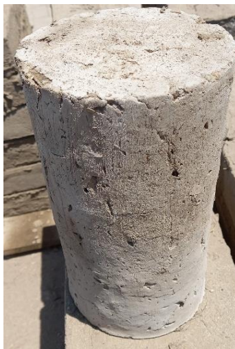
Imagen 17. Cilindro de adobe de 6"x12" para ensayo brasileño.
