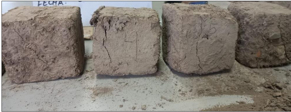
Fig. 17. Resultado de resistencia de las muestras patrones en cubos
