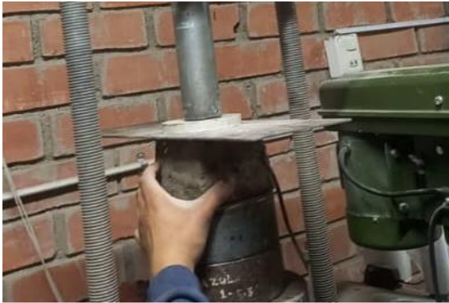
Imagen 22. Prueba de compresión en cubos con 2% de FBC.
