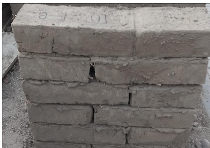
Fig. 66. Ensayo de compresión diagonal para muretes con 2% de FBC a los 7 días.
