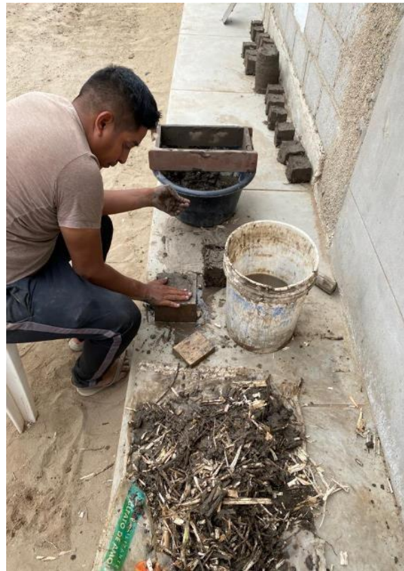
Imagen 5. Mezcla del bagazo con la tierra.
