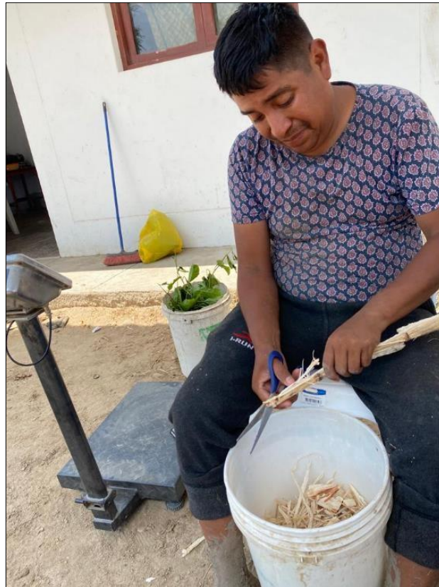
Fig. 41. Fibra del bagazo de caña azúcar secado en el sol y después cortarla por pedazos y pesarlo.
