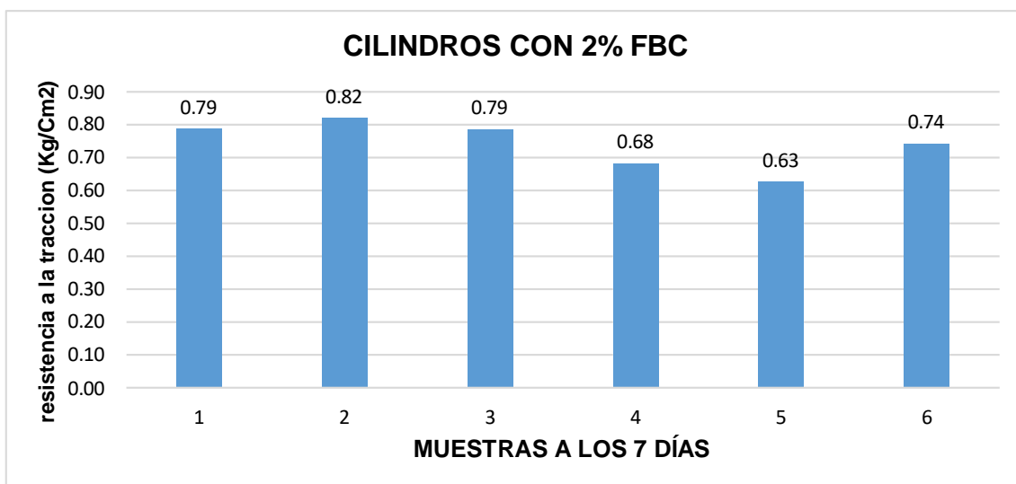
Fig. 99. Adobe prismas más fibra del bagazo de caña de azúcar al 2% a los 7 días
