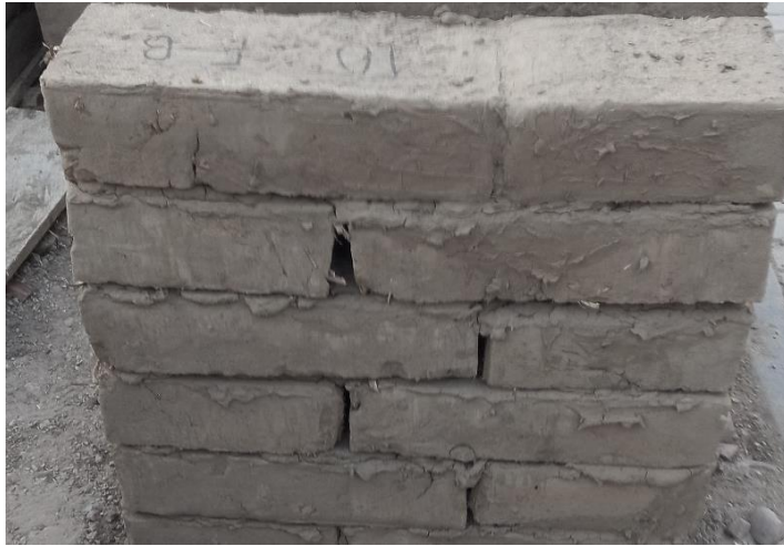
Imagen 15. Muretes de adobe para prueba de compresión diagonal.
