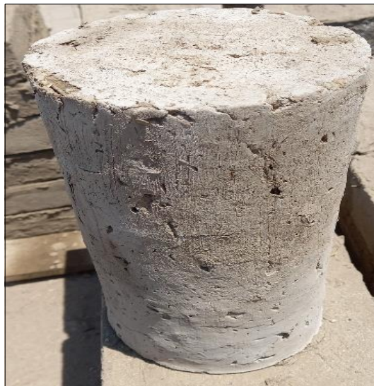
Fig. 32. Adobe cilindros de 6" x 12" a los 7 días.
