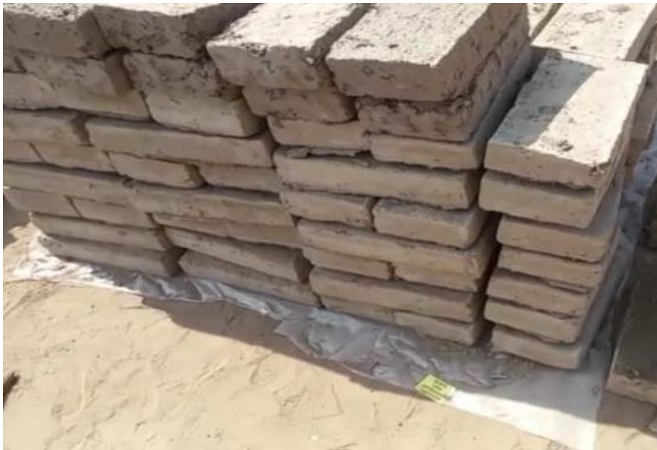
Imagen 11. Apilamiento de adobes.
