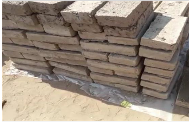
Fig 15. adobes patrones para los ensayos de 7,14 y 28 días.
