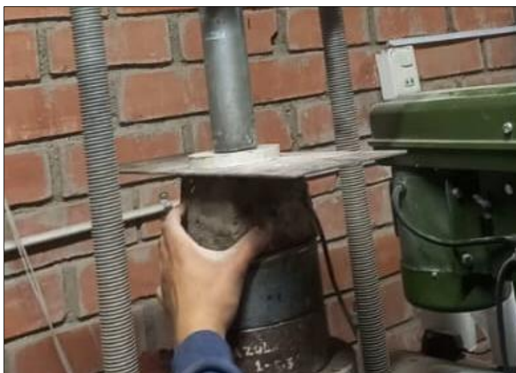
Fig. 54. Realización del ensayo de compresión de cubos con FBC al 5% a los 14 días.
