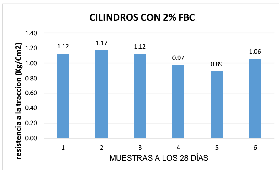
Fig. 101. Adobe en forma de cilindro más fibra del bagazo de caña de azúcar al 2% a los 28 días
