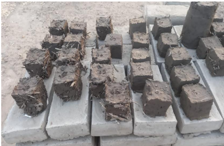
Imagen 14. Cubos de adobe con la fibra del bagazo de caña.
