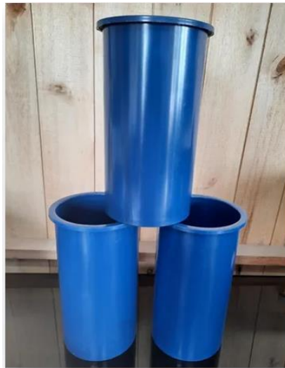
Imagen 16. Moldes para probetas cilíndricas.
