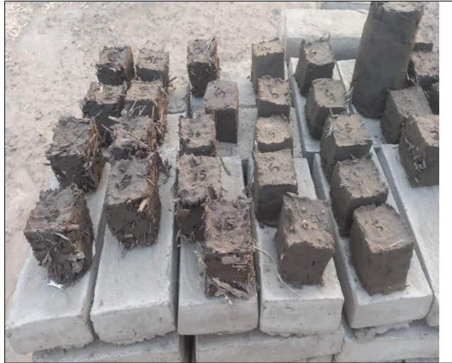
Fig. 45. Muestras de mis adobes en cubos al 2%,5%,10%,15%
