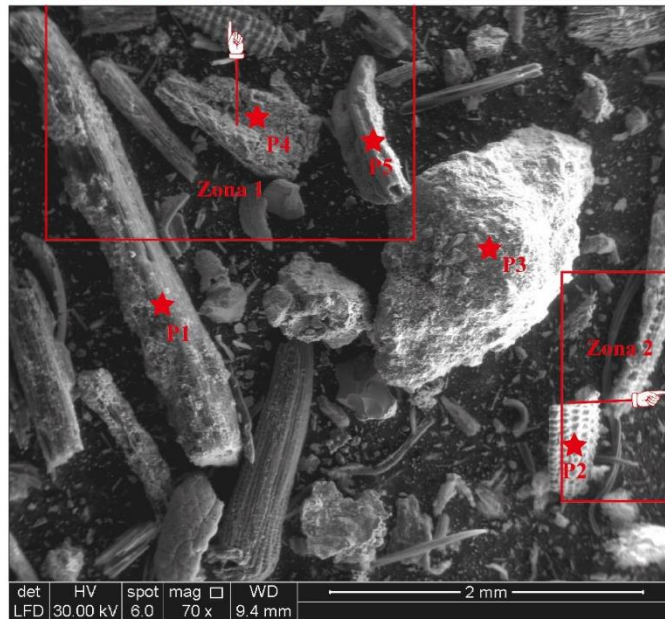
Figura 1. Micrografía de la muestra a una magnificación de 70x con regiones de interés señaladas, señal de electrones secundarios.
