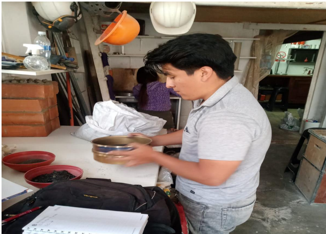
Imagen 4: Tamizado de Ceniza de Bagazo por el tamiz N°200.
