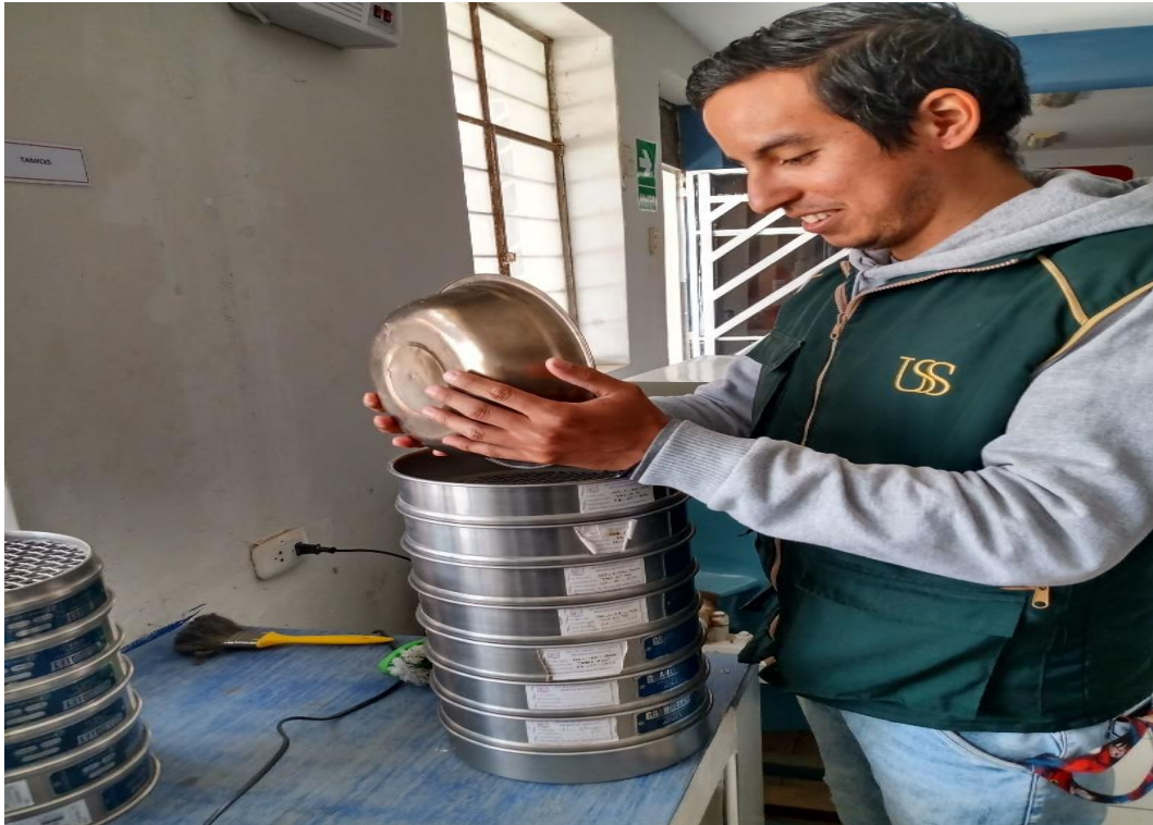
Imagen 7: Se realiza el ensayo de granulometría.
