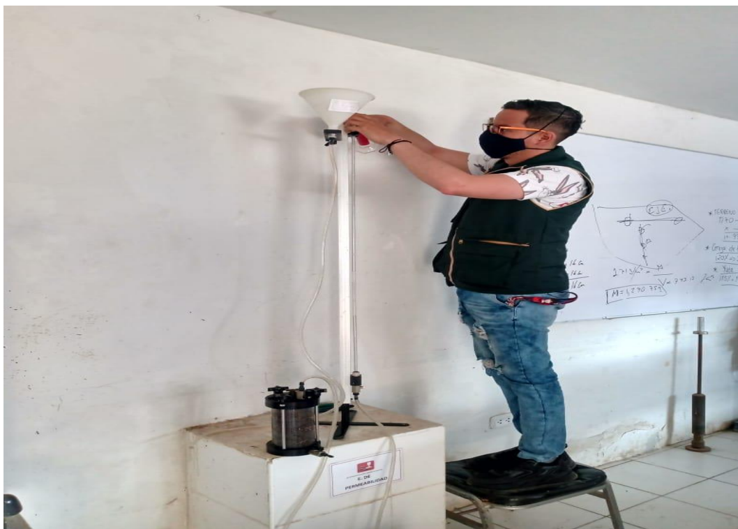
Imagen 14: Incorporación de agua en material ensayado.
