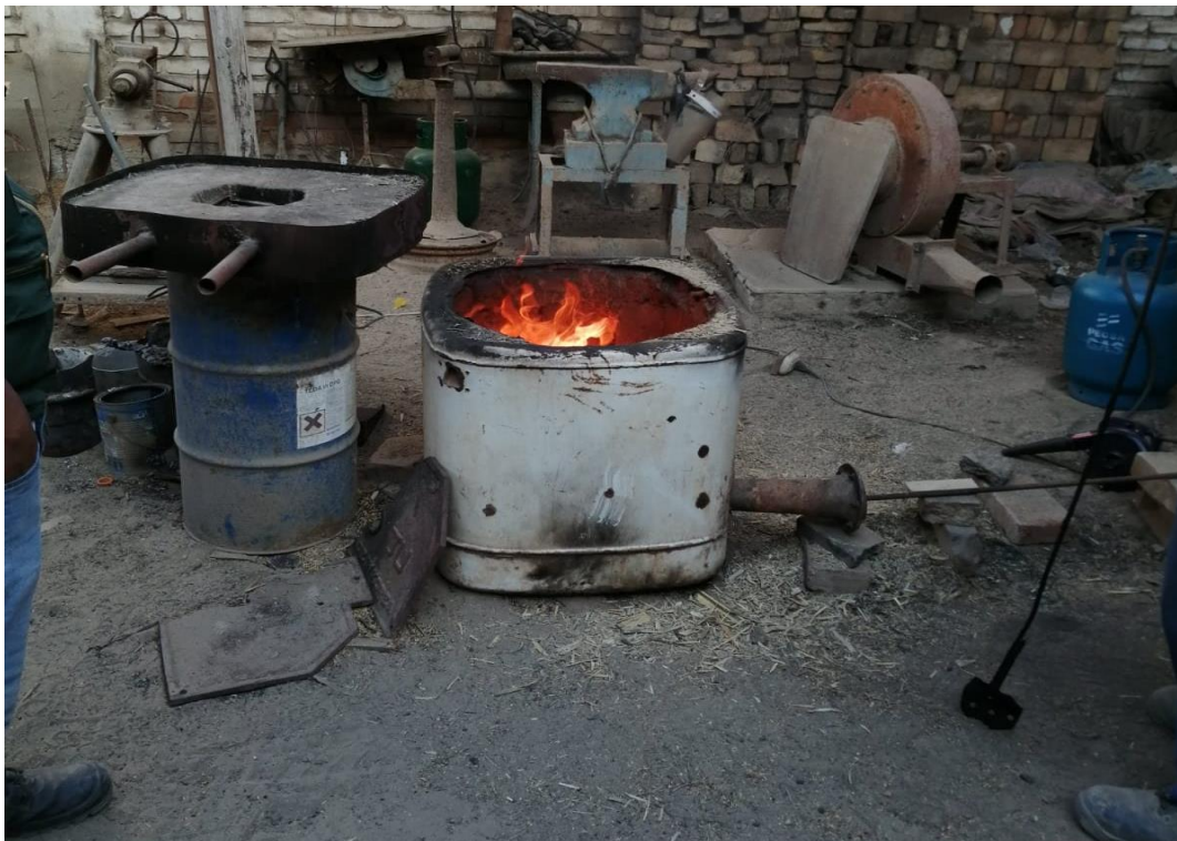
Imagen 2: Quemado de Bagazo de Caña
