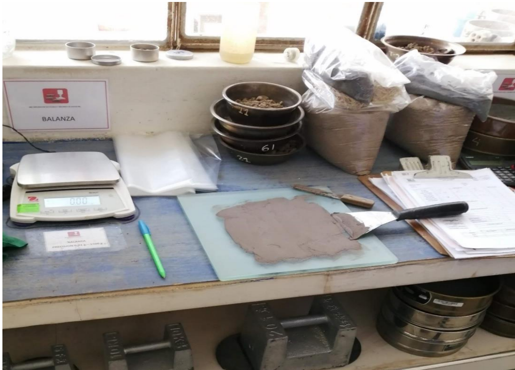
Imagen 9: Ensayo para determinar Limite Plástico
