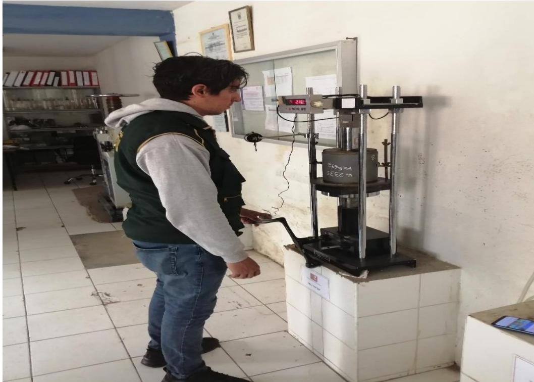
Imagen 13: Se realiza el ensayo de penetración mediante la preñse CBR y se toma lectura de los resultados.
