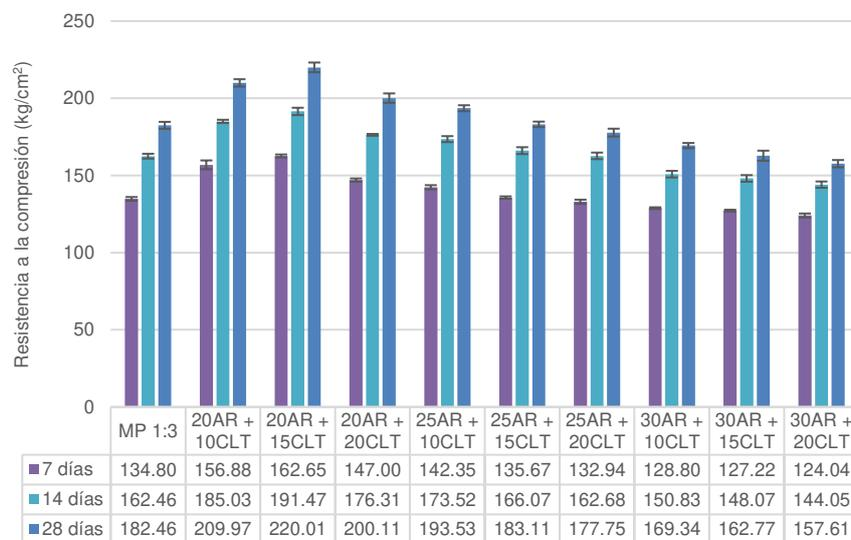
**Fig. 7.** Ensayo de Resistencia a la Compresión - Dosificación 1:3.
