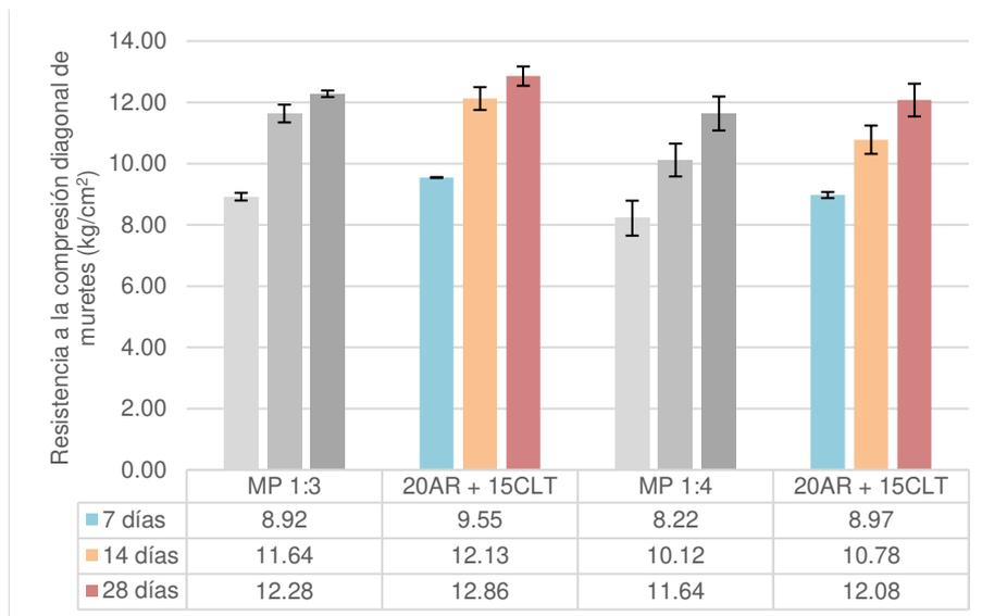
**Fig. 15.** Ensayo de compresión en Murete - Dosificación 1:3 y 1:4.
