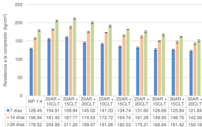
**Fig. 8.** Ensayo de Resistencia a la Compresión - Dosificación 1:4.
