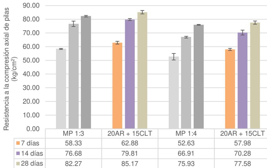
**Fig. 14.** Ensayo de Compresión de pilas - Dosificación 1:3 y 1:4.
