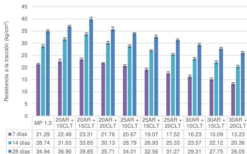
**Fig. 11.** Ensayo de Resistencia a la Tracción - Dosificación 1:3.
