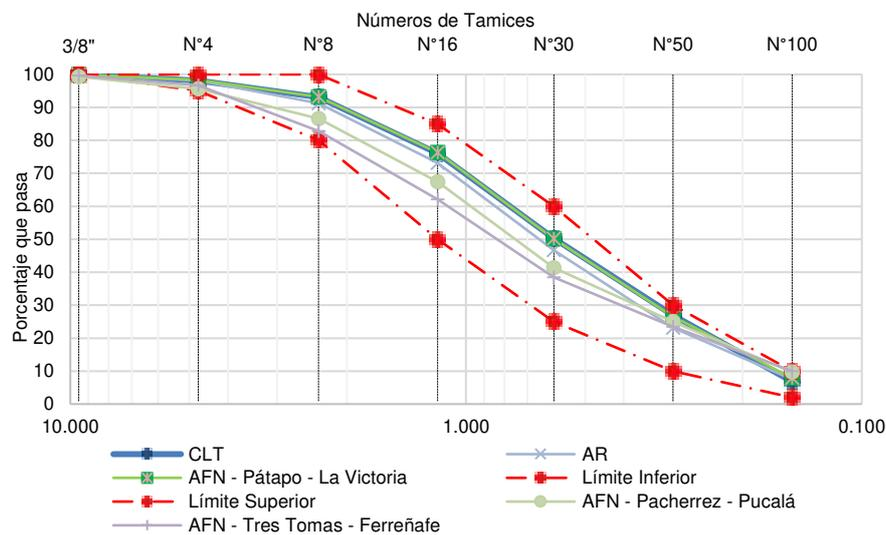
Fig. 3. Distribución granulométrica de AFN, AR y CLT.
