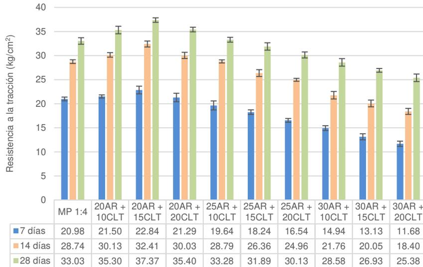
Fig. 12. Ensayo de Resistencia a la Tracción - Dosificación 1:4.
