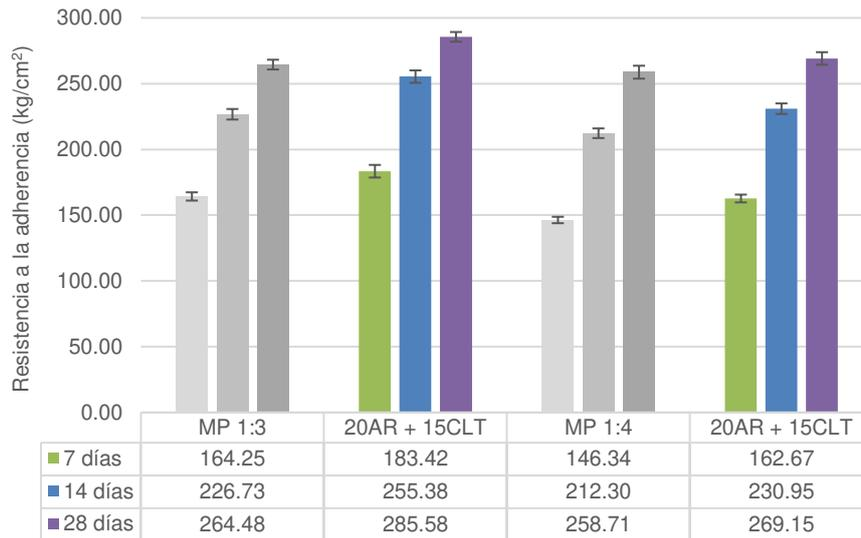
**Fig. 13.** Ensayo de Adherencia - Dosificación 1:3 y 1:4.
