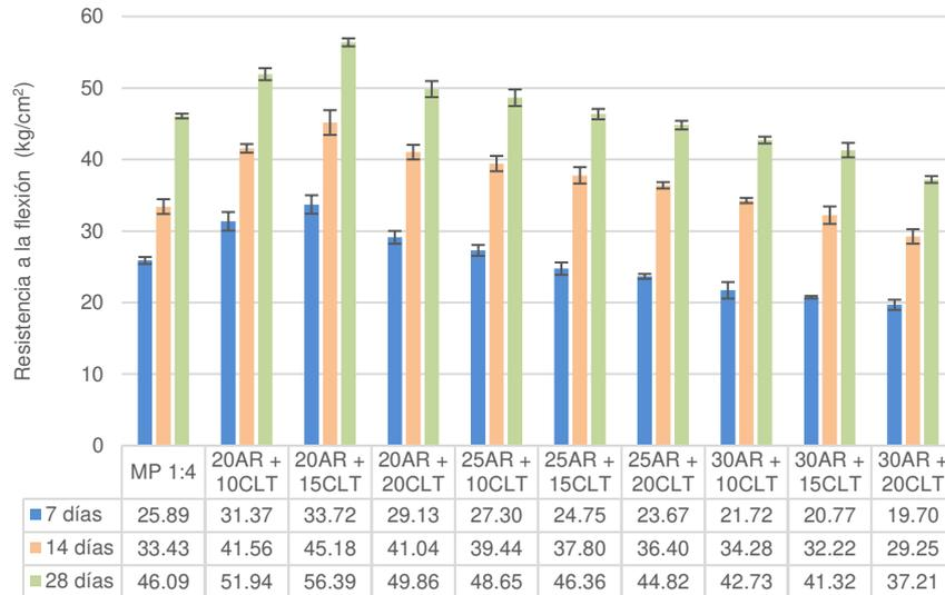
**Fig. 10.** Ensayo de Resistencia a la Flexión - Dosificación 1:4.
