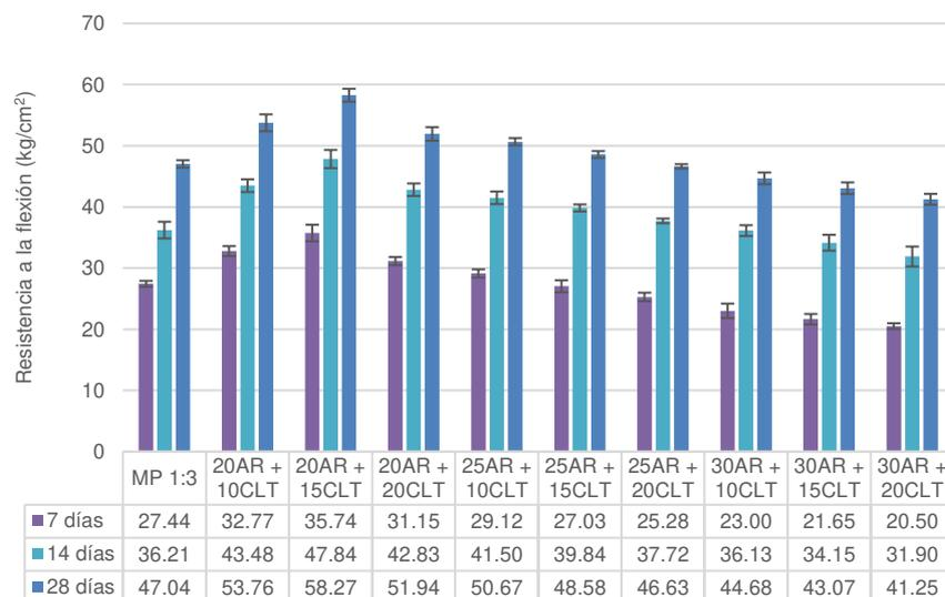
Fig. 9. Ensayo de Resistencia a la Flexión - Dosificación 1:3.
