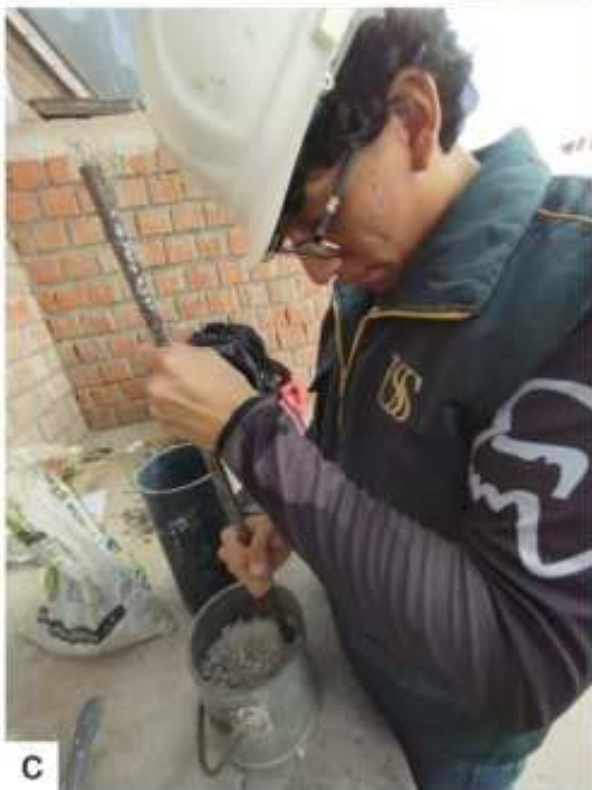
a) Peso unitario compactado de la arena gruesa. b) Peso Unitario Suelto de la arena gruesa. c) Peso unitario compactado del AR. d) Peso unitario suelto del CLT.
