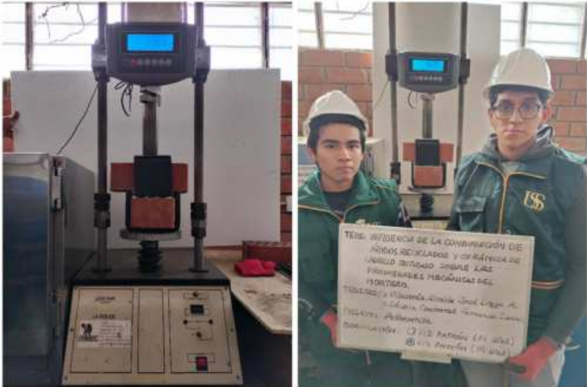
Ensayo de adherencia.
