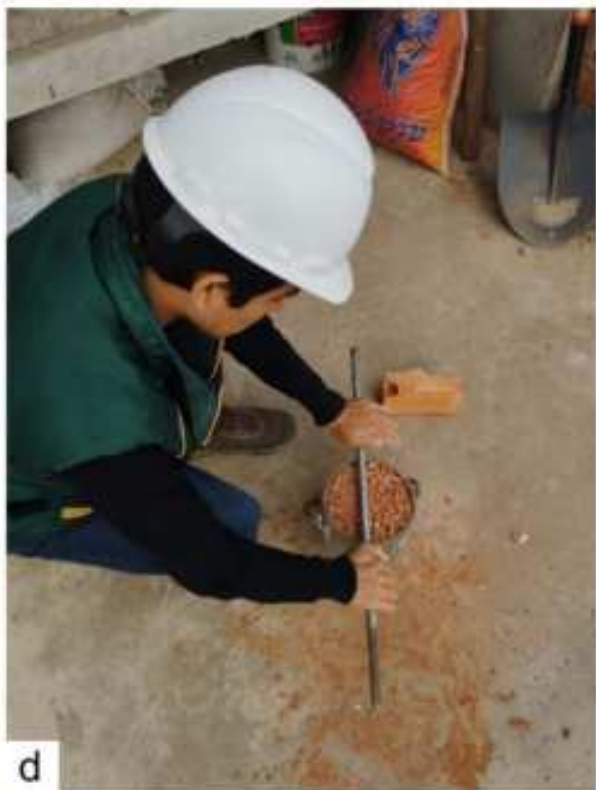
a) Peso unitario compactado de la arena gruesa. b) Peso Unitario Suelto de la arena gruesa. c) Peso unitario compactado del AR. d) Peso unitario suelto del CLT.
