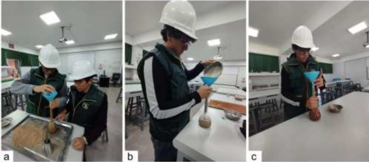
a) Peso específico y absorción de arena gruesa. b) Peso específico y absorción del AR. c) Peso específico y absorción del CLT.
