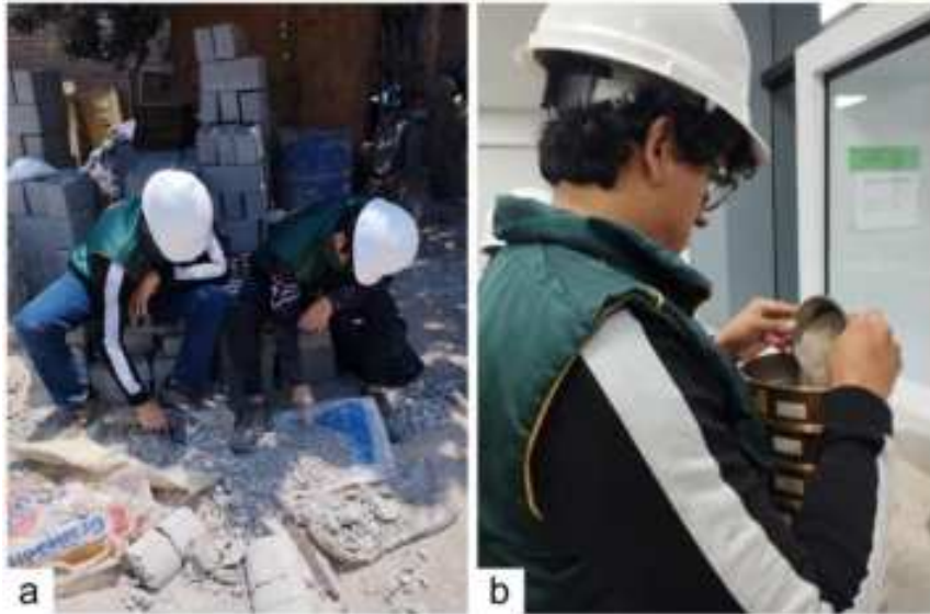
Fig. 1. a) Triturado para la obtención de AR. b) Tamizado de AR.
