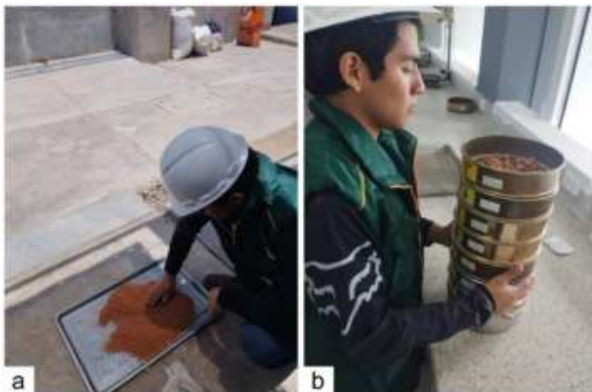
Fig. 2 a) Triturado para la obtención de CLT. b) Tamizado de CLT.
