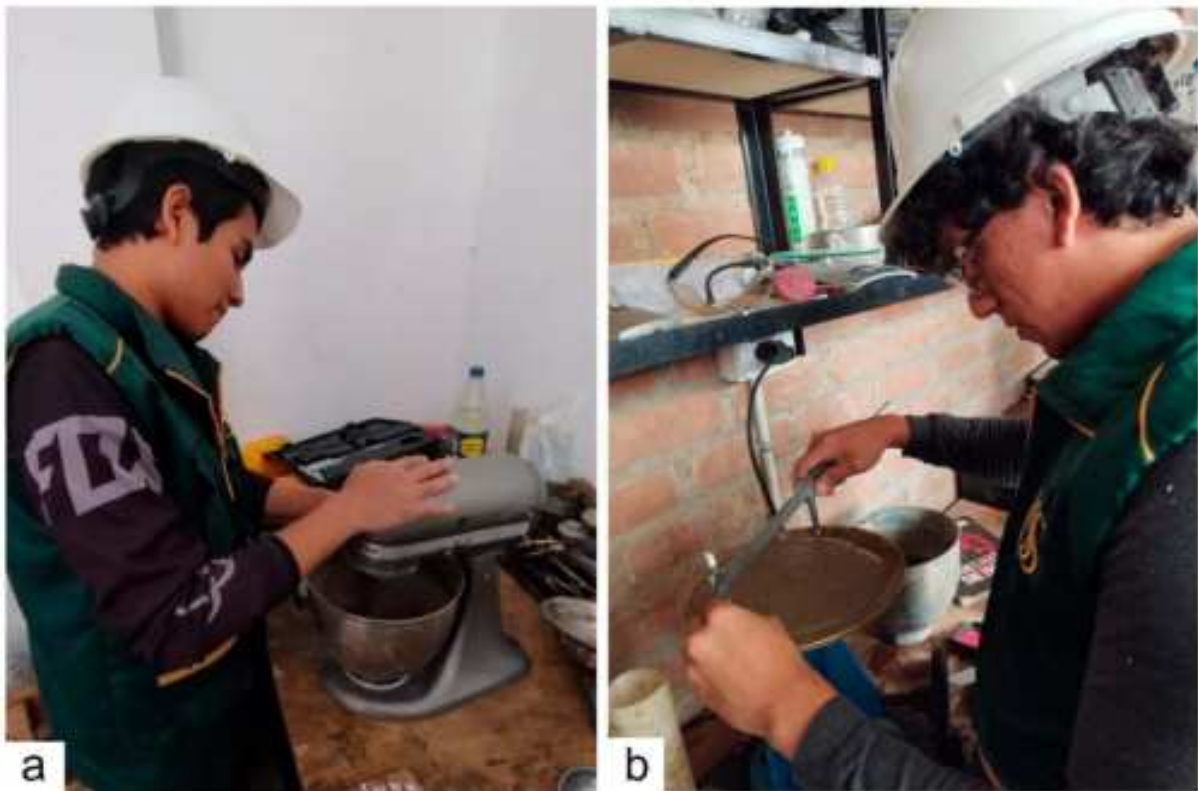
a) Batidora para la mezcla de mortero. b) Diámetro para hallar la fluidez del mortero.
