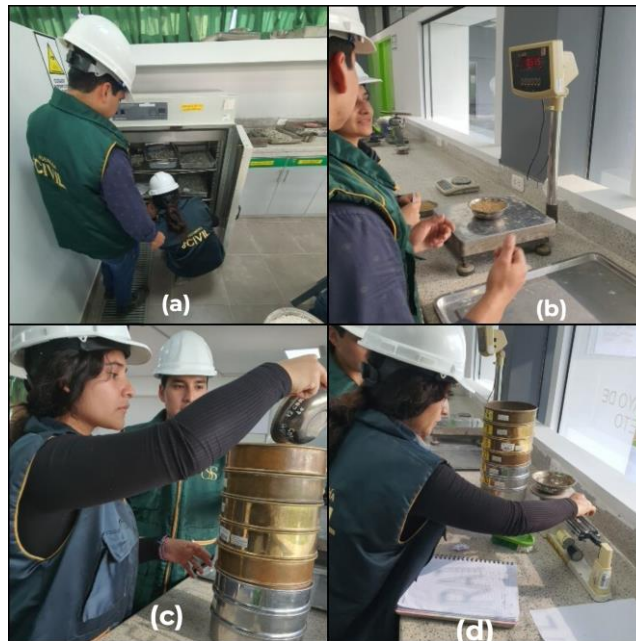
(a) Sacado de muestra de agregado fino del horno, (b) Pesado de la muestra luego de haberla sacado del horno, (c) Análisis granulométrico de agregado fino, (d) Cuantificación de material retenido por cada malla.
