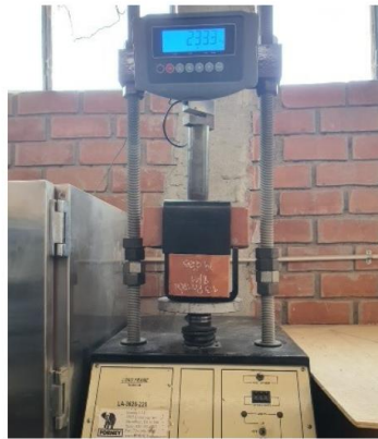
Ensayo de resistencia a la flexión por adherencia.
