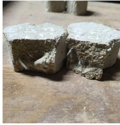
Ensayo de resistencia a la tracción.
