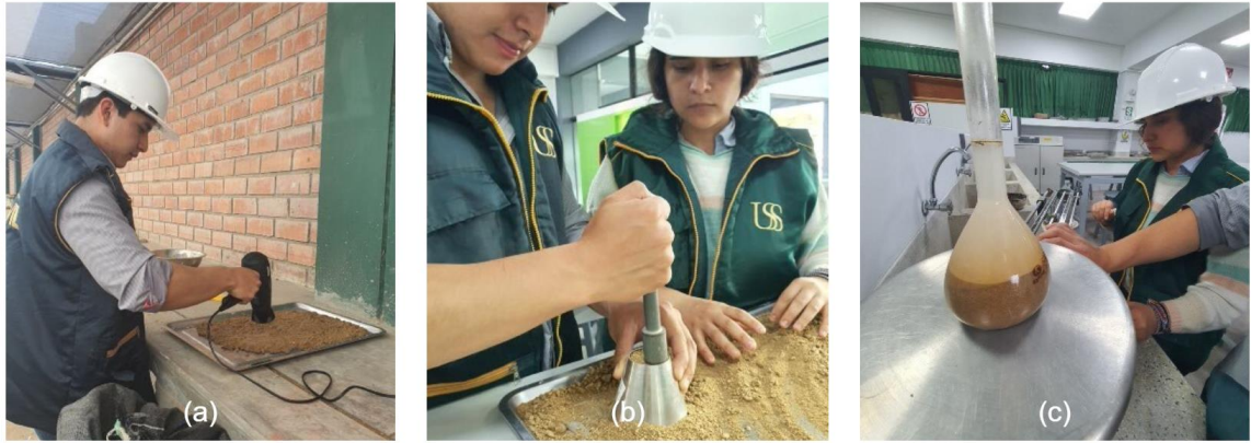
(a) Secado de muestra de agregado fino, (b) Procedimiento de ensayo de % de vacíos del agregado fino, (c) Peso de muestra de agregado fino en fiola.
