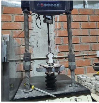
Ensayo de resistencia a la tracción.
