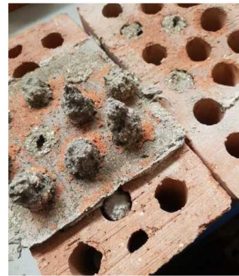
Ensayo de resistencia a la flexión por adherencia.
