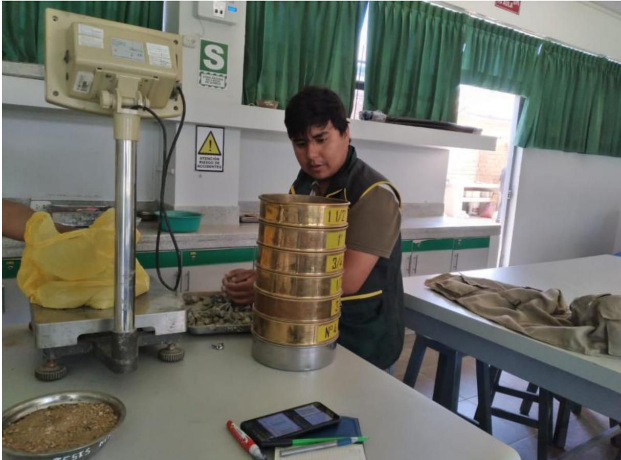
**Fotografía 03:** Se hizo el ensayo granulométrico al agregado grueso.
