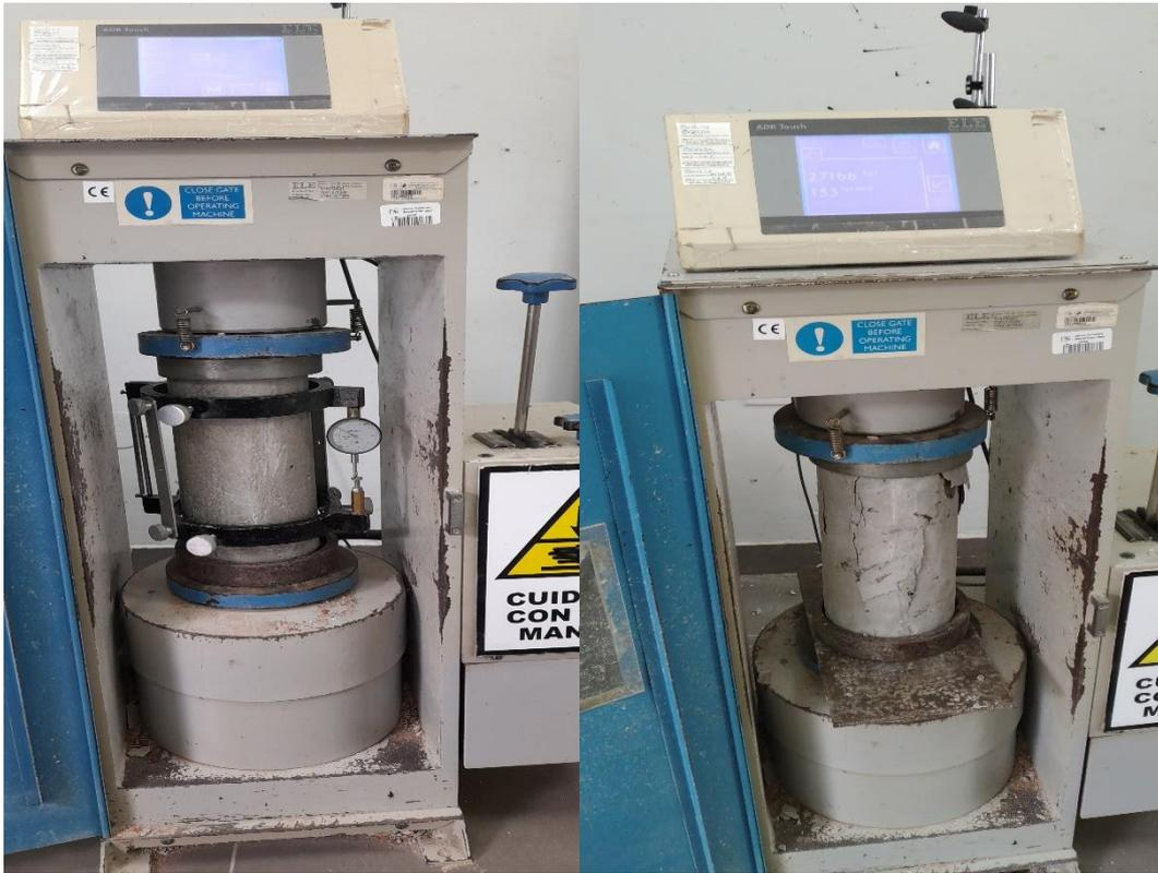
**Fotografía 09:** Ensayo mecánicos del concreto endurecido.
