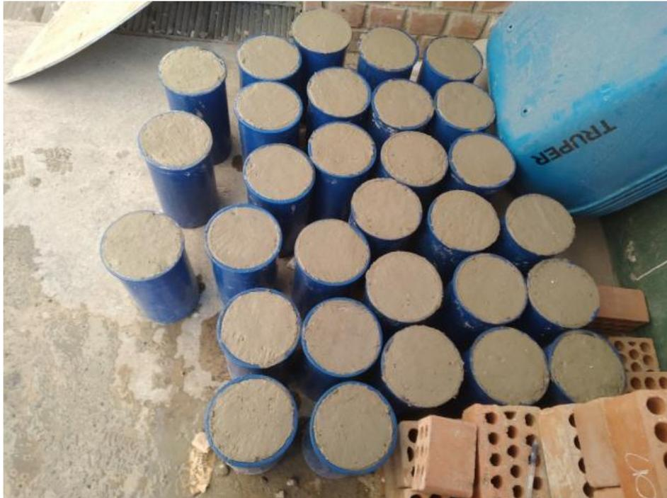
**Fotografía 07:** Se realizó los testigos para ensayo de resistencia a compresión con los diseños de concreto al 0%, 5%,10%, 15% y 20%.
