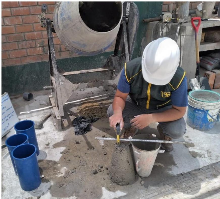
**Fotografía 06:** Se realizó el ensayo de SLUMP del diseño de concreto patrón con un asentamiento de 3" a 4" pulgadas
