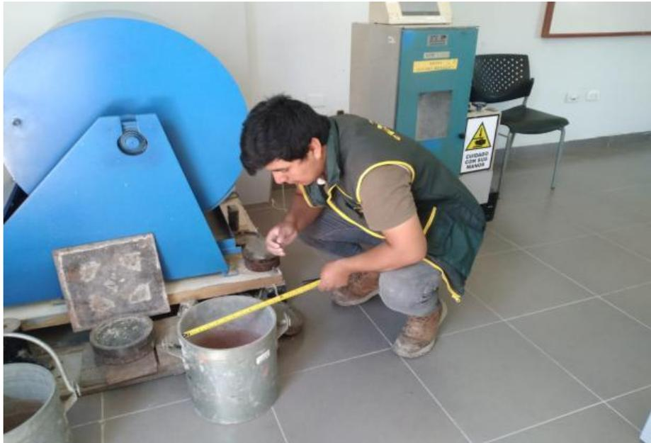
**Fotografía 01:** Sacando las dimensiones del molde para luego calcular PUS y PUC
