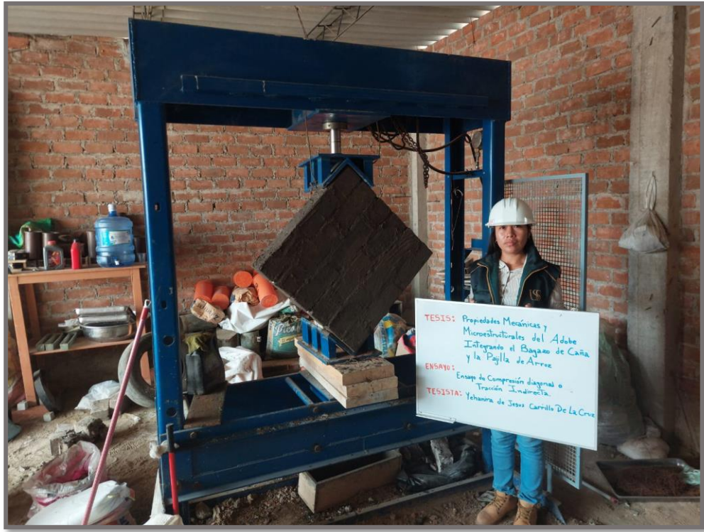
Ensayo: Ensayo de compresión diagonal
