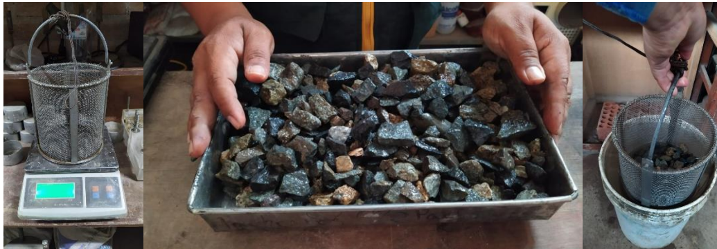
Fig. 22. Grava SSS y colocada sobre una canastilla por el principio de Arquímedes
