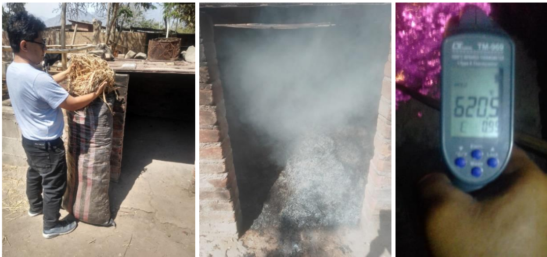
Fig. 4. Quema de Bagazo a las temperaturas de 500°C, 550°C, 600°C y 650°C, control de temperatura y obtención de ceniza
