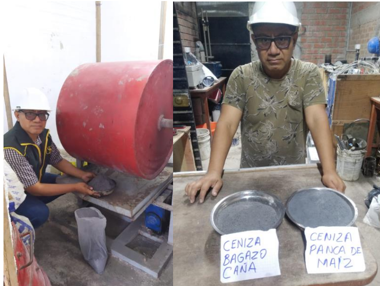
Fig. 9. Resultado del triturado de molienda y tamizado de cenizas por la malla N° 200
