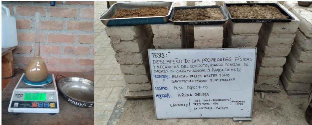
Fig. 21. Arena SSS y colocado en un picnómetro con agua
