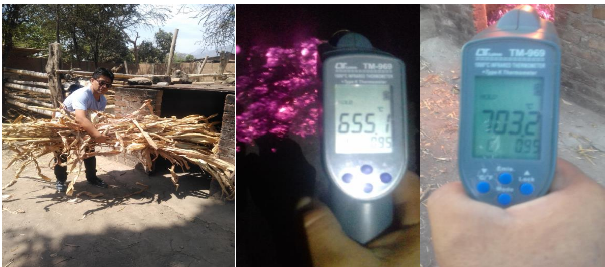
Fig. 5. Quema de Panca de Maíz a las temperaturas de 550°C, 600°C, 650°C y 700°C, control de temperatura y obtención de ceniza
