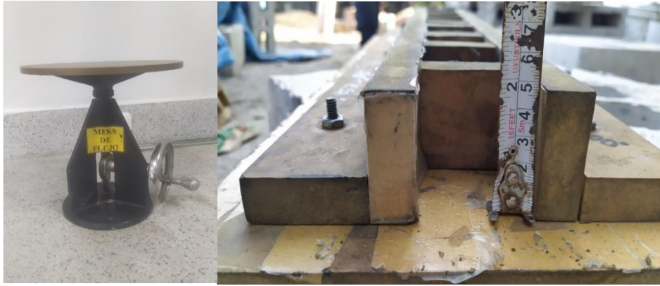
Fig. 6. Mesa de flujo para el ensayo de fluidez del mortero y desencofrado de cubos
