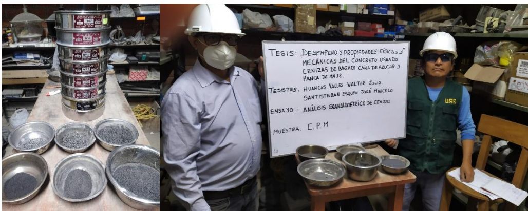
Fig. 18. Ensayo de granulometría para cenizas
