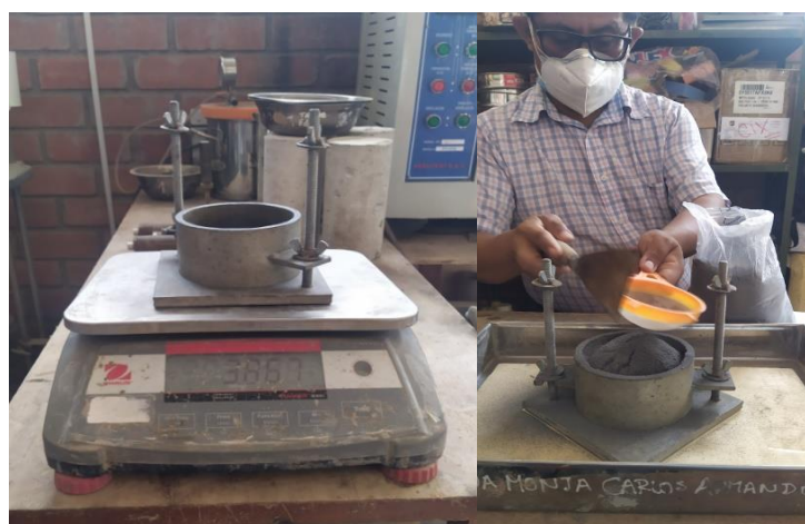
Fig. 10. Peso del molde y colocación de la ceniza
