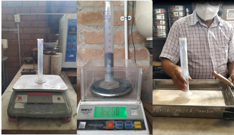
Fig. 13. Procedimiento para la determinación del peso unitario compactado
