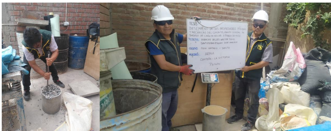
Fig. 20. Ensayo de peso unitario suelto y compactado para los agregados
