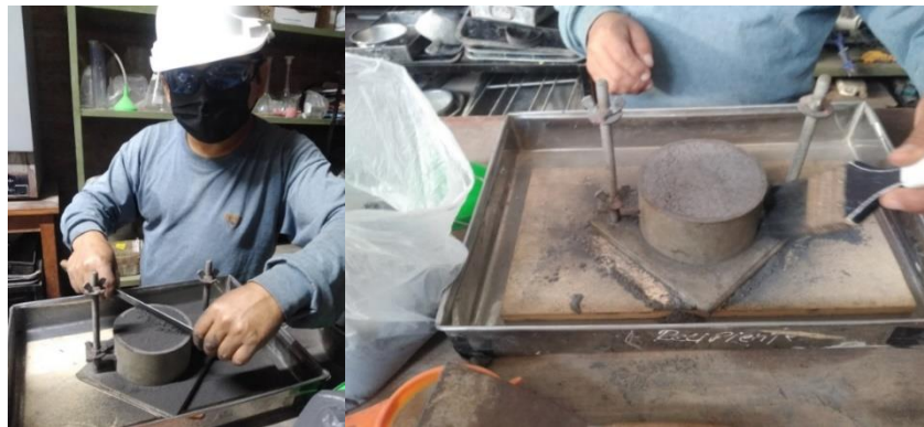
Fig. 11. Enrasado y limpieza del molde
