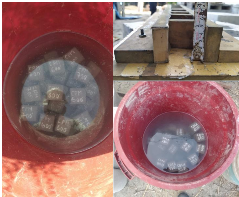
Fig. 17. Moldes para la obtención de cúbicos de 5cm de mezcla de mortero
