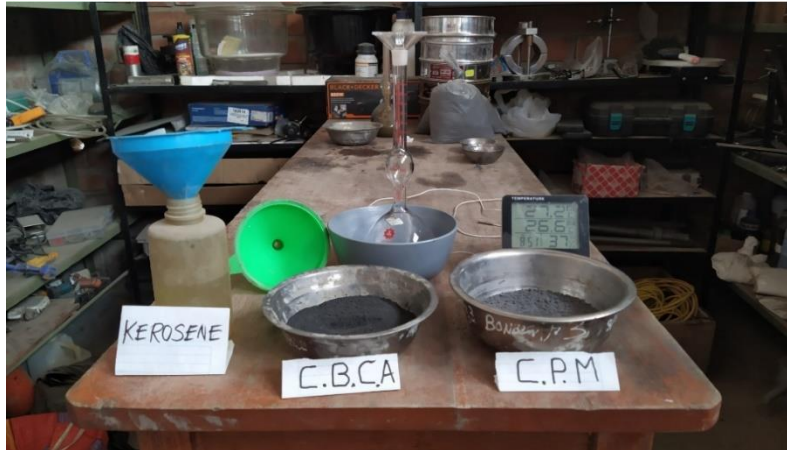
Fig. 14. Materiales usados para el ensayo de densidad de cenizas
