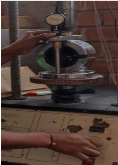
Fig 3. Medida del Flujo Marshall en las briquetas
