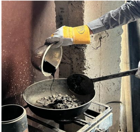
Fig 1. Vertimiento de asfalto en la mezcla
