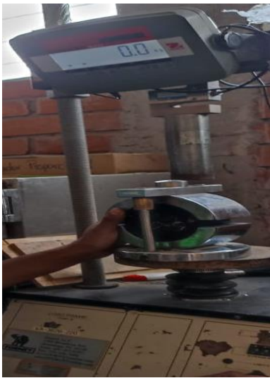
Fig 2. Medida de la Estabilidad Marshall en las briquetas
