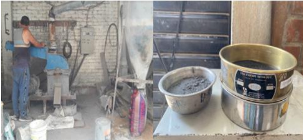
Fig. 6. Proceso de molido para facilitación de tamizaje.
