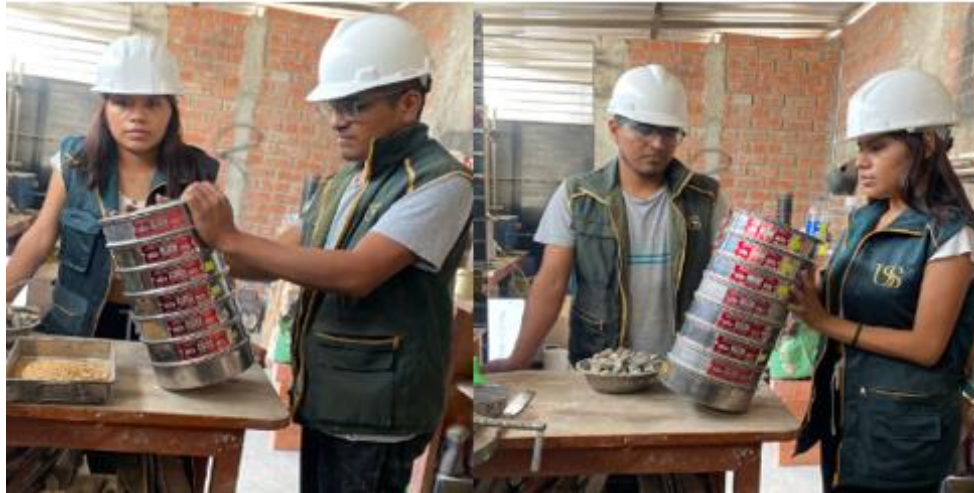
Fig. 14. Ensayo granulométrico por tamizaje para los agregados.
