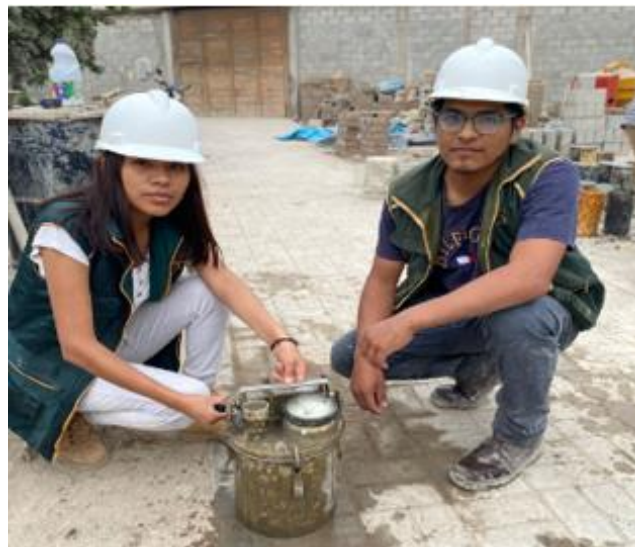
Fig. 25. Ensayo de contenido de aire.
