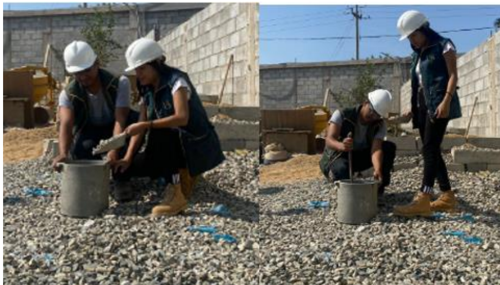
Fig. 13. P.u. suelto y compactado del agregado grueso.
