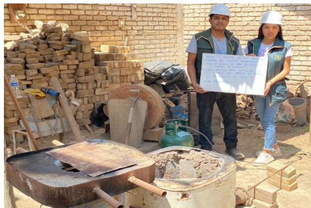
Fig. 5. Obtención de CBA mediante quemado en horno artesanal.
