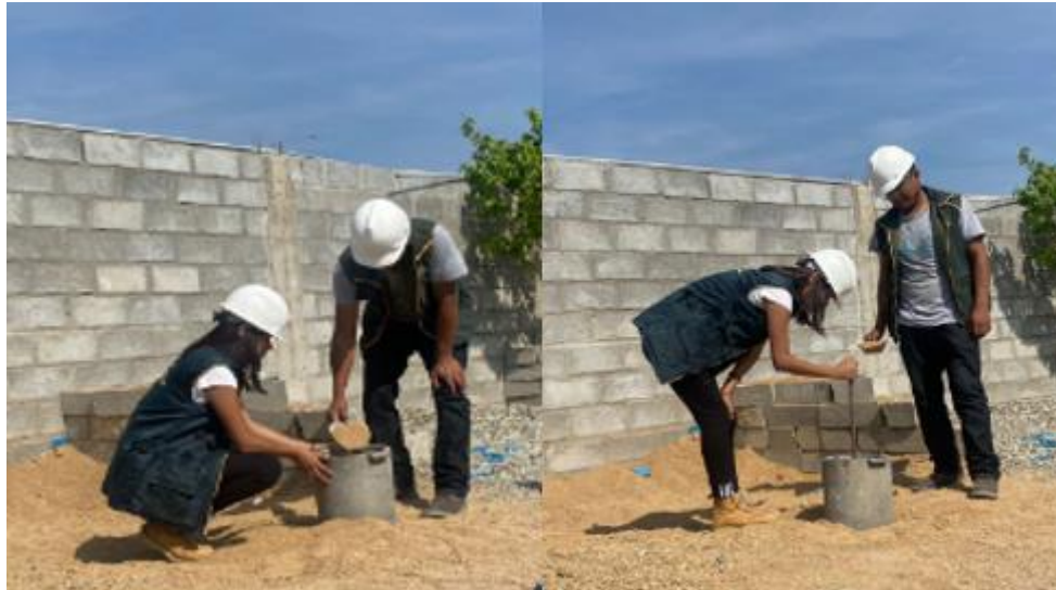
Fig. 12. P.u. suelto y compactado del agregado fino.
