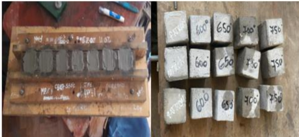
Fig. 7. Cubos de concreto con CBA en distintas temperaturas.
